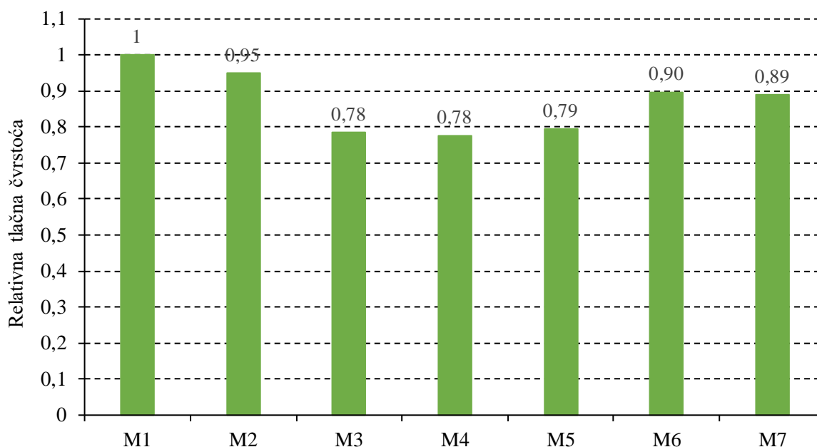
Slika 6.17: Relativne tlačne čvrstoće cementnih mortova s pepelom ljuske sjemenki suncokreta
