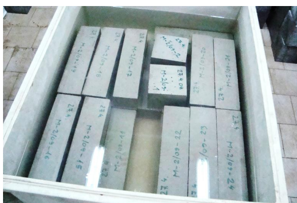
Slika 6.18: Njega uzoraka betona pod vodom
