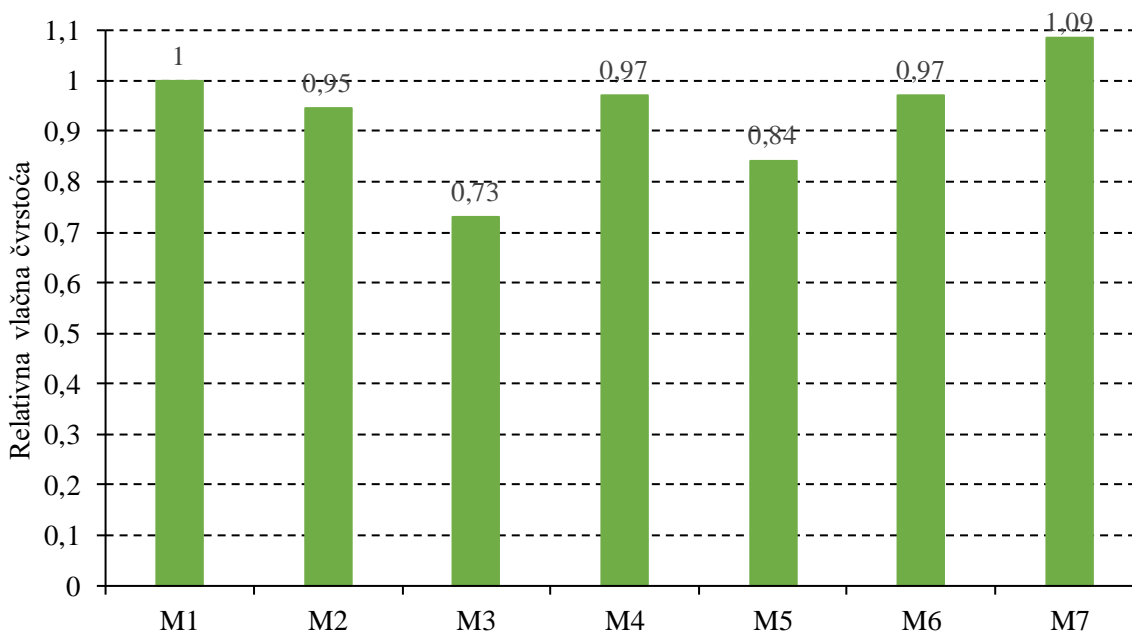
Slika 6.16: Relativne vlačne čvrstoće savijanjem cementnih mortova s pepelom ljuske sjemenki suncokreta
