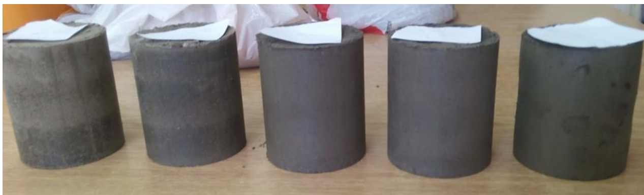
Slika 6.26: Uzorci vapnom/pepelom biomase stabiliziranoga tla pri različitim vlažnostima
