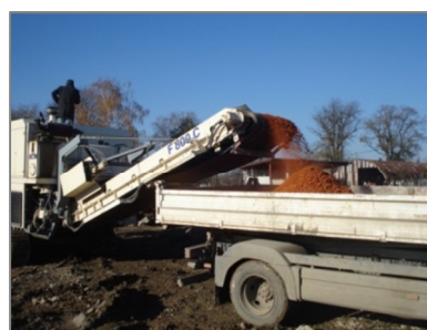
Slika 5. 2: Pokretna drobilica za crijep
