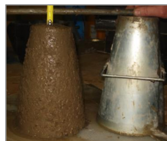
Slika 5. 11: Konzistencija slijeganjem MM-B10
