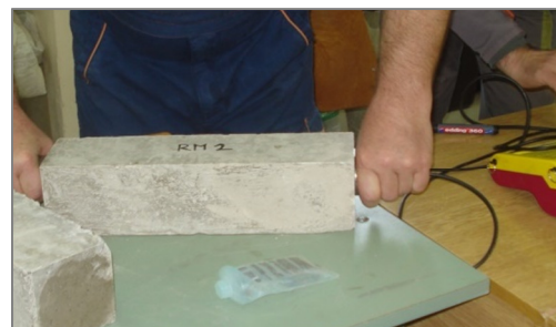
Slika 5. 16: Ispitivanje brzine prolaza ultrazvuka
