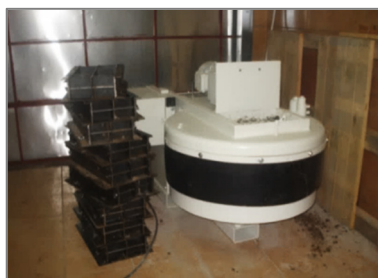
Slika 5. 6: Mješalica za izradu betonskih mješavina
