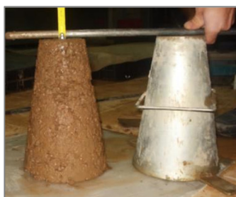
Slika 5. 10: Konzistencija slijeganjem EM-B42
