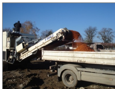
Slika 5. 2: Pokretna drobilica za crijep
