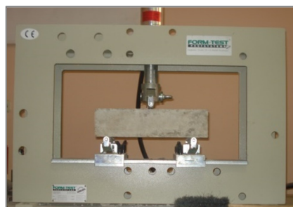
Slika 5. 18: Ispitivanje vlačne čvrstoće savijanjem
