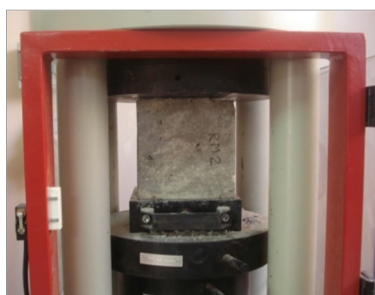
Slika 5. 17: Tlačna čvrstoća na kocki brida 10 cm
