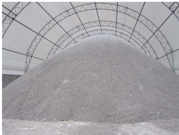
Slika 15. Natkrivena deponija mineralne mješavine [118]
