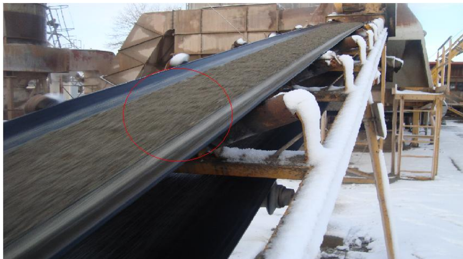
Slika 185. Uzorkovanje mineralne mješavine
