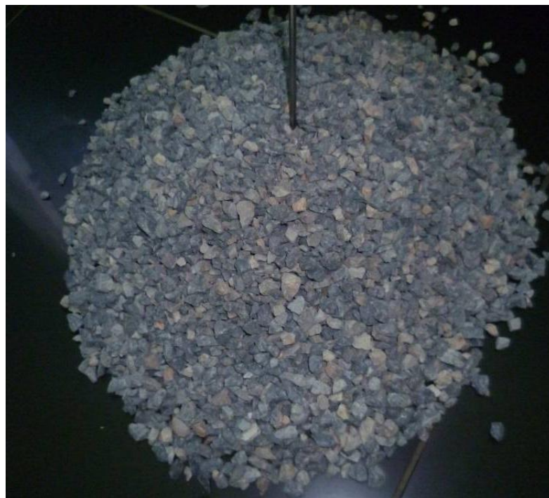
Slika 210. Ispitani uzorak kamene frakcije granulacije 4/8 mm
