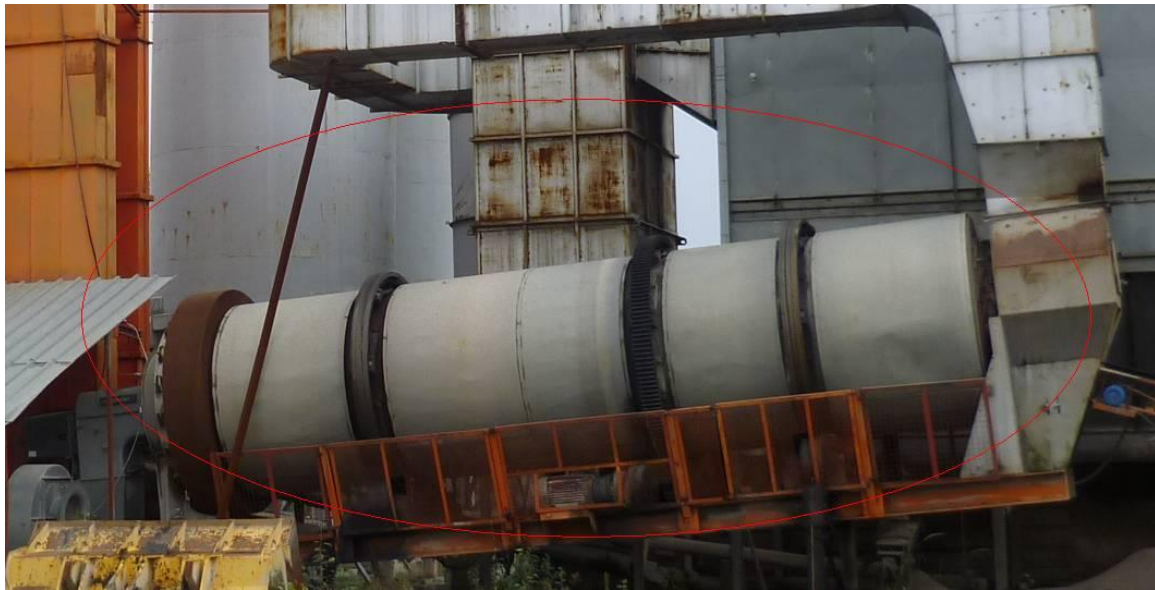
Slika 78. Rotacijski bubanj na asfaltnom postrojenju u Lužanima
