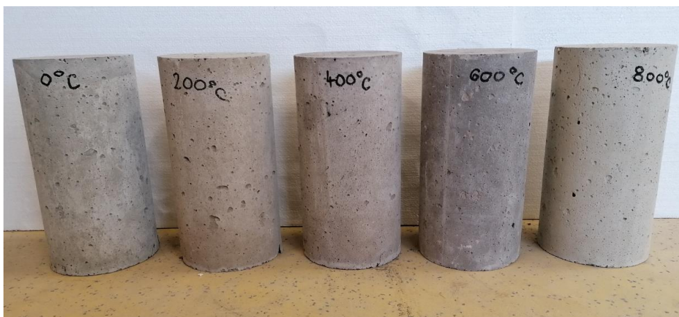
Slika 6.31 Promjena boje uzoraka betonske mješavine SCC-10CR-0SLF
