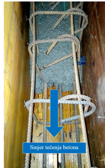
Slika 7.4 Tečenje betona pod djelovanjem vlastite težine
