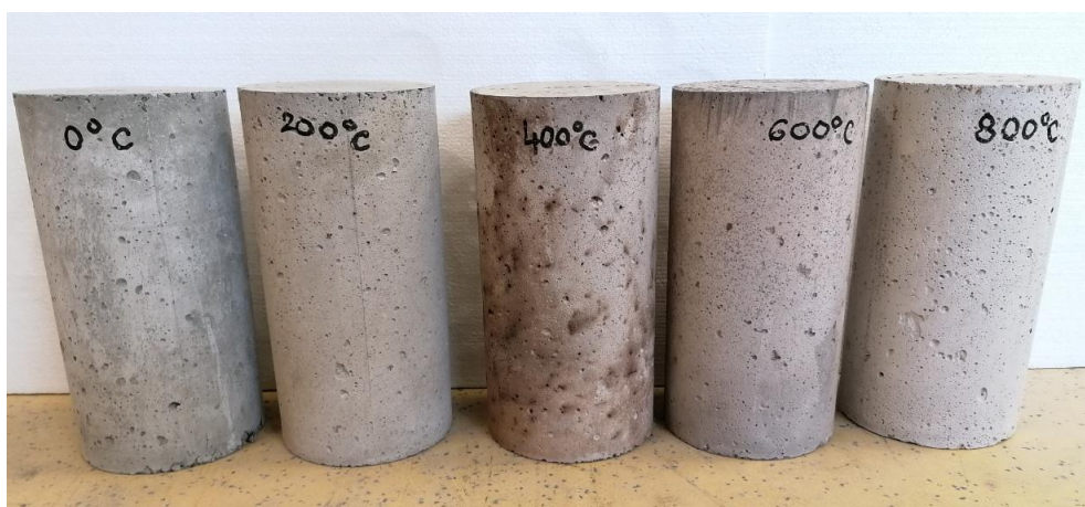
Slika 6.32 Promjena boje uzoraka betonske mješavine SCC-15CR-5SLF
