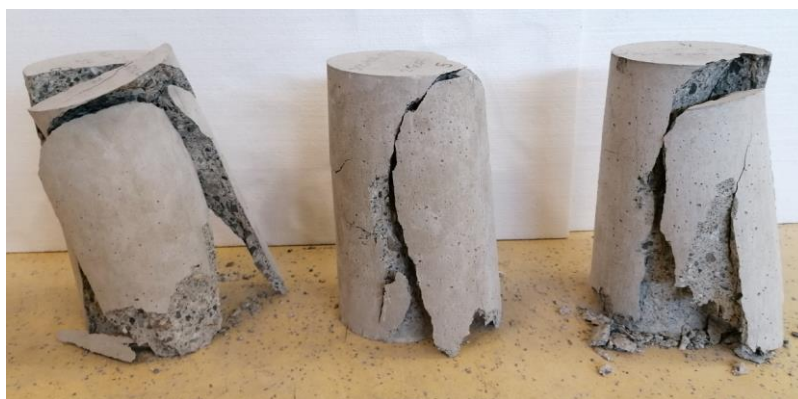
Slika 6.51 Prikaz eksplozivnog odlamanja prilikom ispitivanja tlačne čvrstoće uzoraka referentne betonske mješavine SCC-OCR-OSLF
