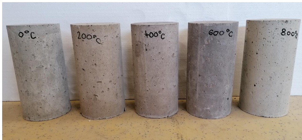
Slika 6.31 Promjena boje uzoraka betonske mješavine SCC-10CR-0SLF
