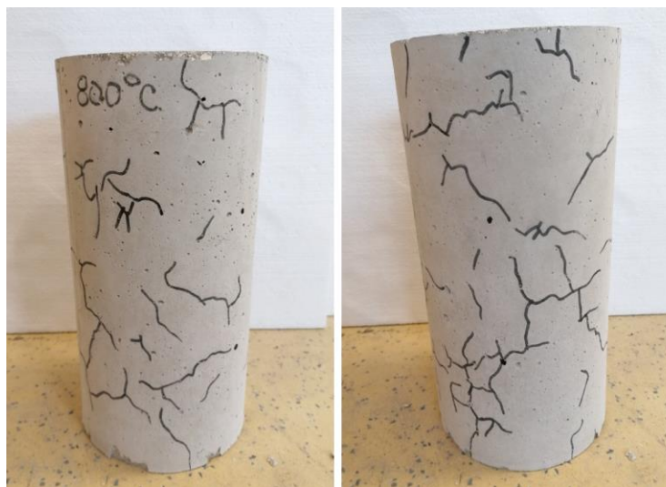
Slika 6.28 Pojava pukotina po cijeloj visini uzorka referentne betonske mješavine (800 °C)
