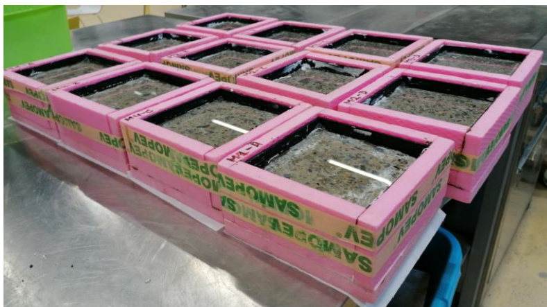
Slika 6.6 Betonski uzorci pripremljeni za ispitivanje otpornosti na cikluse smrzavanja i odmrzavanja
