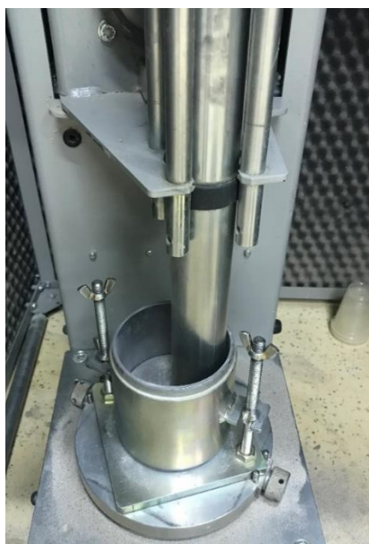
Slika 37. Ispitivanje Proctorovim postupkom.
