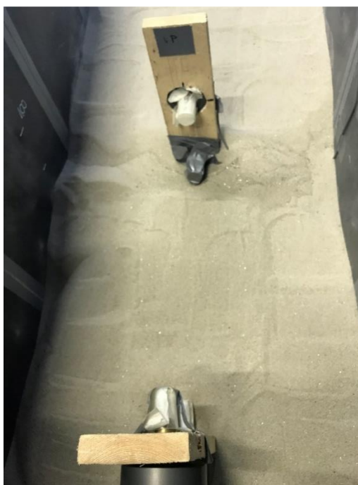
Slika 40. Benderovi elementi postavljeni u spremniku s pijeskom.
