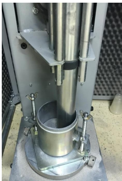
Slika 37. Ispitivanje Proctorovim postupkom.
