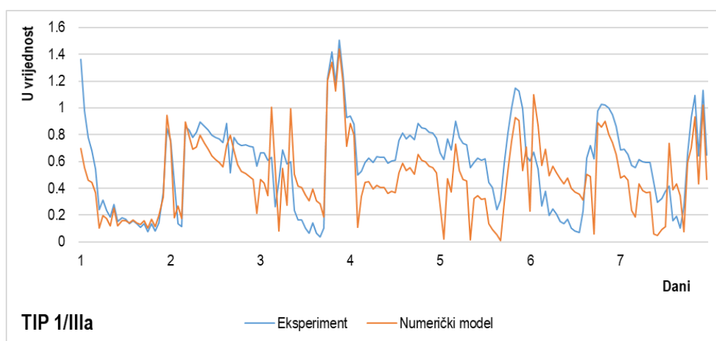
Slika 6.7 Usporedni prikaz rezultata numeričke simulacije U vrijednosti i in situ mjerenja TBM-om, model 1/IIIa
