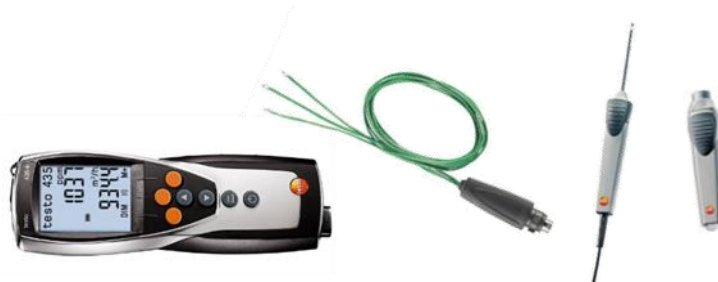
Slika 4.15 Uređaj Testo 435-4, sonda s trostrukim sustavom senzora za mjerenje temperature površine zida ( T_w ) i senzorom na priključku sonde za određivanje unutarnje temperature zraka ( T_i ) te bežična sonda za određivanje vanjske temperature zraka ( T_e ) [201]
