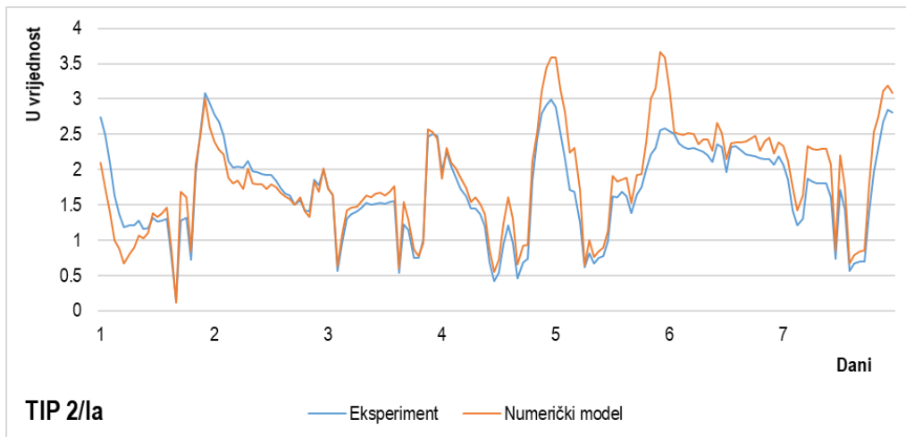
Slika 6.1 Usporedni prikaz rezultata numeričke simulacije U vrijednosti i in situ mjerenja TBM-om, model 2/Ia
