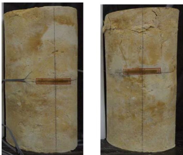
Slika 7.1. Vapnenački uzorak katarskih stijena prije i poslije UCS ispitivanja
