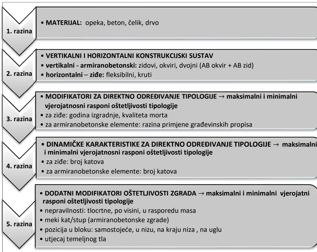
Slika 4.23 Algoritam za definiranje razredbenih pravila i usvajanje konstrukcijskih tipologija (prema Pavić i dr. 2020a)
