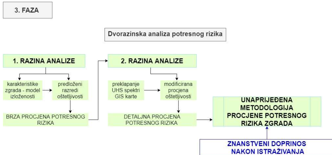
Slika 1.4 Shematski prikaz – unaprijeđena dvorazinska analiza potresnog rizika
