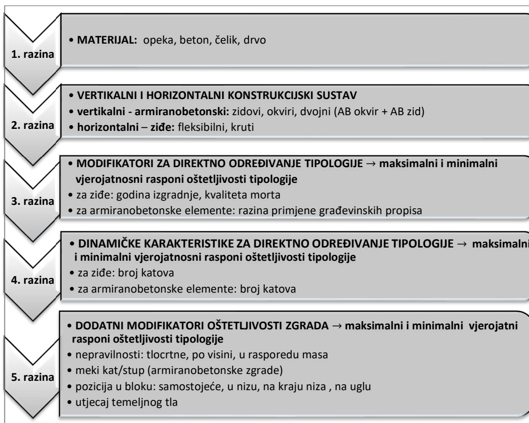
Slika 4.23 Algoritam za definiranje razredbenih pravila i usvajanje konstrukcijskih tipologija (prema Pavić i dr. 2020a)
