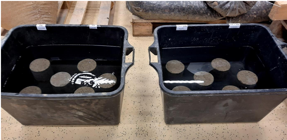
Slika 3.10. Uzorci potopljeni u vodu i otopinu natrijevog klorida
