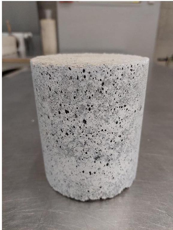
Slika 3.15. Uzorak pripremljen za ispitivanje statičkog modula elastičnosti
