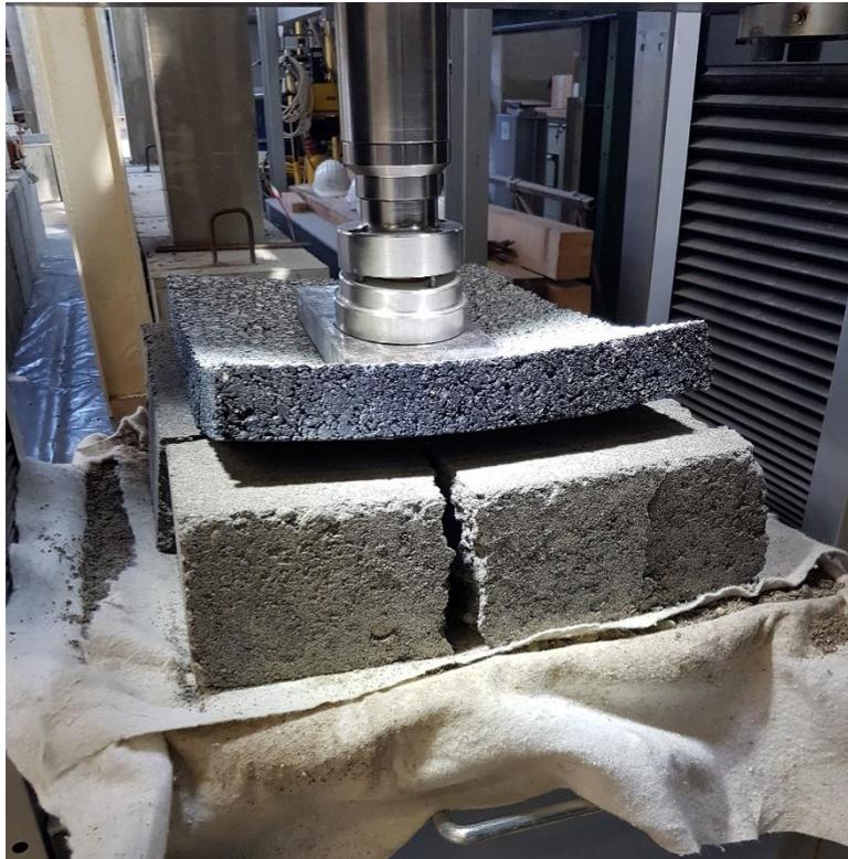
Slika 6.14. Lom konstrukcije uslijed ponavljajućeg opterećenja
