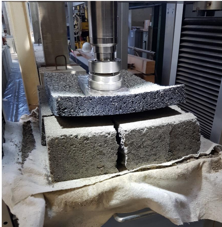
Slika 6.14. Lom konstrukcije uslijed ponavljajućeg opterećenja
