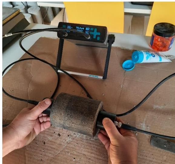
Slika 3.13. Mjerenje brzine ultrazvučnog impulsa
