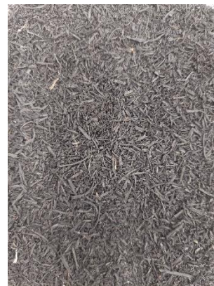
Gumene niti 0.8 – 3 mm
