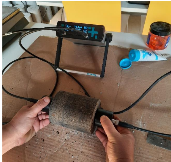
Slika 3.13. Mjerenje brzine ultrazvučnog impulsa
