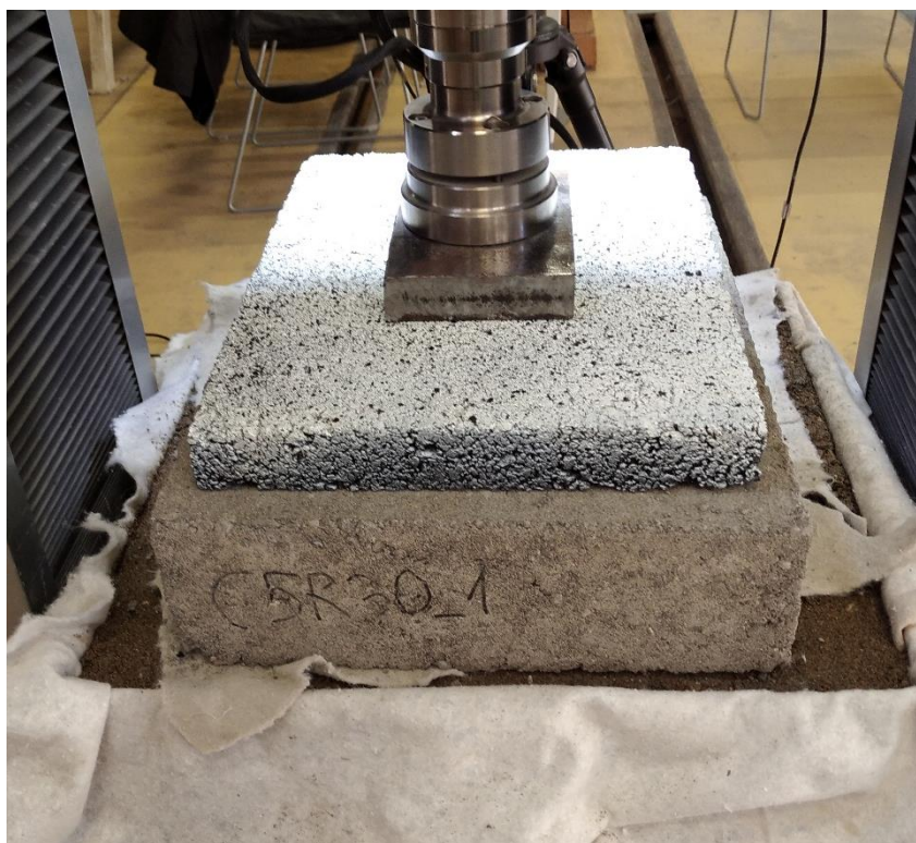
Slika 3.25. Sustav kolničke konstrukcije
