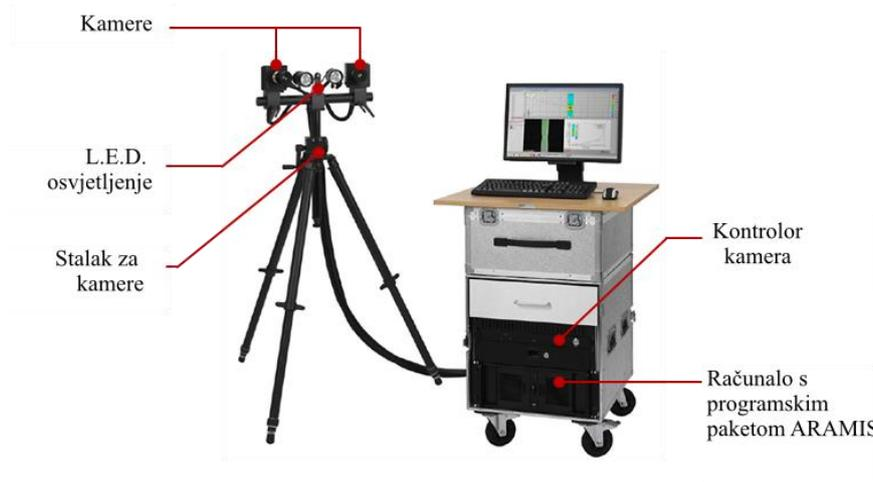
Slika 3.14. Sustav GOM ARAMIS za digitalnu stereo fotogrametriju
