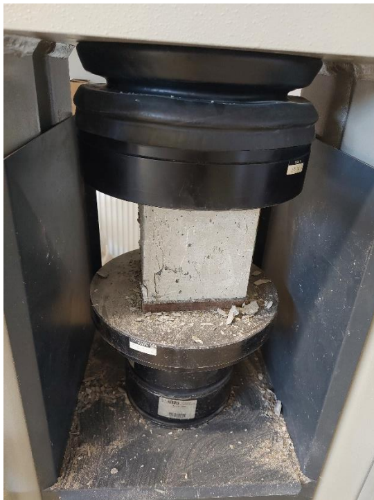
Slika 6.21. Ispitivanje tlačne čvrstoće betona
