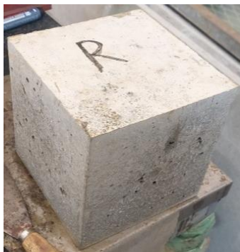
Slika 7.1. Betonske kocke izmjera 15 x 15 x 15 cm
