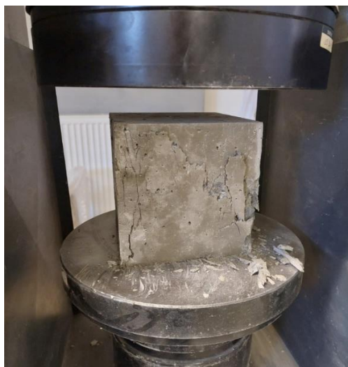
Slika 7.4. Ispitivanje tlačne čvrstoće betona
