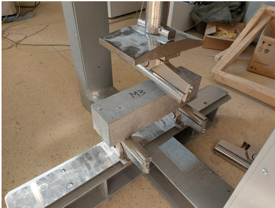
Slika 6.46. Ispitivanje vlačne čvrstoće betona savijanjem
