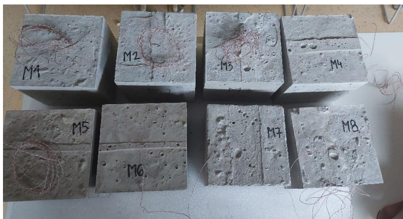
Slika 6.22. Kocke betona s ugrađenim termoparovima
