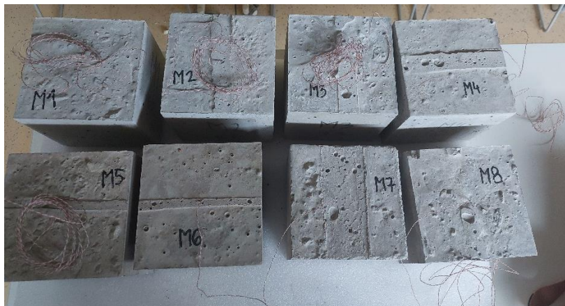
Slika 6.22. Kocke betona s ugrađenim termoparovima
