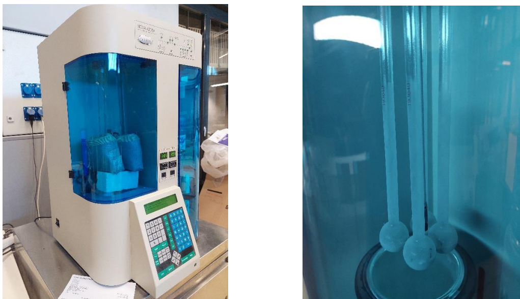
Slika 6.4. Priprema uzoraka za ispitivanje i uređaj za određivanje specifične površine BET metodom
