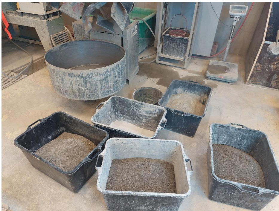
Slika 6.1. Frakcija agregata korištene za izradu betonskih mješavina
