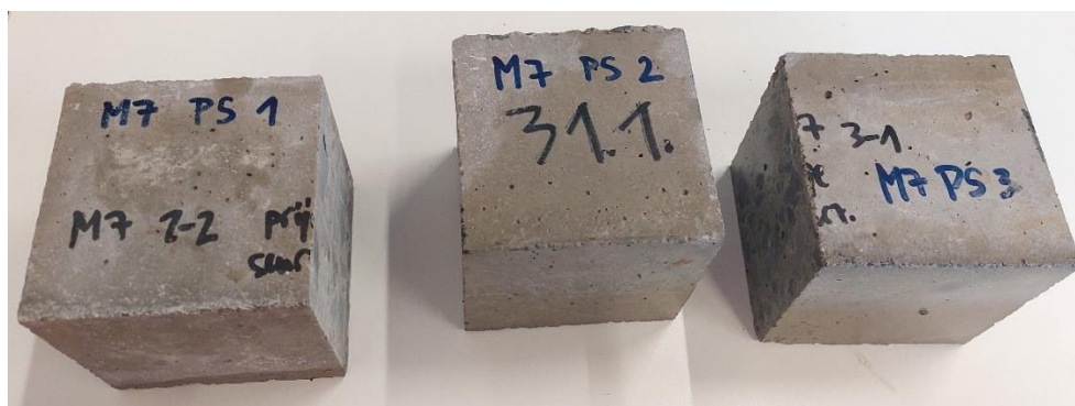
Slika 6.63. Betonske kocke mješavine M7 dimenzija 10 x 10 cm
