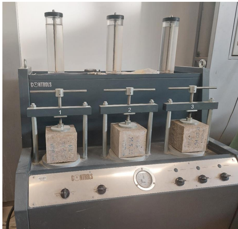
Slika 6.49. Ispitivanje kocaka betona na prodor vode pod tlakom
