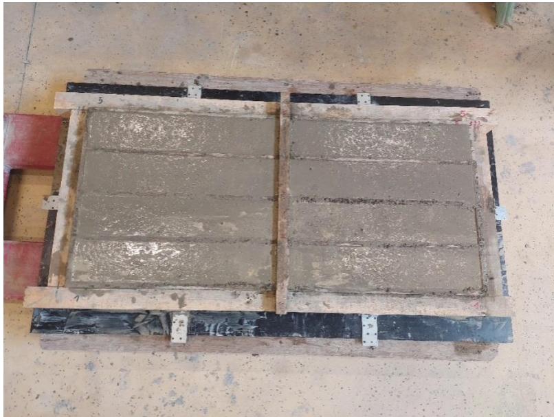
Slika 7.15. Svježi beton u oplati
