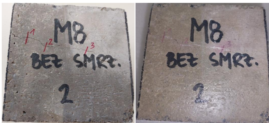
Slika 6.81. Mješavina M8 bez smrzavanja (lijevo – prije samocijeljenja, desno - nakon samocijeljenja)
