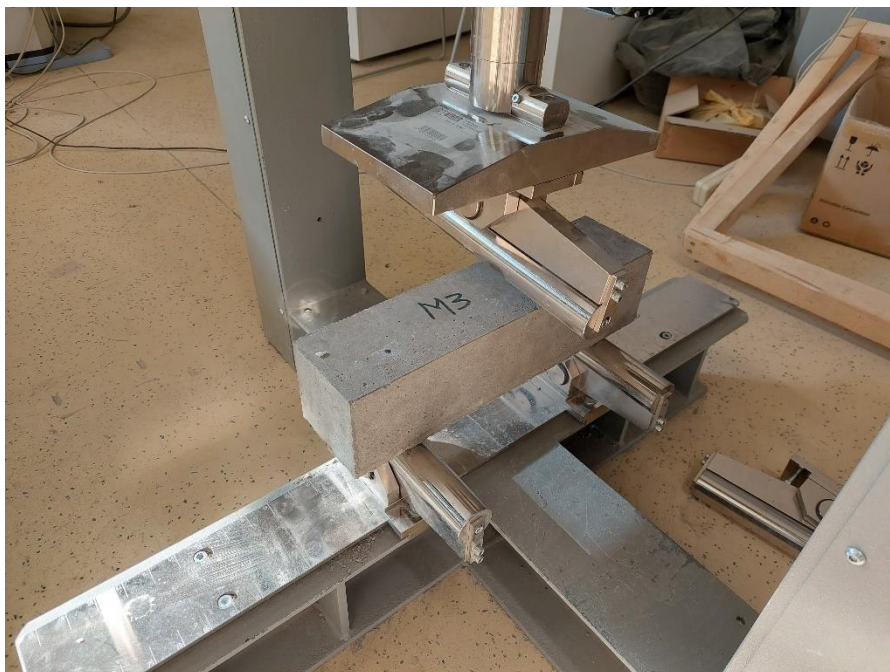
Slika 6.46. Ispitivanje vlačne čvrstoće betona savijanjem
