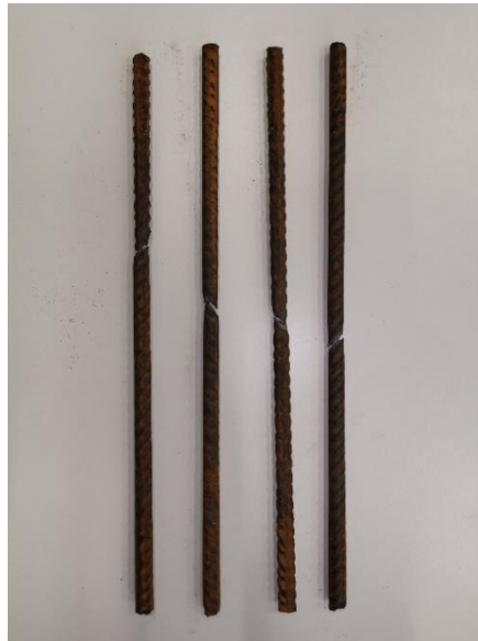
Slika 7.7. Ispitani uzorci uzdužne amature
