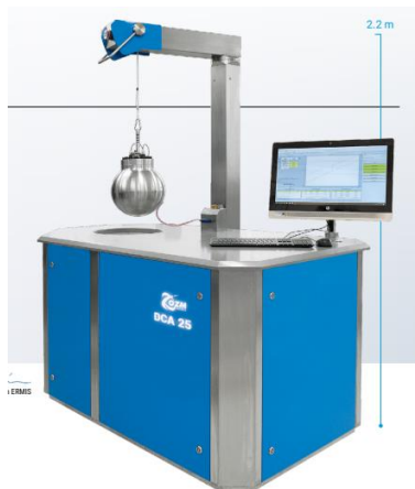
Slika 3.38 Detonacijski kalorimetar (CCA 25) [58]
