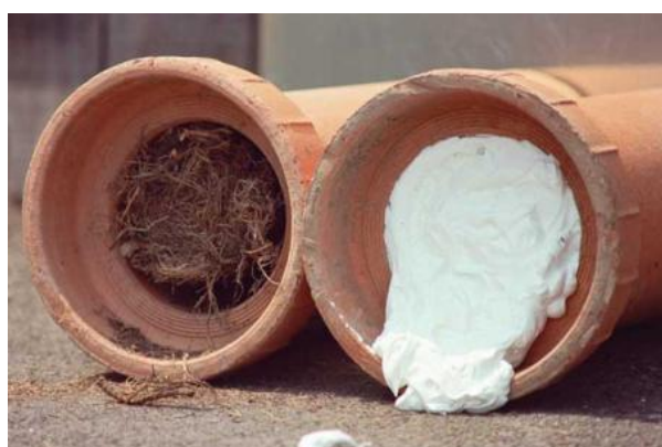
Slika 12. Cijev puna korijenja i pjena u cijevi [43]
