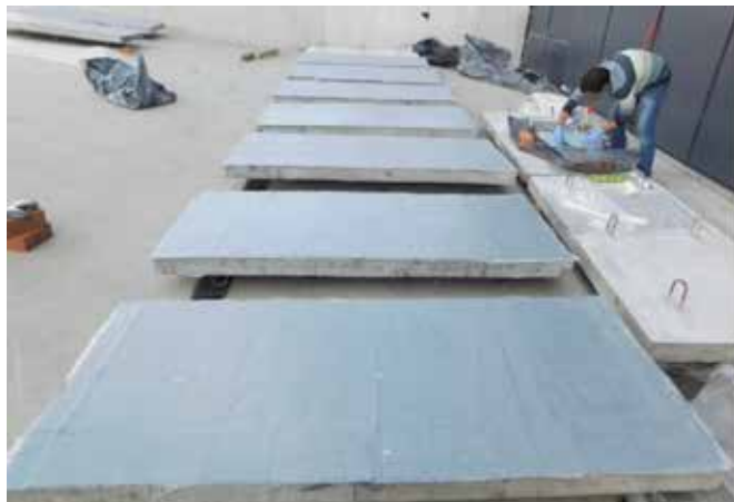
Nanos ojačanja na AB ploče (lijevo) i postavljanje instrumenata za drugu fazu eksperimenta (desno)
