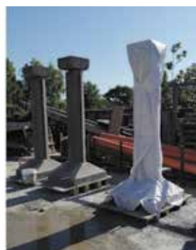
Izvedba, njega i nanos ojačanja na stupove (lijevo i sredina) te postav za treću fazu eksperimenta (desno)
