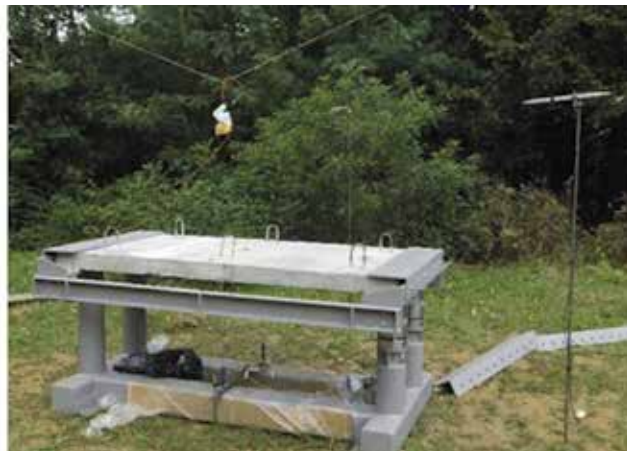
Nanos ojačanja na AB ploče (lijevo) i postavljanje instrumenata za drugu fazu eksperimenta (desno)
