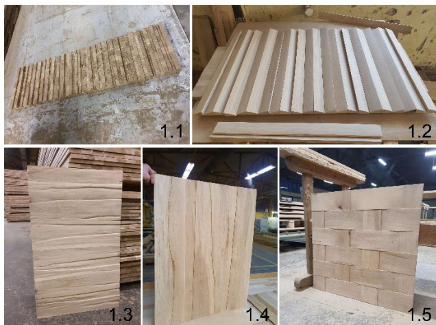
Slika 1. Primjeri ostataka iz proizvodnje: 1) okrajci dužinsko širinske ploče, 2) letvice trokutastog presjeka, 3) rezani furnir – ljepljenje i prešanje, 4) i 5) piljeni furnir – ljepljenje i pletenje
