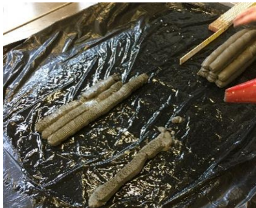
Slika 2. Istiskivanje morta i simuliranje uvjeta 3D printera
