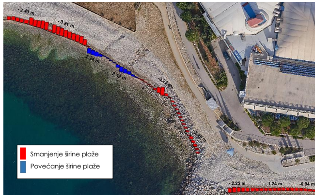
Slika 3. Promjena širine zapadnog i istočnog dijela plaže poslije olujnog događaja u prosincu 2020. godine
