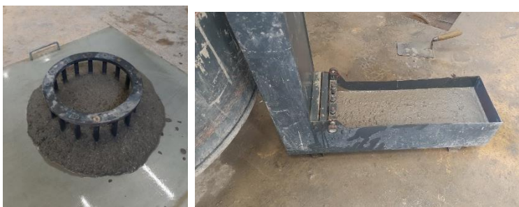
Slika 1. Aparatura za ispitivanje sposobnosti zaobilaženja zapreka betona: J-prsten (lijevo) i L-kutija (desno)
