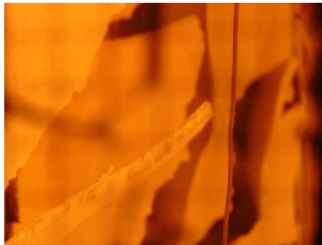
Slika 2. Pukotine i odlomljeni dijelovi vanjske obložne ploče tijekom izlaganja visokoj temperaturi
