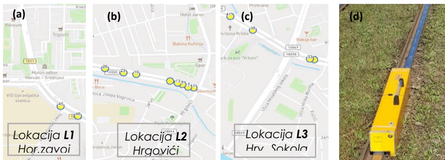
Slika 1. Lokacije mjerenja ravnosti vozne površine tračnica (a,b,c) i prikaz rada uređaja za mjerenje ravnosti tračnica (d)
