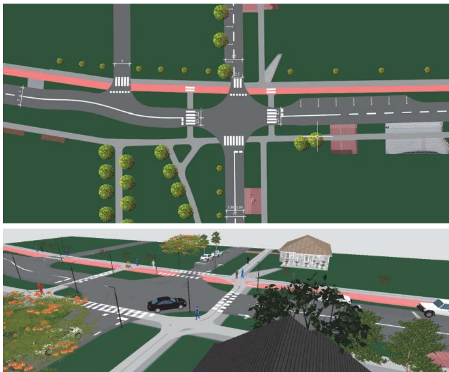
Slika 4. 2D i 3D model drugog varijantnog rješenja rekonstrukcije [29]
