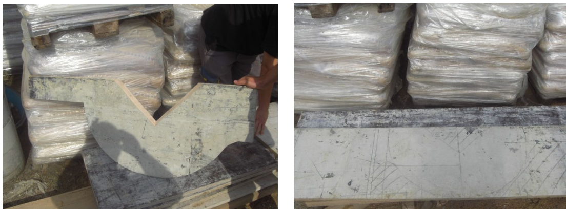
Slika 6 - Izrada trokutnog Thomsonovog preljeva
