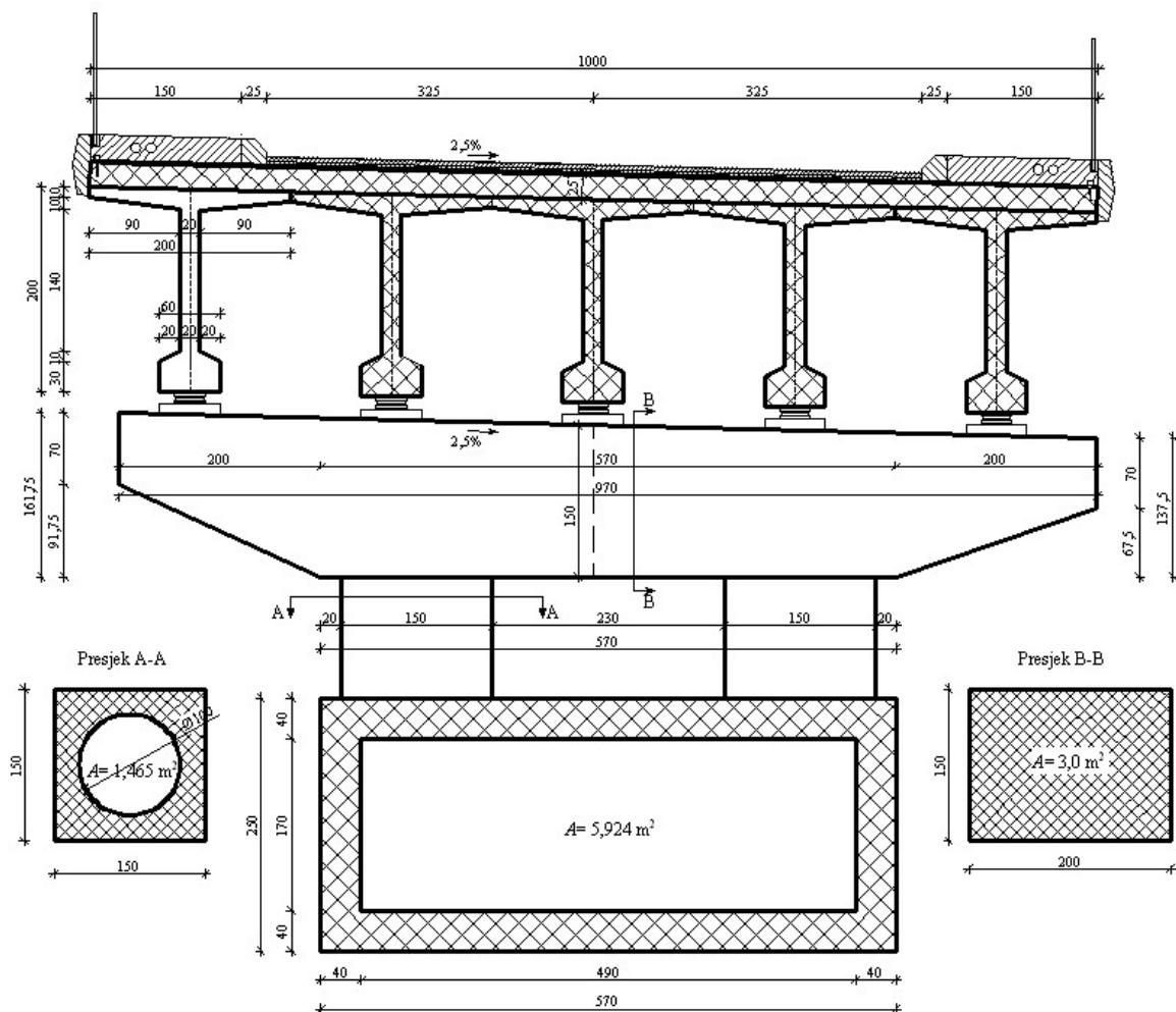
Slika 3 – Poprečni presjek rasponskog sklopa [cm]
