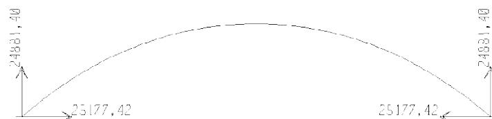
Slika 8 – Reakcije u ležajevima za  $f = 20 \text{ m}$  [kN]
