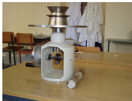
Slika 3 - Potresni stolić za određivanje konzistencije mortova
