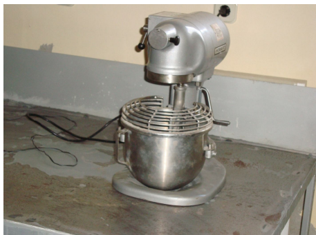
Slika 2 - Miješalica za spravljanje mješavina morta
