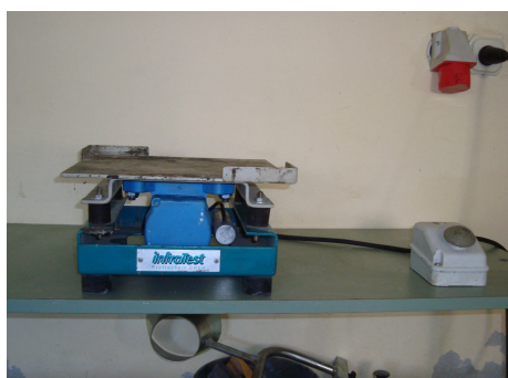
Slika 4 – Vibrostol za zbijanje svježeg morta
