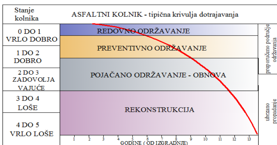
Slika 5 - Tipična linija dotrajavanja asfaltnog kolnika [12]
