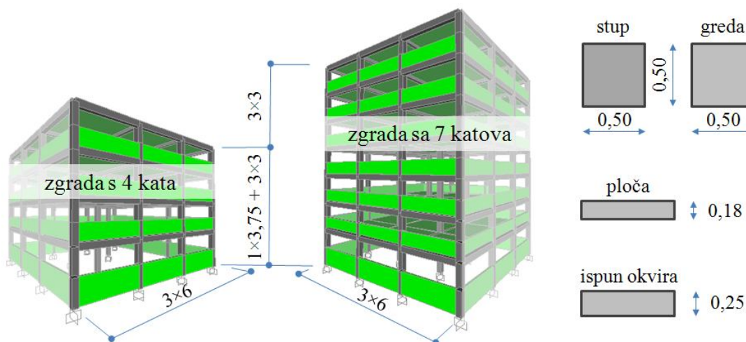
Slika 4 – Geometrija sastavnih elemenata konstrukcije (m)
