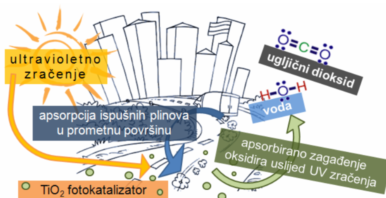
Slika 6 - Fotokatalitički proces na prometnim površinama premazanim titanovim dioksidom, [17] (sliku uredili autori)
