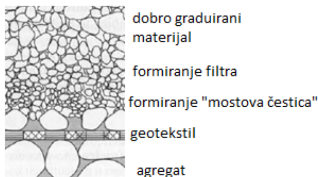
Slika 7 - Prikaz stvaranja internog filtra u tlu [9]
