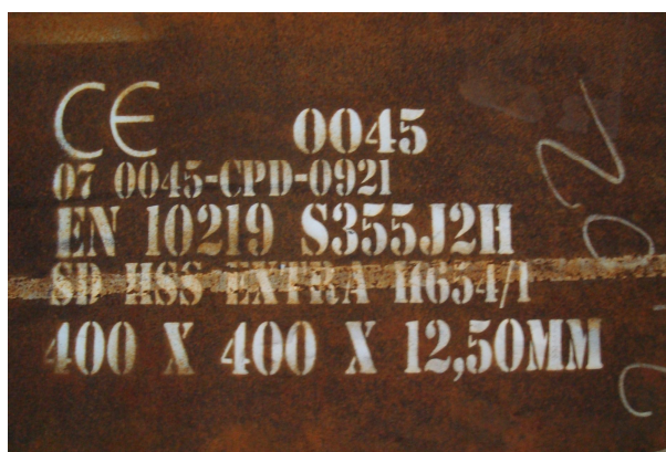
Slika 2 – Oznaka kvalitete čelika za proizvodnju nosača
