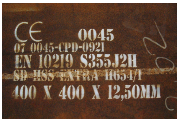
Slika 2 – Oznaka kvalitete čelika za proizvodnju nosača
