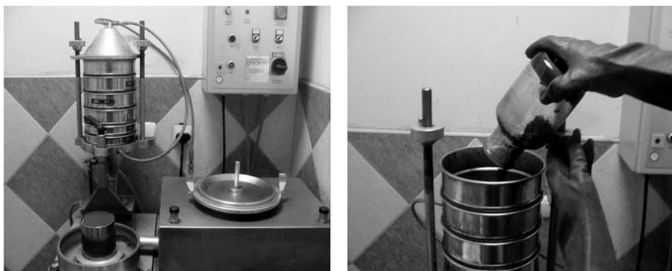
Figure 3 Device for sieving and bitumen separation Slika 3. Uređaj za prosijavanje i odvajanje bitumena
