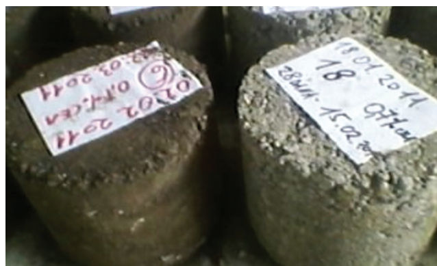
Slika 3. Uzorci stabilizacijskih mješavina (lijevo zgura, desno drobljeni kamen)
