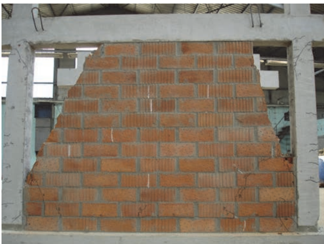
Slika 6. Oštećenje zidane ispunne izvedene od šupljih glinenih zidnih elemenata (uzorci O1_bpm i O3_bpm )
