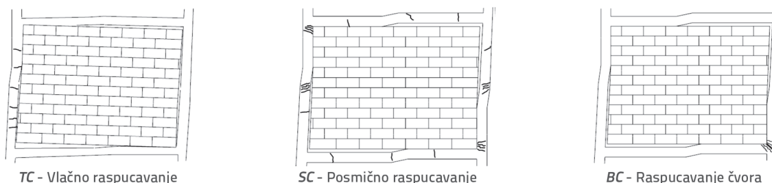
Slika 4. Mehanizmi oštećenja armiranobetonskog okvira, [32]
