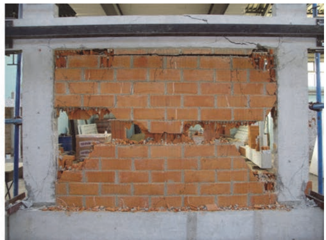
Slika 6. Oštećenje zidane ispunne izvedene od šupljih glinenih zidnih elemenata (uzorci O1_bpm i O3_bpm )
