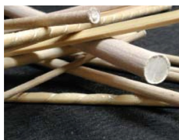
Slika 1. Staklena, ugljična i aramidna vlakna u polimernim šipkama
