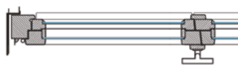
Slika 11. Horizontalni presjek spojnog dvokrillnog prozora
