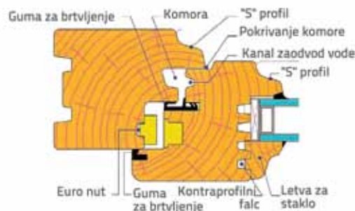
Slika 13. Detalj drvenog prozora s IZO staklima
