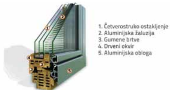
Slika 16. Drveni prozor s četverostrukim ostakljenjem
