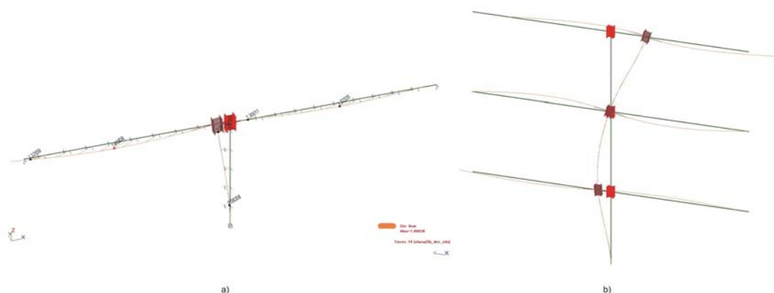
Slika 13. Model primjenom metode konačnih elemenata za a) statički i b) dinamički proračun
