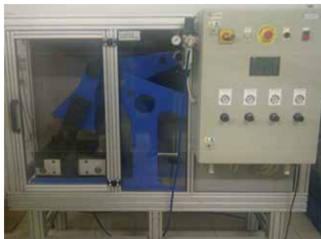
Slika 3. Valjkasti zbijatelj asfaltnog sloja u kalup
