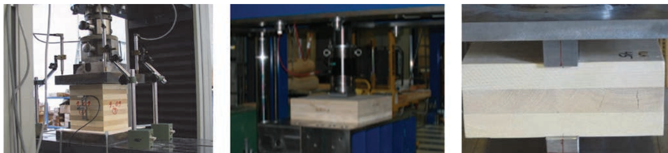
Slika 8. Eksperimentalni uzorci za ispitivanja tlačne čvrstoće okomito na vlakna: Halili [44] (lijevo), Salzmann [45] (sredina) i Serrano [46] (desno)
