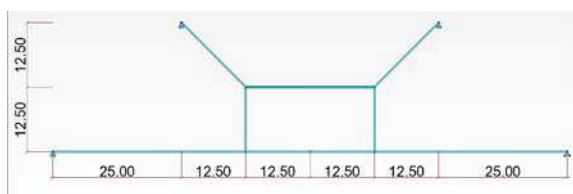
b) model 2: statički određen sustav, ovješena greda
