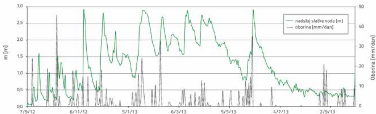
Slika 3. Limnografski podaci o razlici razina vode s "morske" i "slatkovodne" strane pregradnog zida izvedenog na samom izvoru te podaci o oborini s ombrografske postaje Zadar-aerodrom
