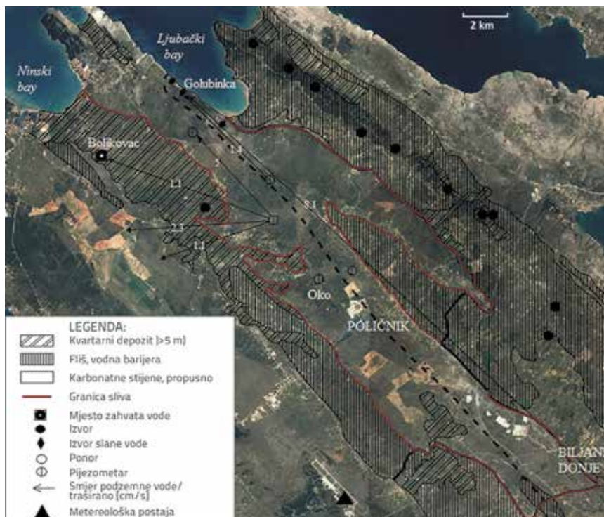
Slika 1. Shematska hidrogeološka karta slivnog područja izvora Golubinka
