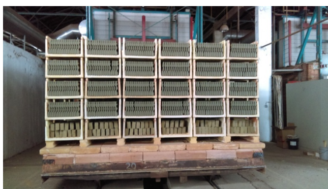
Slika 5.10. Opeke na vagonu priredene za uvođenje u peć
