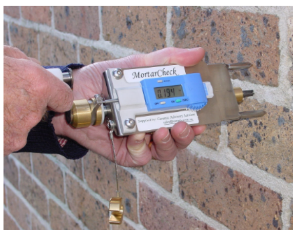
Slika 4.7 Mjerenje indeksa abrazije in situ [186, 187, 189]
