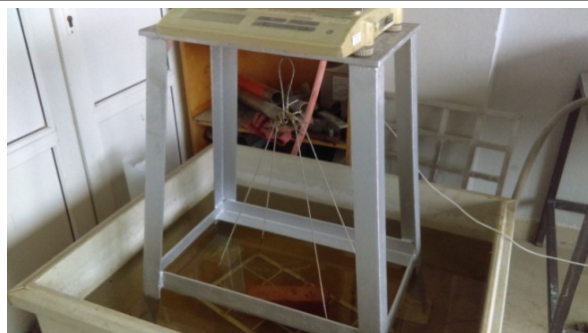
Slika 5.25. Određivanje postotka pora opečnih zidnih elemenata hidrostatskim vaganjem
