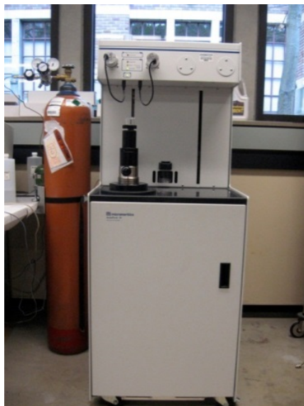
Slika 5.13. AutoPore IV 9500 Hg porozimetar
