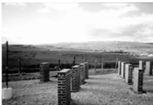
Slika 4.6 Ispitivanje zidnih panela na terenu [184]
