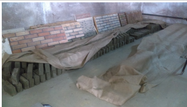
Slika 5.9. Sušenje opeke na podu
