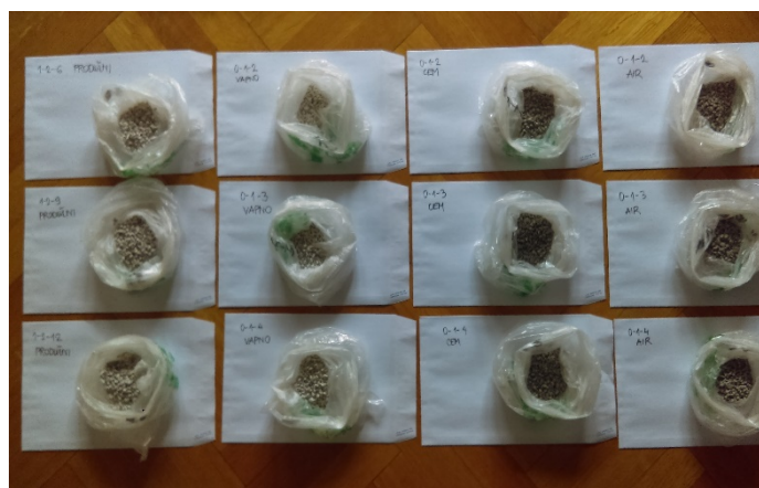
Slika 5.35. Izgled uzoraka za ispitivanje specifične površine mortova BET metodom
