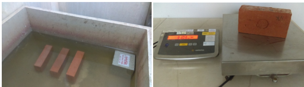
Slika 5.22. Određivanje vodoupojnosti zidnih elemenata: a) potapanje opeka pod vodu na 24h; b) vaganje opeke na zraku
