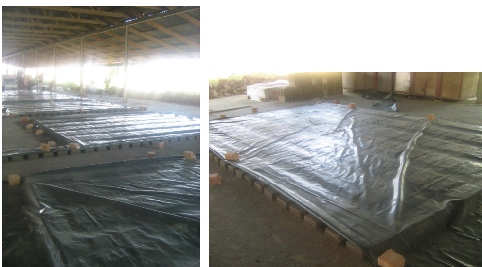
Slika 3.16 Primjer sušenja pune opeke u natkrivenoj sušari prirodnim putem
