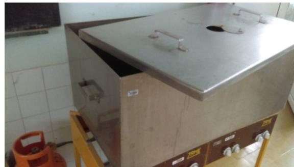
**Slika 5.23.** Ispitivanje vodoupojnosti kuhanjem zidnih elemenata
