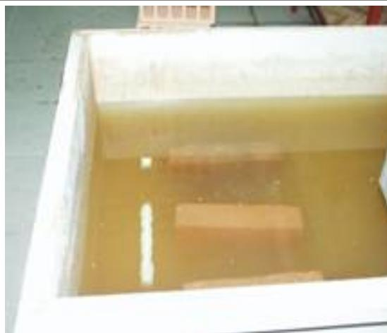
Slika 3.9 Ispitivanje vodoupojnosti opeke
