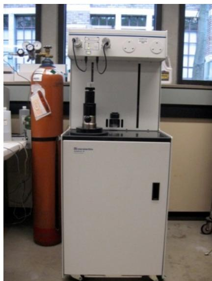
Slika 5.13. AutoPore IV 9500 Hg porozimetar
