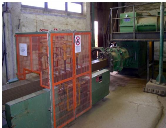
Slika 3.14 Vakumski agregat i rezaći stol
