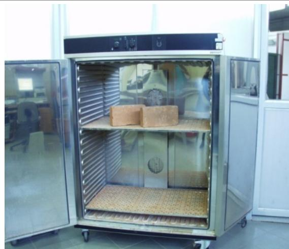
Slika 3.8 Sušenje uzorka u sušioniku
