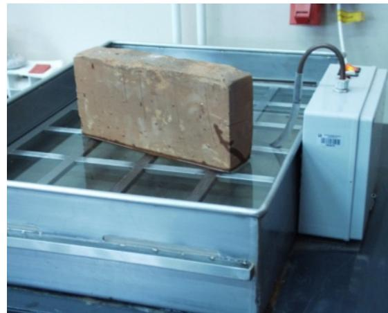
**Slika 5.24.** Određivanje kapilarne vodoupojnosti zidnih elemenata
