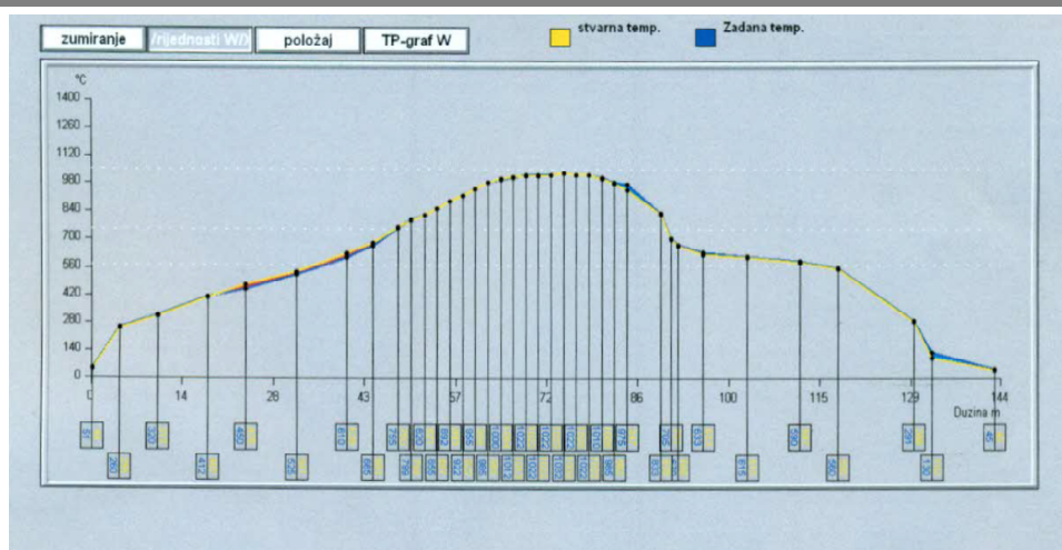
Slika 5.12. Režim pečenja uzoraka na 1060°C
