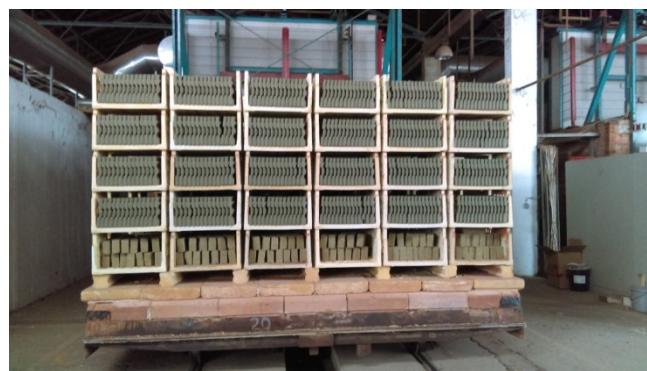
Slika 5.10. Opeke na vagonu priređene za uvođenje u peć
