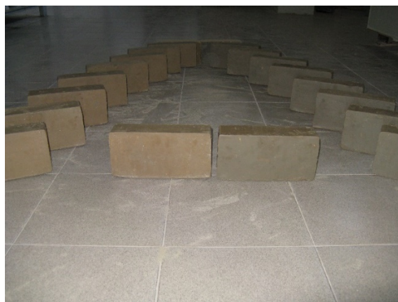
Slika 5.8. Sirovine za kontroliranu proizvodnju: a) boja sirovine kao rezultat sadržaja karbonata; b) boja nepečene opeke kao rezultat sirovine
