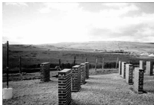
Slika 4.6 Ispitivanje zidnih panela na terenu [184]
