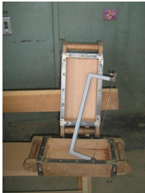
Slika 3.15 Drveni kalup za oblikovanje ručno proizvedene opeke
