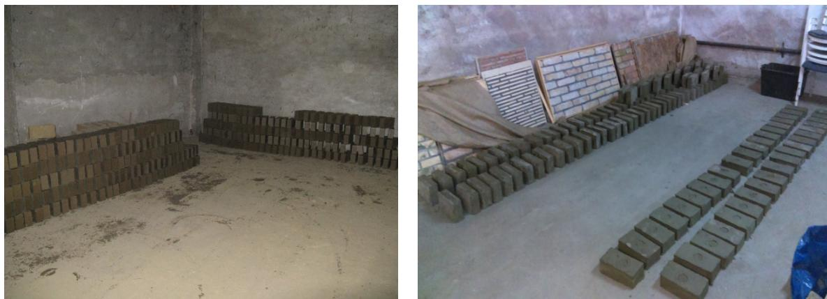
**Slika 5.7.** Uzorci kontrolirane proizvodnje: a) serija opeka proizvedenih strojno; b) serija opeka proizvedenih ručno
