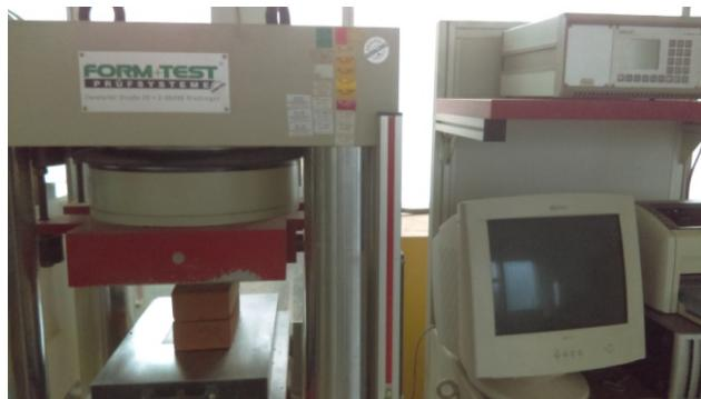
Slika 5.21. Određivanje tlačne čvrstoće zidnih elemenata
