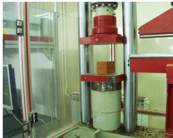
Slika 3.11 Određivanje tlačne čvrstoće u preši
