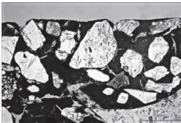
Slika 4.4 Prikaz uzorka srednjovjekovnog morta pod mikroskopom [140]
