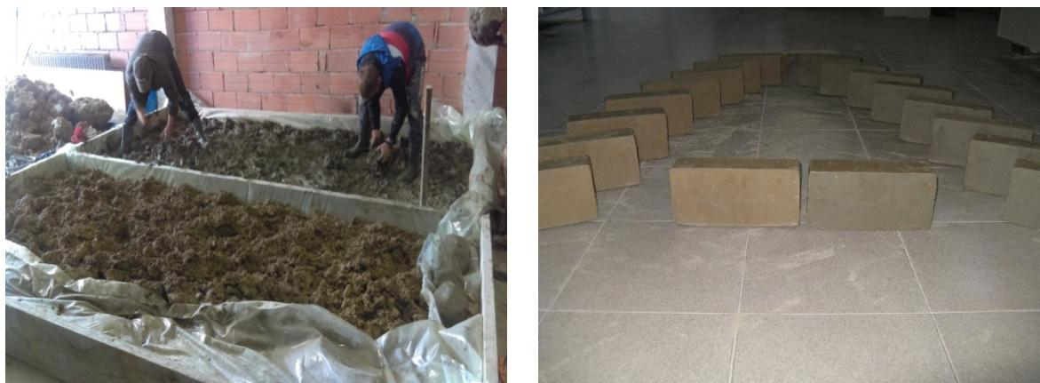
**Slika 5.8.** Sirovine za kontroliranu proizvodnju: a) boja sirovine kao rezultat sadržaja karbonata; b) boja nepečene opeke kao rezultat sirovine
