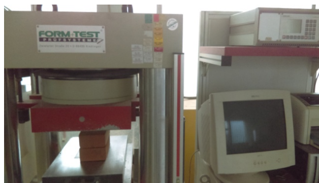
Slika 5.21. Određivanje tlačne čvrstoće zidnih elemenata
