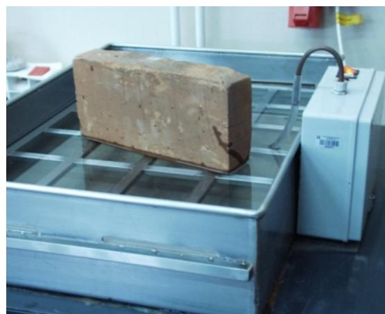
Slika 3.10 Ispitivanje početnog kapilarnog upijanja
