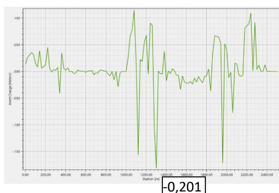
Slika 6.7. Promjena visine dna kanala nakon 120 h
