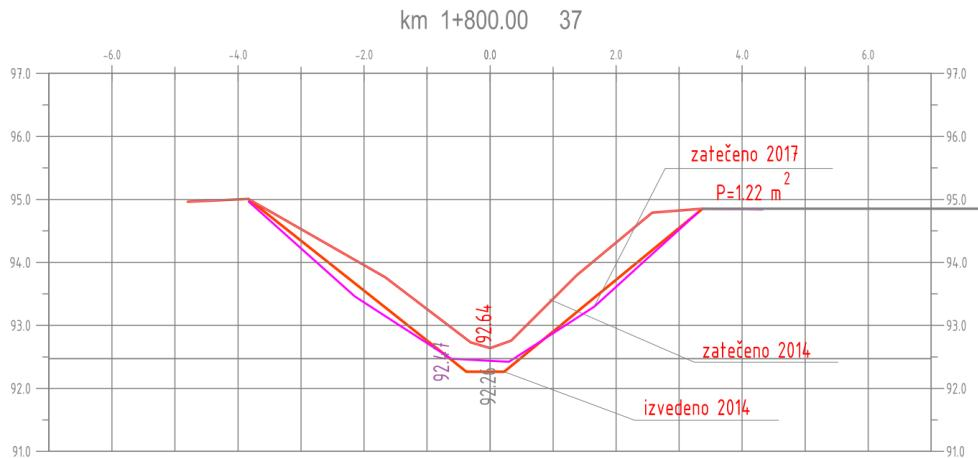
Slika 5.24. Poprečni profil kanala Drobnjak, stac I+800
