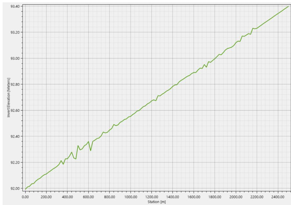
Slika 6.14. Uzdužni profil promjena nivelete dna kanala
