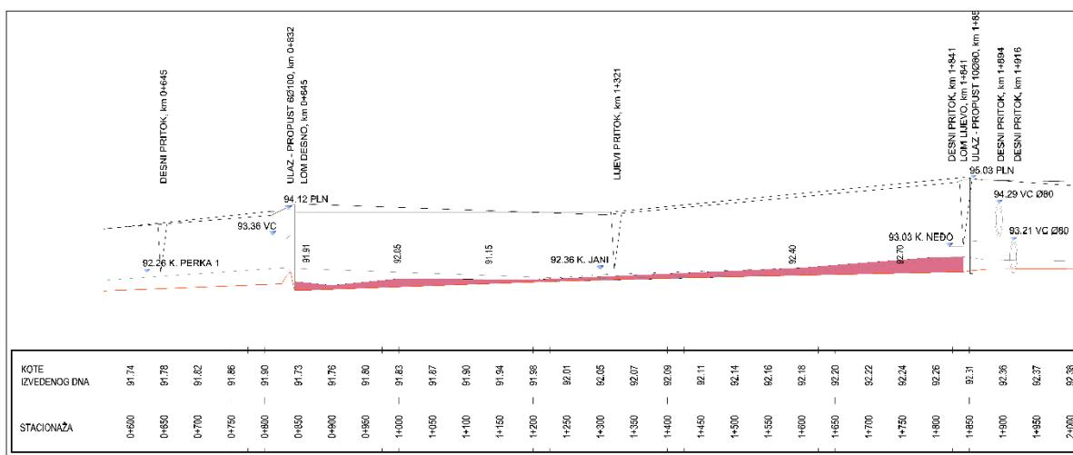
Slika 5.23. Uzdužni profil kanala Drobnjak
