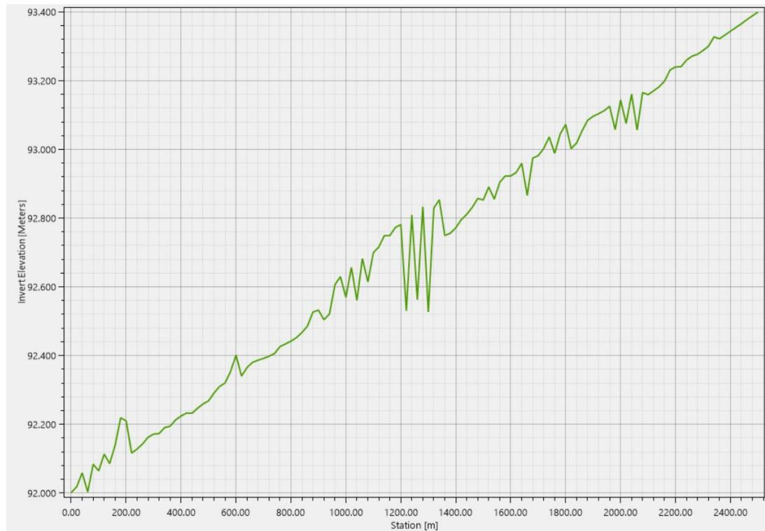
Slika 6.18. Uzdužni profil promjene nivelete dna kanala
