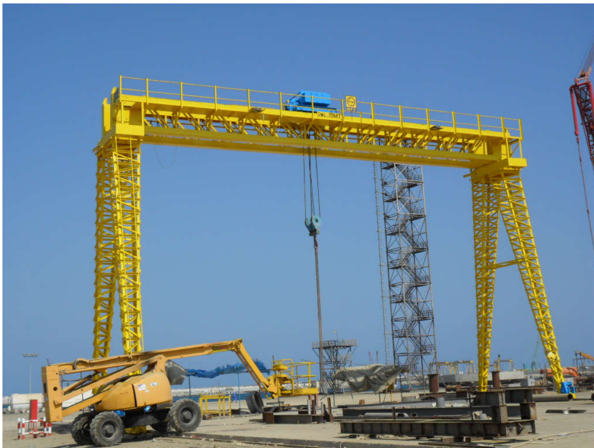
Slika 9: mostni kran sa rešetkastim nosačem
