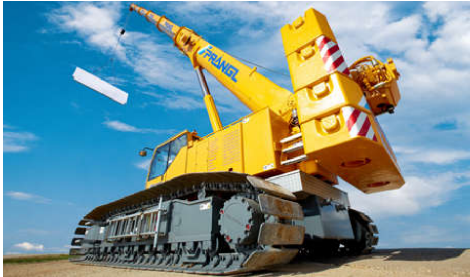
Slika 4:dizalica na gusjenicama sa teleskopom
