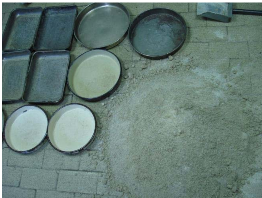
Slika 6-6: Homogenizirani i pripremljeni uzorak za ispitivanje
