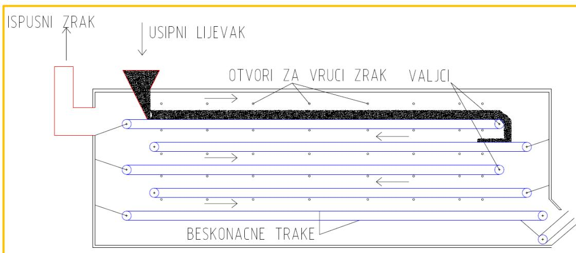
Slika 7-22. Shematski prikaz trakaste sušare [45]
