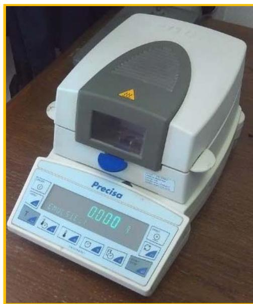
Slika 6-25: Uređaj za ispitivanje vlažnosti
