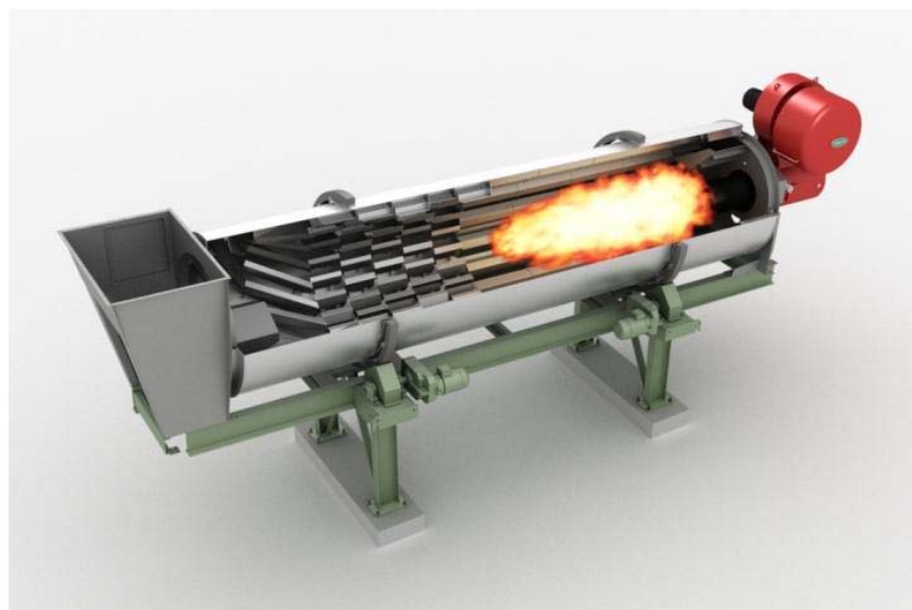
Slika 5-1: Otvoreni plamen iz plamenika usmjeren u rotacijski bubanj [70]
