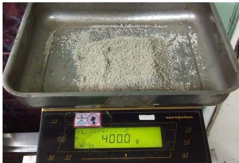
*Slika 6-9: Određivanje mase uzorka prije ispitivanja vaganjem*
