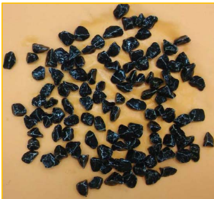
Slika 7-19: Uzorak nakon 6 sati ispitivanja prionjivosti agregata i bitumena
