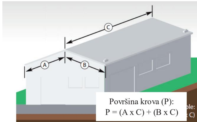
Slika 5. Primjer izračuna površine krova (KingspanWater, 2012)
