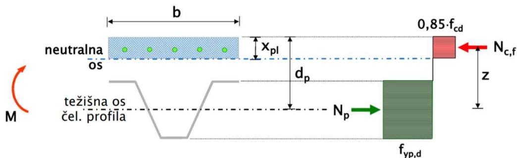
**Slika 18.1 - Dijagram unutarnjih sila spregnute ploče kada se plastična neutralna os nalazi u betonskoj ploči (pozitivan moment) [7]**
