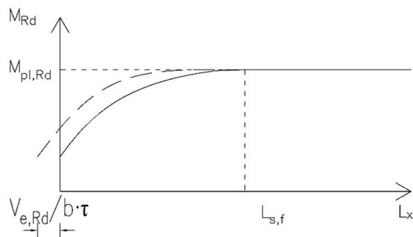
Slika 19.7 - Povećanje područja otpornosti na moment savijanja
