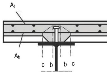
Slika 10.6 - Posmične površine b-b i c-c [5]
