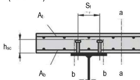
Slika 10.2 - Posmične površine a-a i b-b [5]
