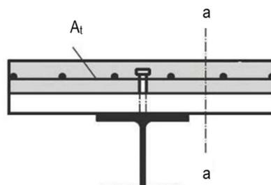
**Slika 10.510 - Posmična površina a-a [5]**
