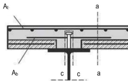
Slika 10.83 - Posmične površine a-a i c-c [5]
