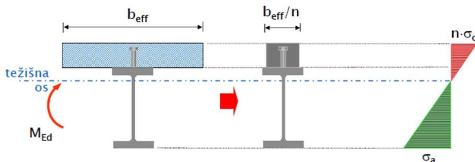
Slika 5.1 - Svođenje spregnutog presjeka na proračunski poprečni presjek [7]
