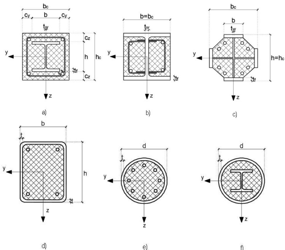
Slika 12.1 – Različite vrste poprečnih presjeka spregnutih stupova
