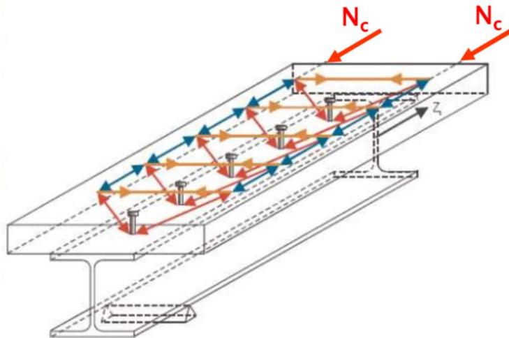
Slika 10.1 - Formiranje raspodjele sila unutar betonske pojasnice [2]
