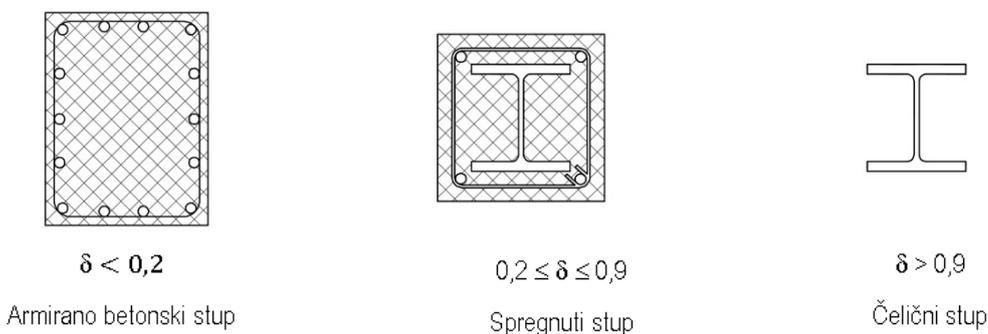
**Slika 12.2 – Različite vrste poprečnih presjeka spregnutih stupova**
