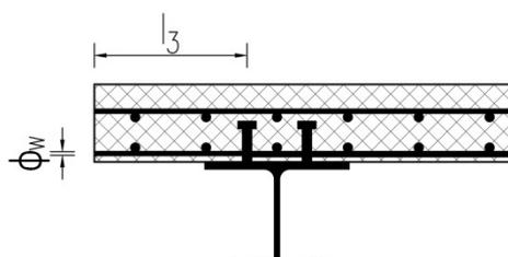
**Slika 9.10 - Konstrukcijske preporuke za poprečnu armaturu i zaštitu od uzdužnog cijepanja**
