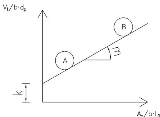
Slika 19.2 - Način otkazivanja spregnute ploče ovisno o rasponu
