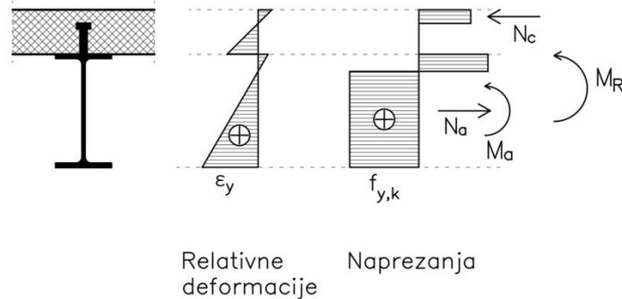
**Slika 9.3 - Relativne deformacije i naprezanja spregnutog nosača s djelomičnom posmičnom vezom prema [2]**
