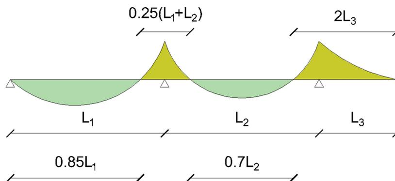
**Slika 2.2 - Proračunski rasponi nosača na primjeru kontinuiranog nosača**
