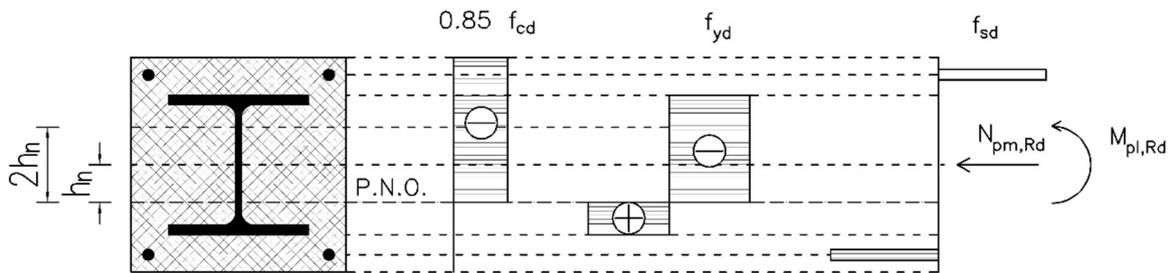
Slika 13.4 - Stanje naprezanja u točki C
