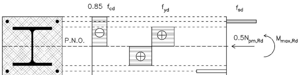
Slika 13.5 - Stanje naprezanja u točki D
