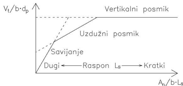
Slika 19.3 - Način otkazivanja spregnute ploče ovisno o rasponu
