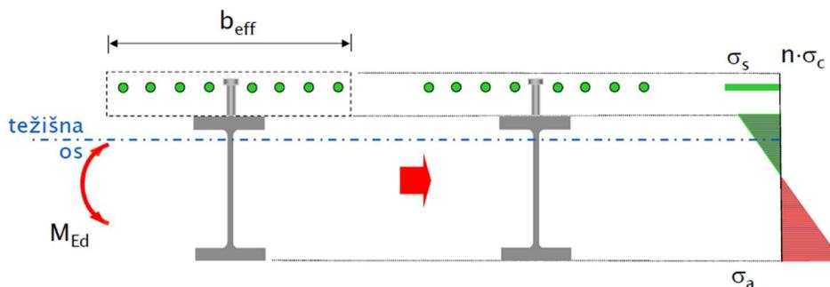
Slika 5.2 - Proračunski poprečni presjek prilikom negativnog momenta savijanja [7]
