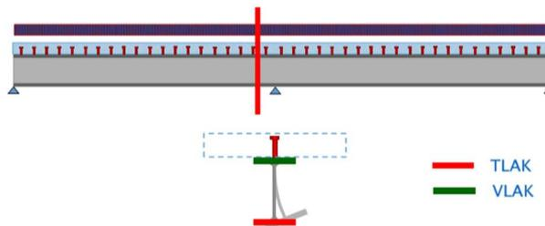
Slika 7.2 – Donja pojasnica čeličnog nosača u tlaku (postoji problem bočno-torzijskog izvijanja) [7]
