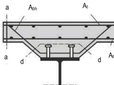
Slika 10.94 - Posmične površine a-a i d-d [5]
