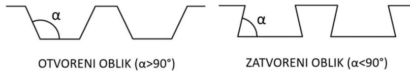
**Slika 16.2 – Osnovni oblici profiliranih limova**
