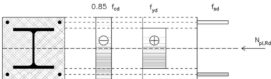
Slika 13.2 - Stanje naprezanja u točki A
