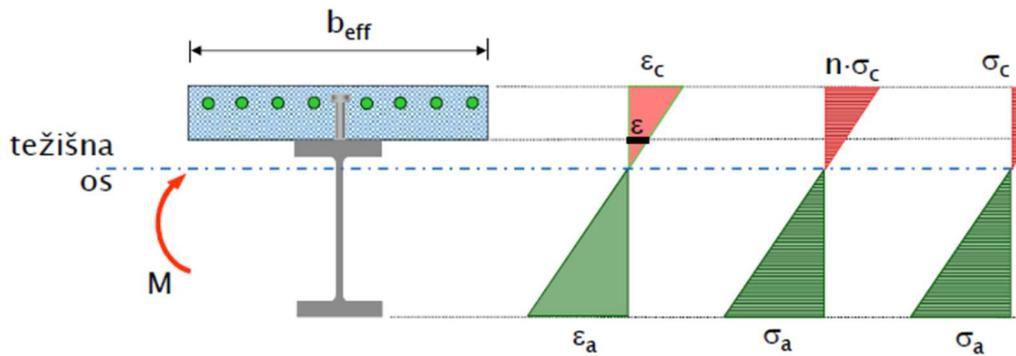
Slika 5.4 - Određivanje naprezanja kod podprtih nosača [7]
