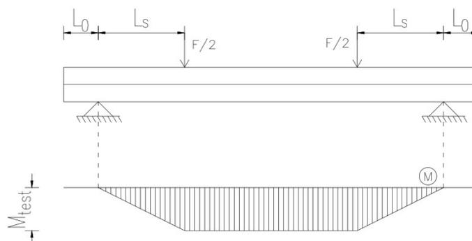
Slika 19.4 – Postav ispitivanja za određivanje  $\tau_{u,Rd}$  prema [2] [5]
