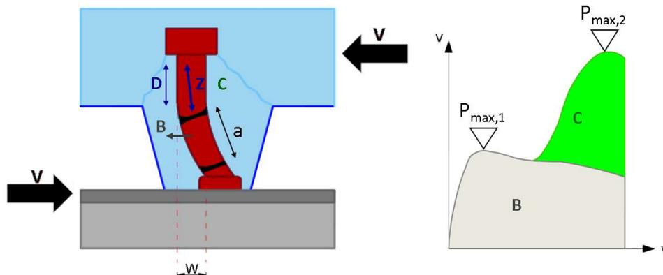
Slika 8.6 – Model nosivosti moždanika s glavom u ploči s profiliranim čeličnim limom, s rebrima okomitim čelični nosač [7]
