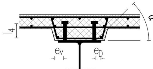
Slika 9.11 - Konstruktivske preporuke za betonsku vutu
