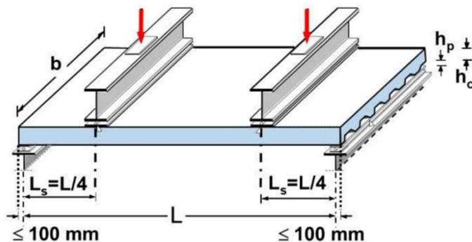
Slika 17.1 - Normirani postupak ispitivanja spregnute ploče [7]
