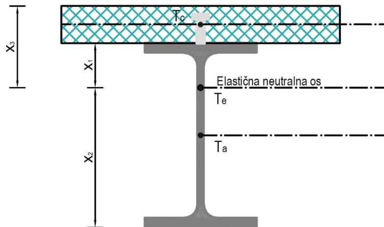
Slika 5.5 - Prikaz udaljenosti težišta spregnutog presjeka do rubova presjeka
