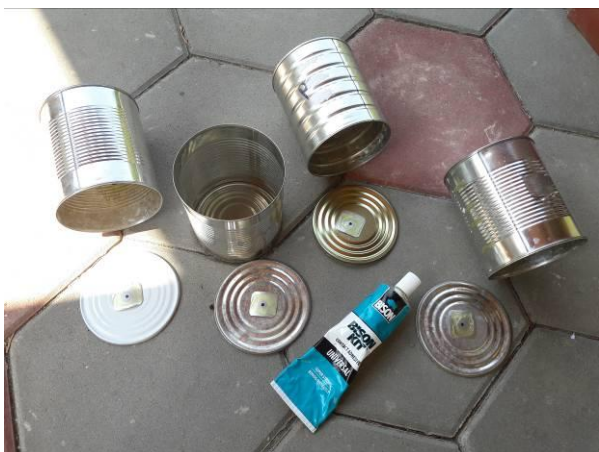
Slika 16. Fiksiranje blende lijepljenjem
