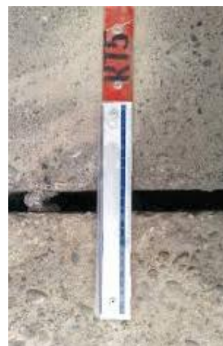
Slika 9. Ravnalo za mjerenje vertikalnih pukotina
