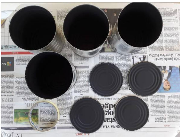
Slika 18. Bojanje unutrašnjosti kamere crnom mat bojom
