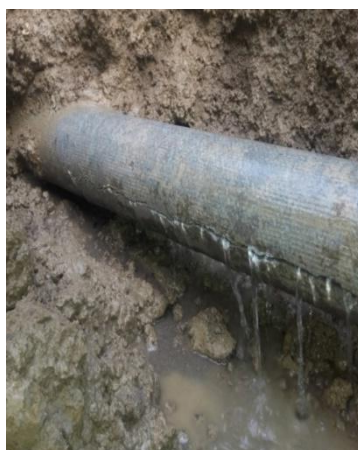
Slika 5. Vidljivo curenje - puknuće azbestno cementne cijevi 15.11.2017., godine u Ulici Zinke Kunc Belišće, puknuta i sanirana azbestno cementna cijev
