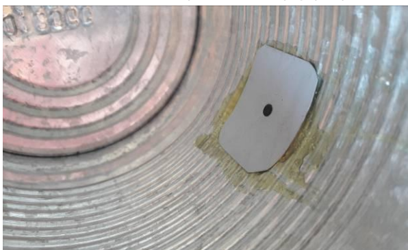
Slika 17. Smještaj blende u unutrašnjosti kamere
