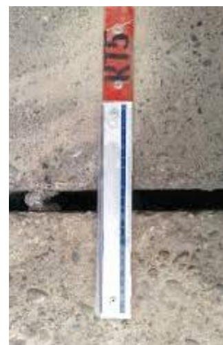
Slika 9. Ravnalo za mjerenje vertikalnih pukotina
