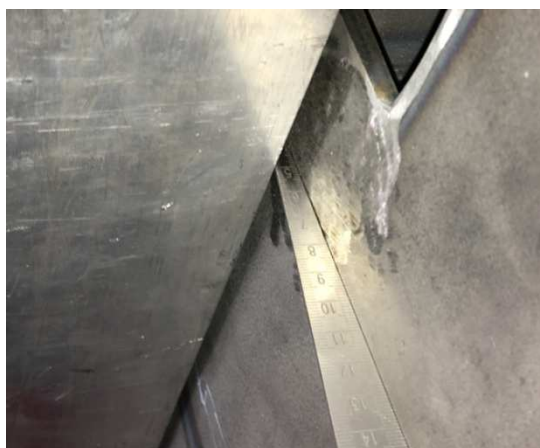
Slika 6. Stub zavaren izvan alata
