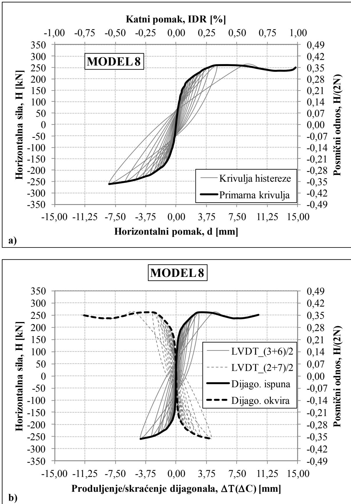
Slika 4.44 a) Krivulja horizontalna sila – pomak armirano-betonskog okvira sa zidnim ispunom za MODEL 8,
