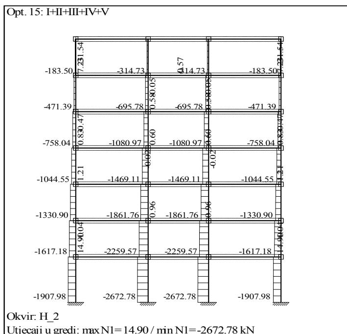
**Slika 2.15** Unutarnje uzdužne sile u srednjem okviru (H\_2)
