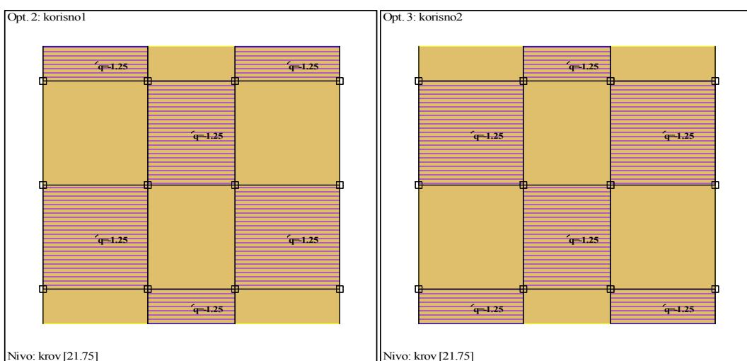
**Slika 2.9** Raspodjela korisnog opterećenja po krovnoj ploči
