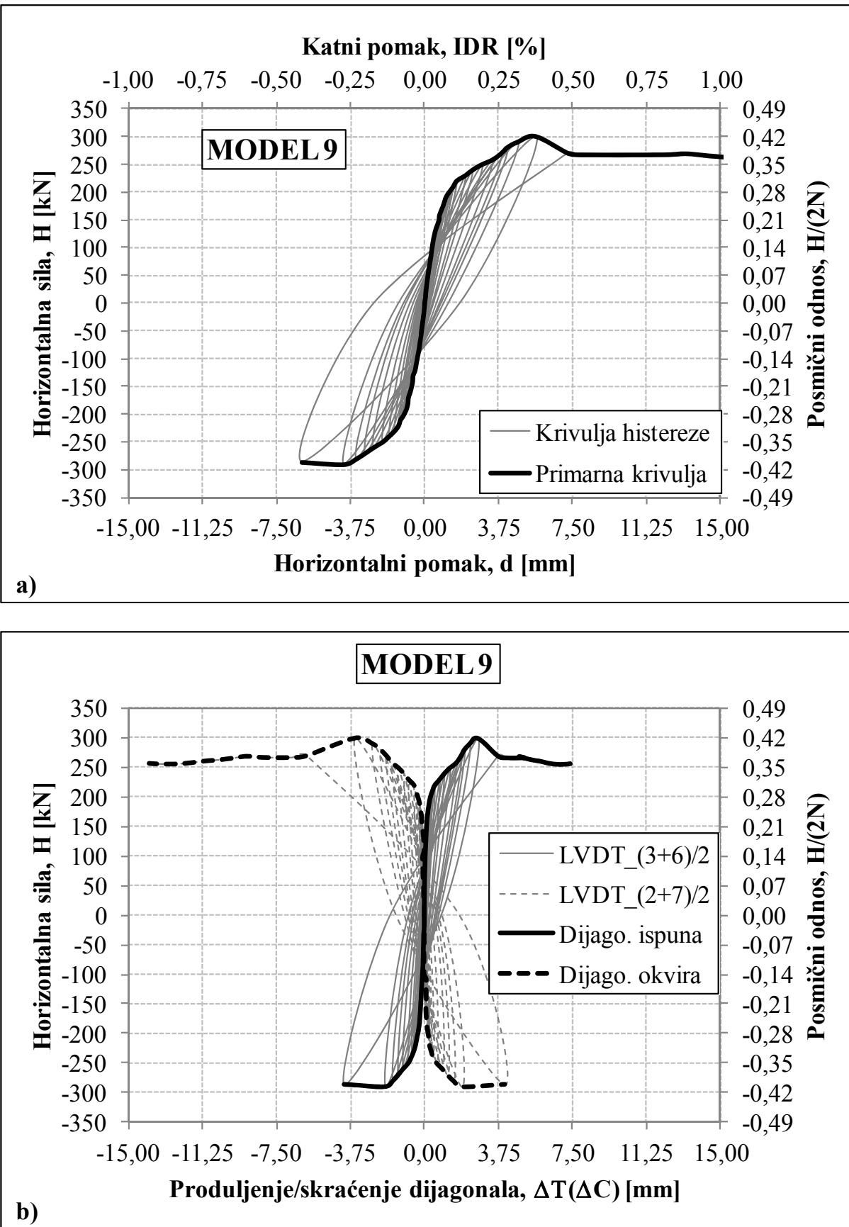
Slika 4.45 a) Krivulja horizontalna sila – pomak armirano-betonskog okvira sa zidnim ispunom za MODEL 9,
