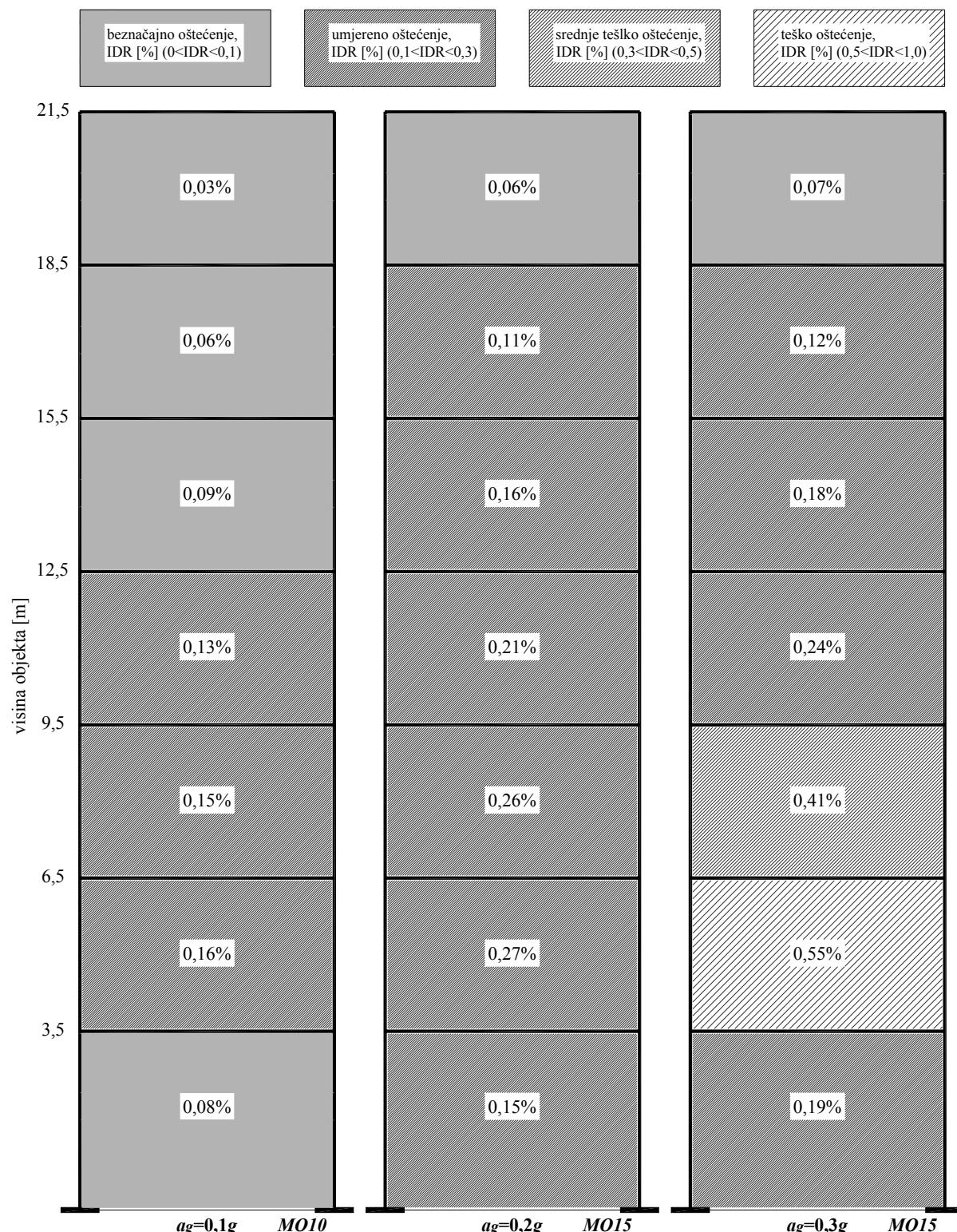
Slika 9.93 Oštećenje zidnog ispuna za različita proračunska ubrzanja na temeljnju tlu za numeričke modele - 7. katova
