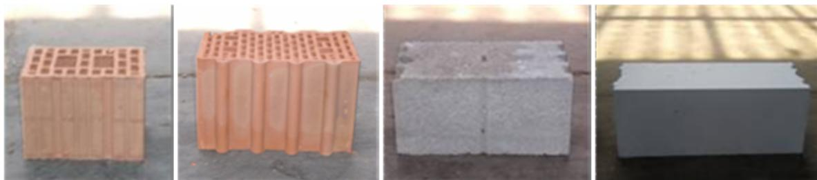
**Slika 3.1** Blok opeka, euroterm, betonski blok i ytong
