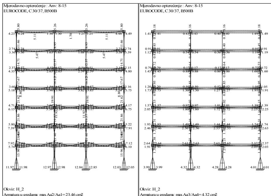
**Slika 2.16** Uzdužna armatura u elementima karakterističnog okvira (H\_2)
