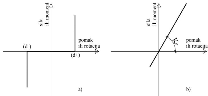
Slika 6.19 Gap element, a) gap krivulja, b) linearna krivulja
