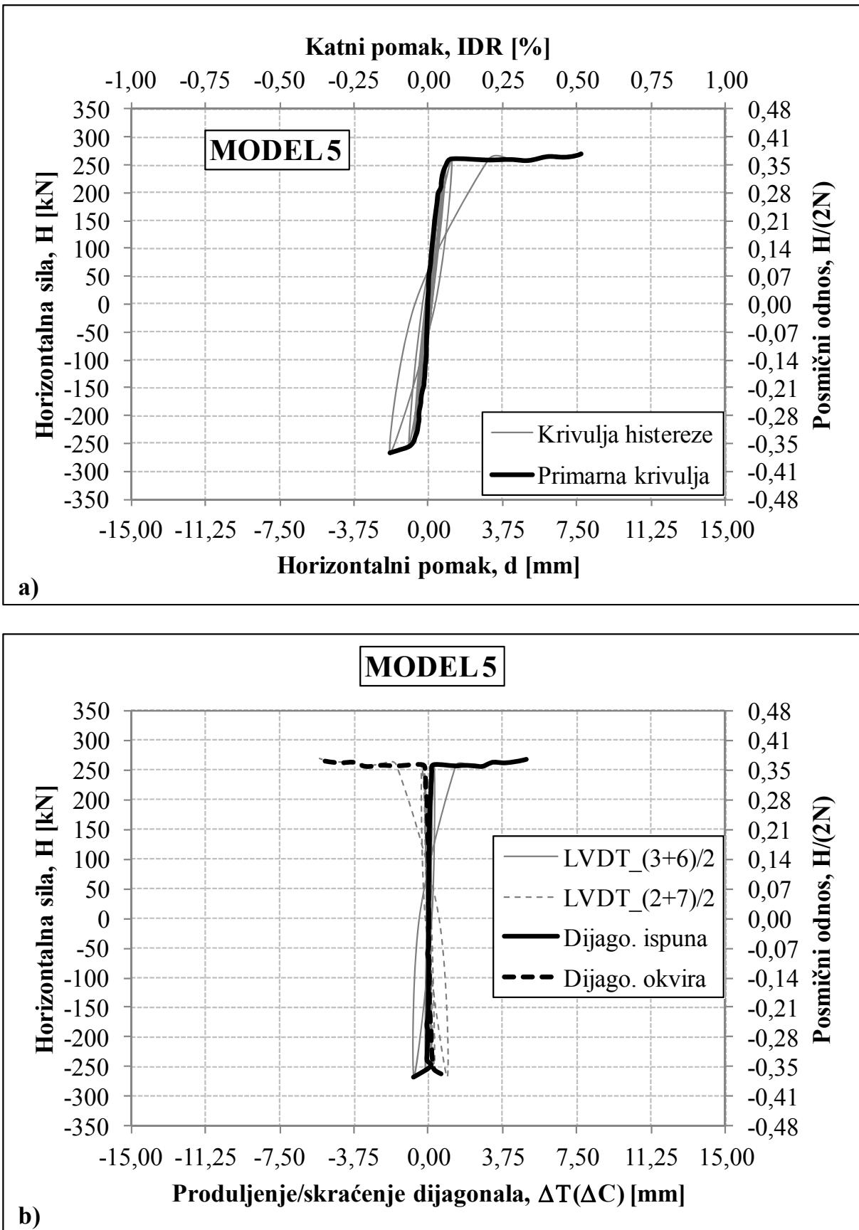
Slika 4.47 a) Krivulja horizontalna sila – pomak armirano-betonskog okvira sa zidnim ispunom za MODEL 5,
