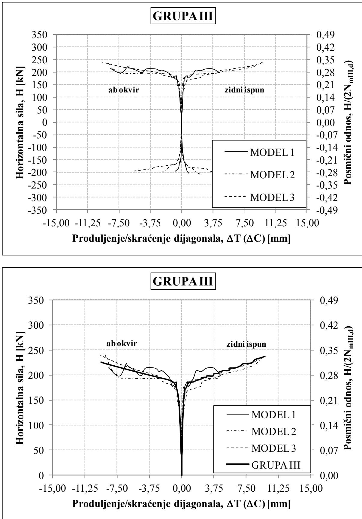
**Slika 4.59** Krivulje deformacija dijagonala modela GRUPE III i optimalizirane krivulje deformacija dijagonala modela GRUPE III
