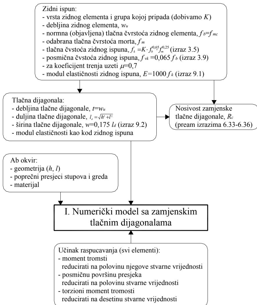
**Slika 9.1 b)** Dijagram tijeka numeričkoga modela sa zamjenskim tlačnim dijagonalama
