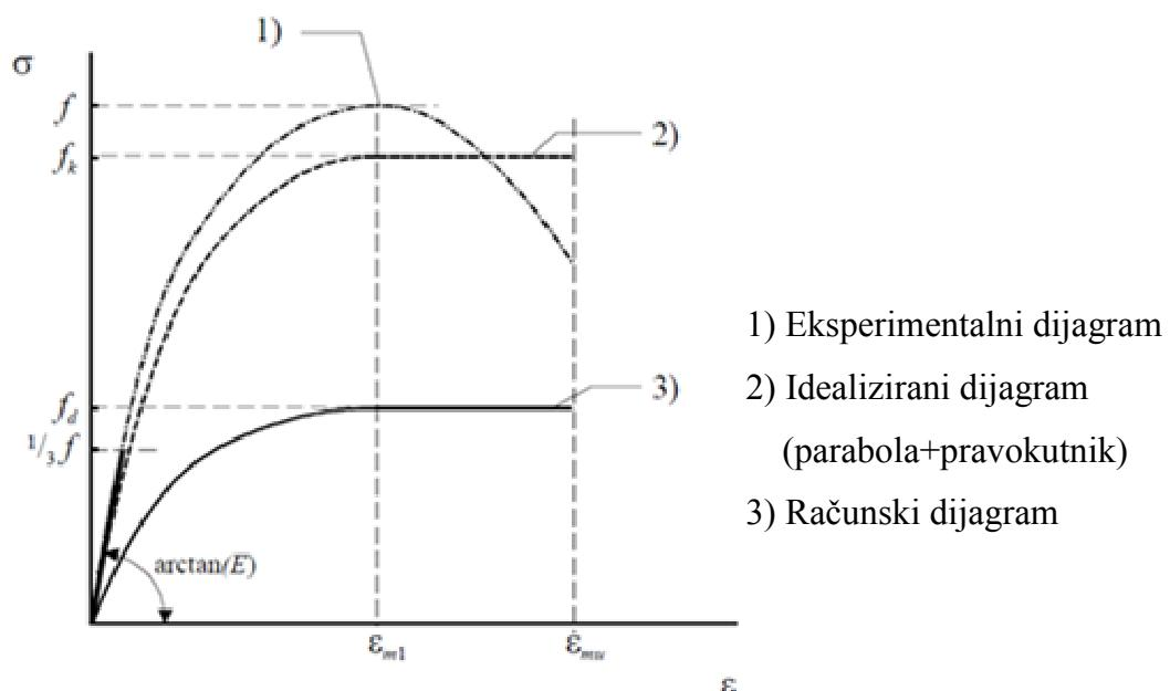
Slika 3.6 Dijagram naprezanje – relativna deformacija za tlačno opterećen zidni ispun
