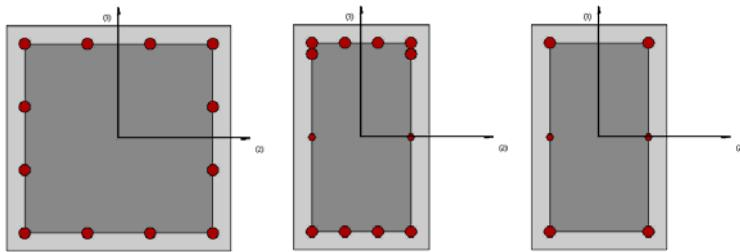
Slika 6.11 Prikaz karakterističnih poprečnih presjeka stup-a i grede na ležaju i u polju
