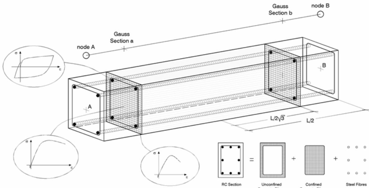
**Slika 6.8** Podjela poprečnog presjeka na vlakna s definiranjem jednoosnog ponašanja materijala
