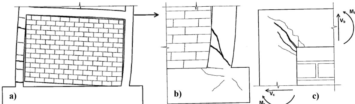
**Slika 4.32** Mehanizmi sloma armirano-betonskog okvira; a) vlačni slom, b) posmični slom, c) slom u spoju elemenata armirano-betonskog okvira
