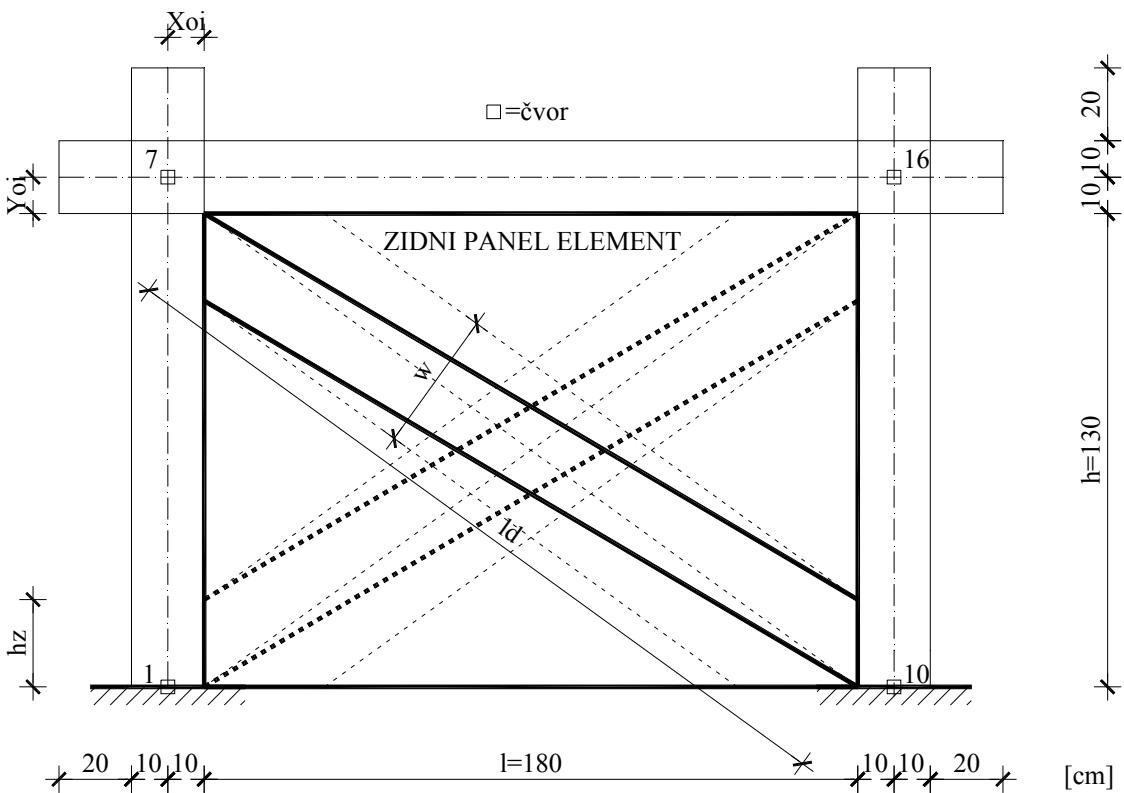
Slika 6.18 Prikaz i dimenzije zidnog ispuna - panel elemenata
