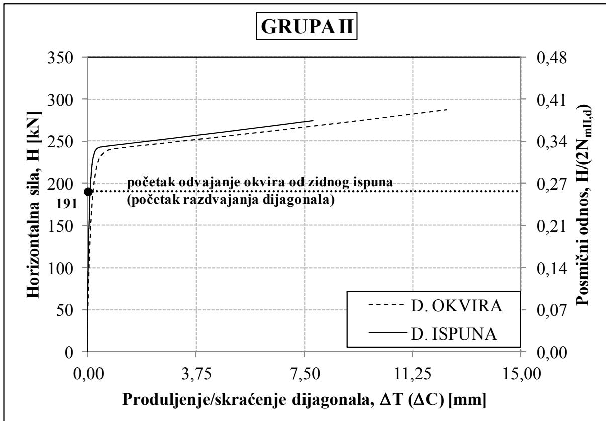
Slika 4.62 Optimalizirane krivulje deformacija dijagonala modela GRUPE II, preklopljene
