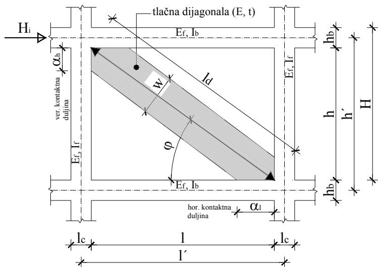
Slika 6.2 Model ekvivalentne tlačne dijagonale
