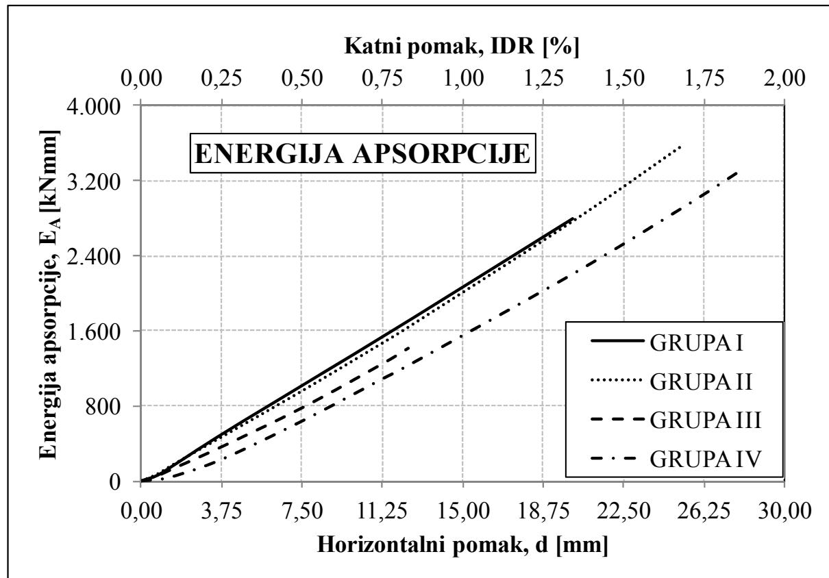
**Slika 4.80** Količine apsorbirane energije pojedinih GRUPA modela
