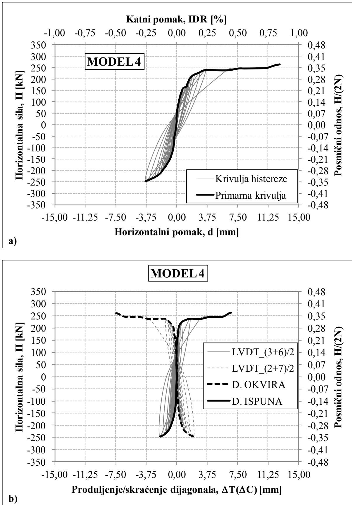
Slika 4.46 a) Krivulja horizontalna sila – pomak armirano-betonskog okvira sa zidnim ispunom za MODEL 4,
