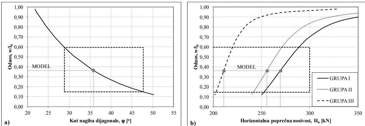
**Slika 5.7** a) Ovisnost širine i duljine tlačne dijagonale o kutu nagiba tlačne dijagonale,
