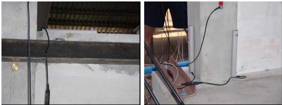
**Slika 4.16** Prikaz deformetara za mjerjenje deformacija na gredi i stupovima
