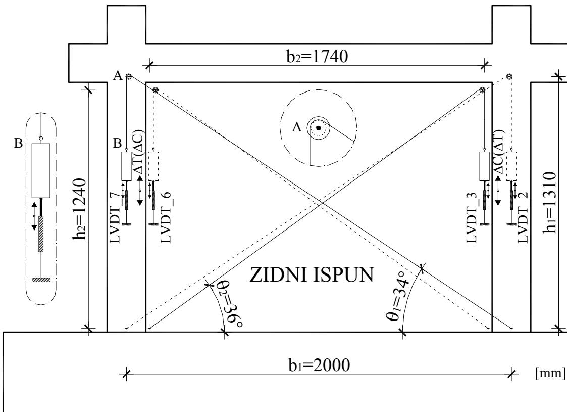
**Slika 4.67** Deformacije dijagonala i izračun relativni posmičnih deformacija
