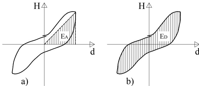
**Slika 4.79** Izračun apsorbirane i disispirane energije,
