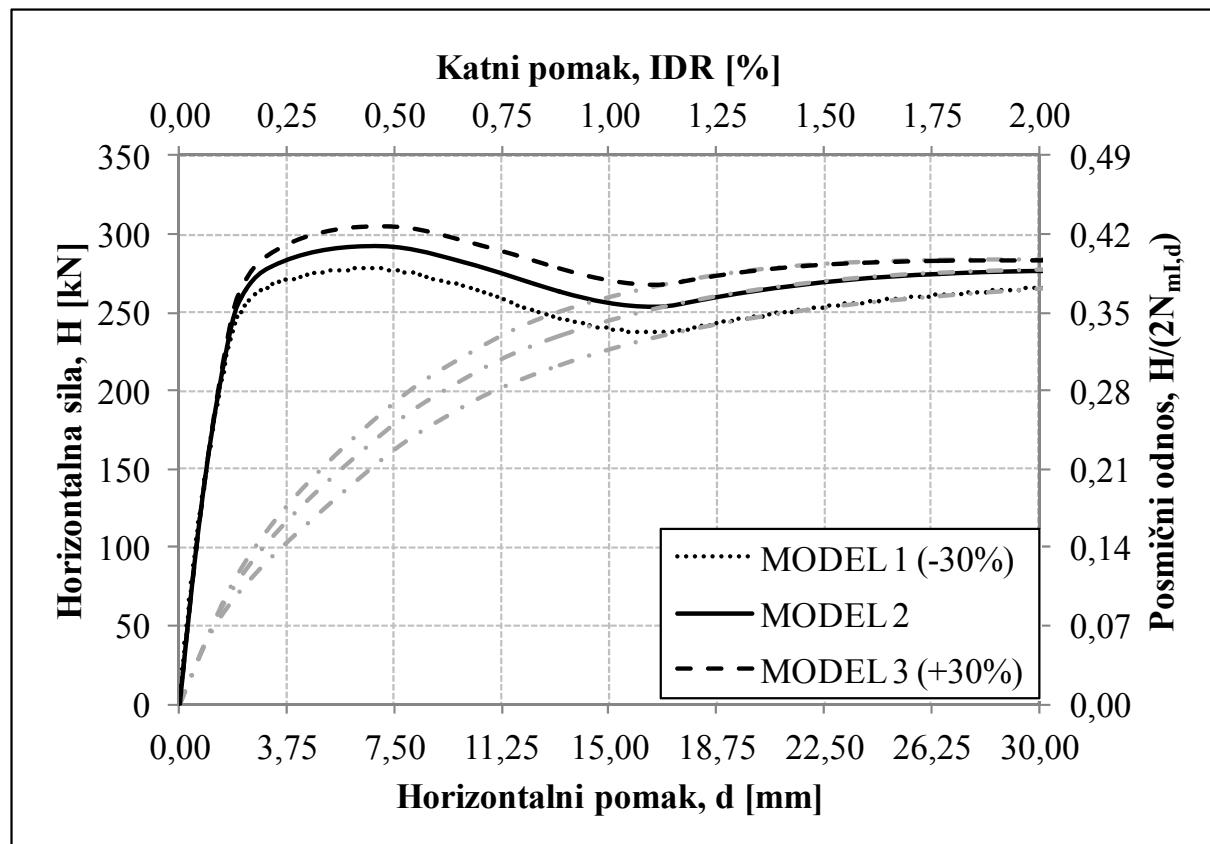
**Slika 8.12** Utjecaj vertikalnog opterećenja na poprečnu nosivost
