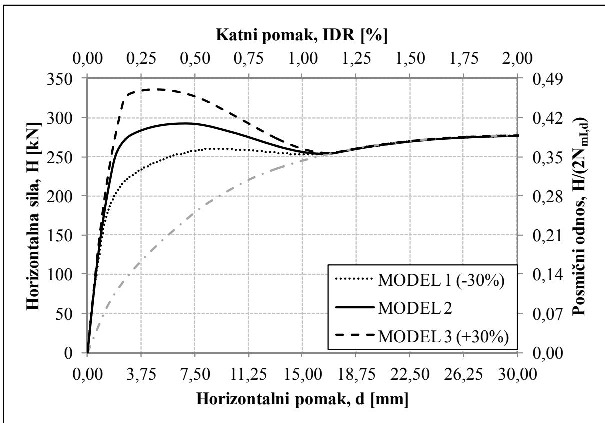
Slika 8.9 Utjecaj čvrstoće dijagonale na poprečnu nosivost
