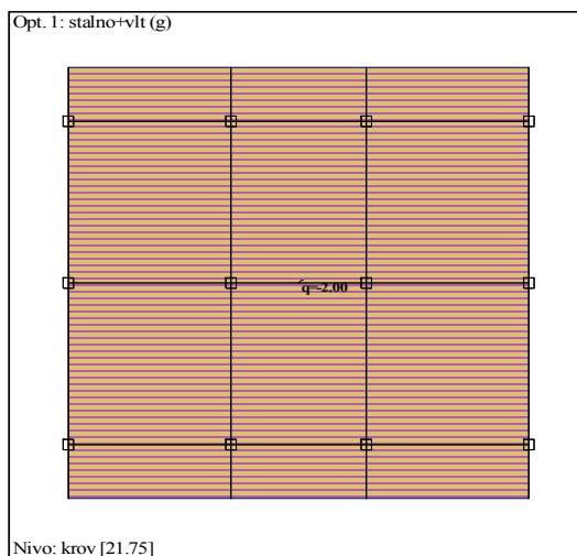
**Slika 2.8** Raspodjela stalnog opterećenja po krovnoj ploči
