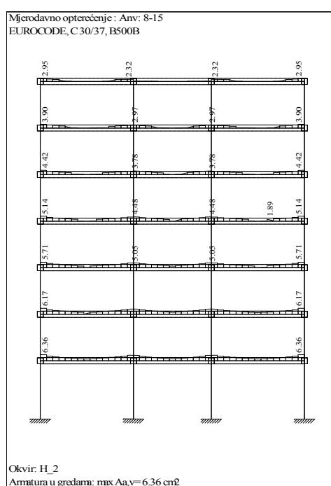
**Slika 2.17** Poprečna armatura u elementima karakterističnog okvira (H\_2)
