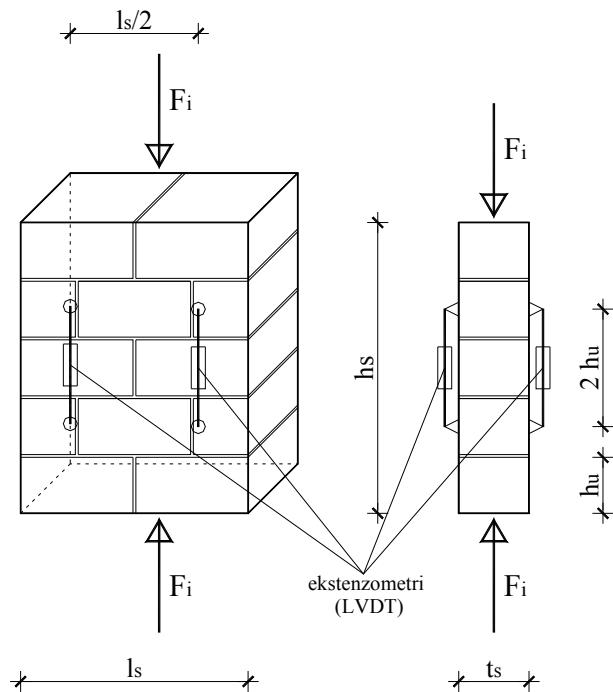
Slika 3.5 Ispitivanje tlačne čvrstoće i modula elastičnosti
