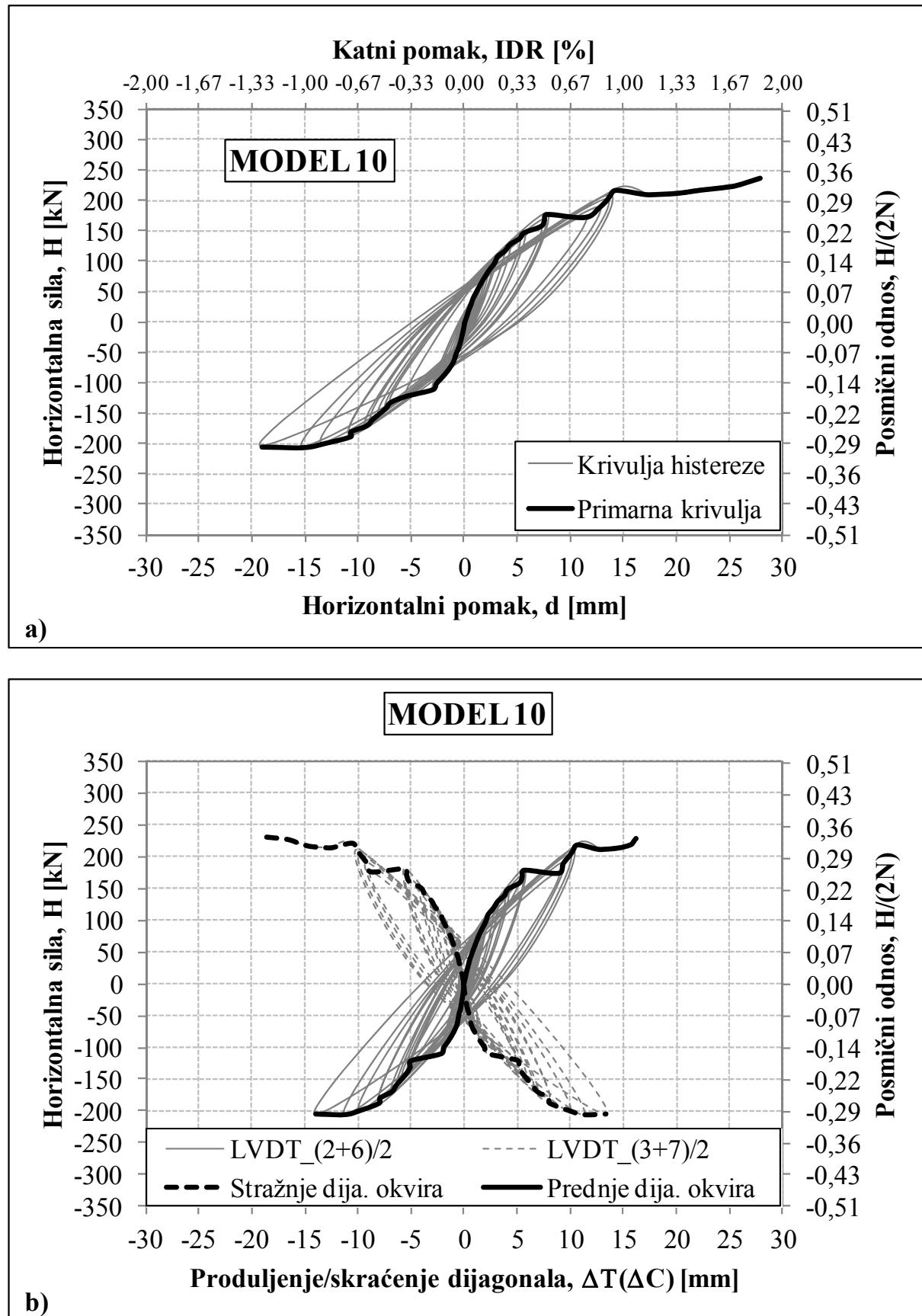
**Slika 4.52 a)** Krivulja horizontalna sila – pomak praznog armirano-betonskog okvira (MODEL 10),
