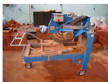
**Slika 4.7** Stroj za rezanje zidnih elemenata
