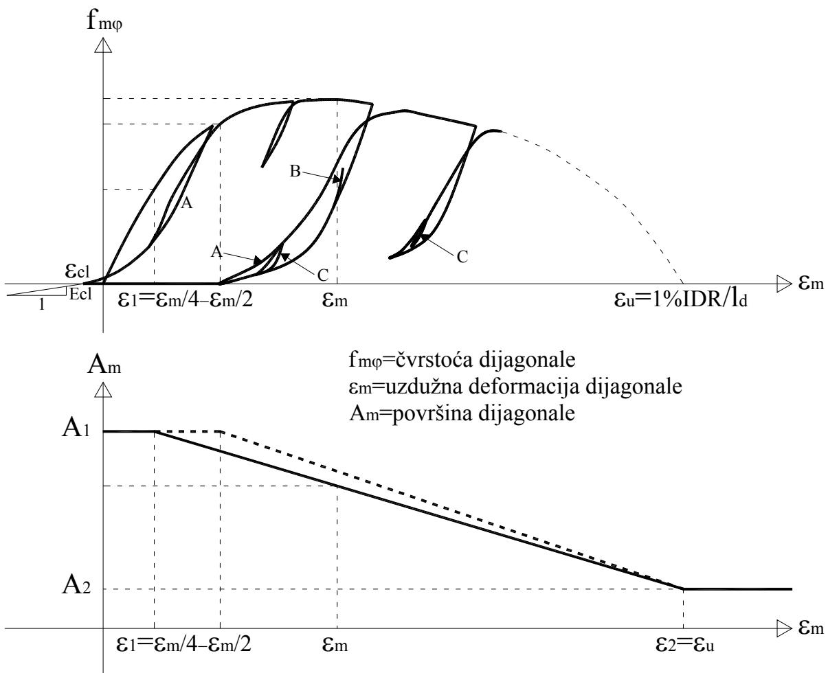
**Slika 6.14** Model histerezognog ponašanja dijagonale zidnog ispuna na tlak i smanjenje površine ekvivalentne tlačne dijagonale uslijed pukotina
