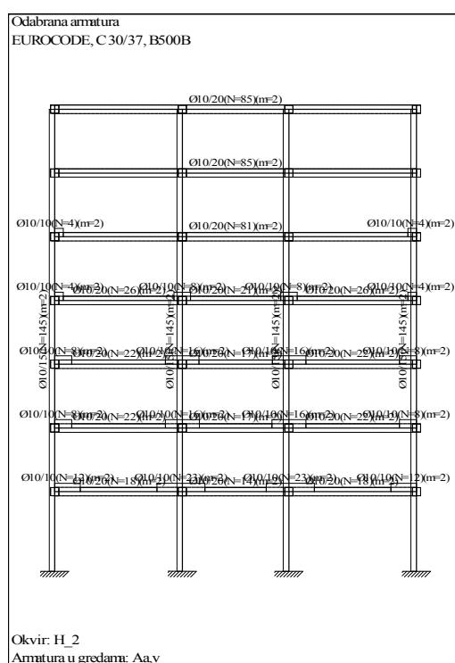
**Slika 2.19** Odabrana poprečna armatura u elementima karakterističnog okvira (H\_2)
