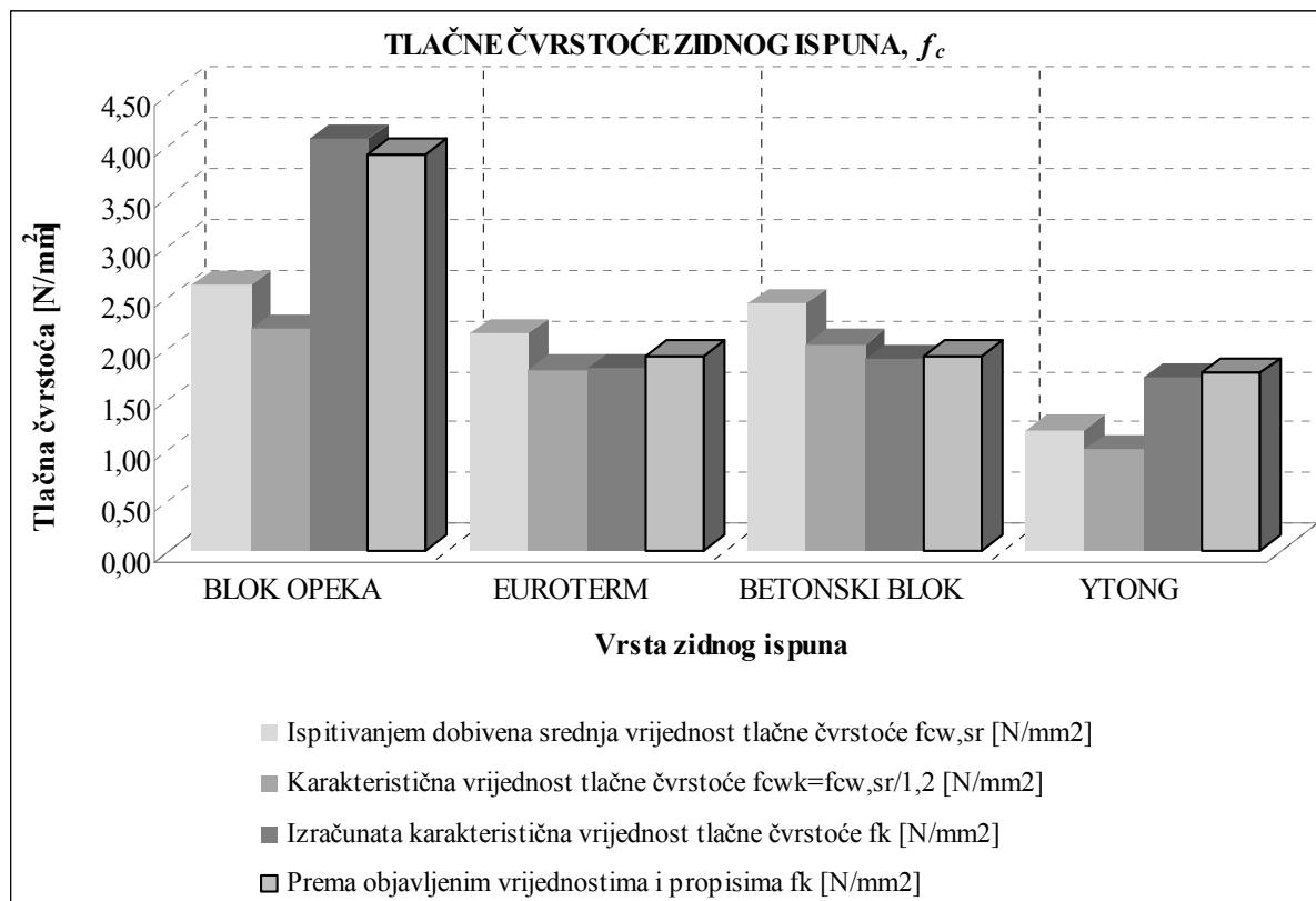
**Slika 3.22** Grafički prikaz usporedbi tlačnih čvrstoća zidnog ispuna od različitih zidnih elemenata
