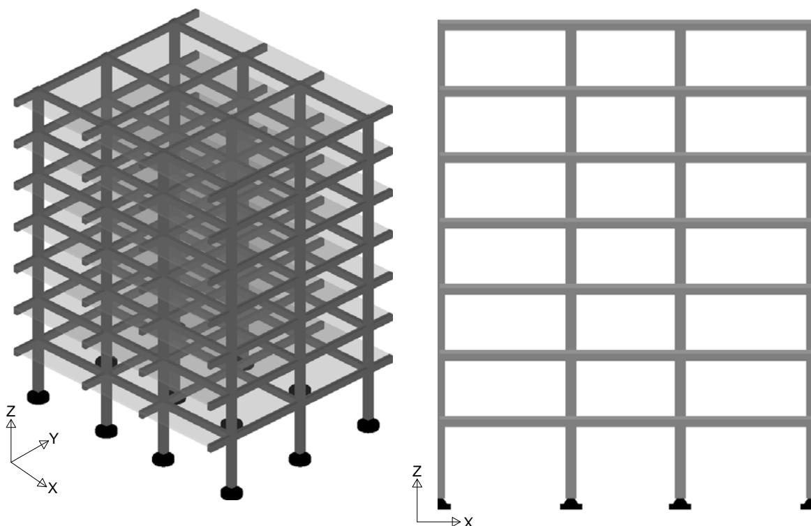
**Slika 2.2** Prostorni proračunski model prototipa i karakteristični okvir
