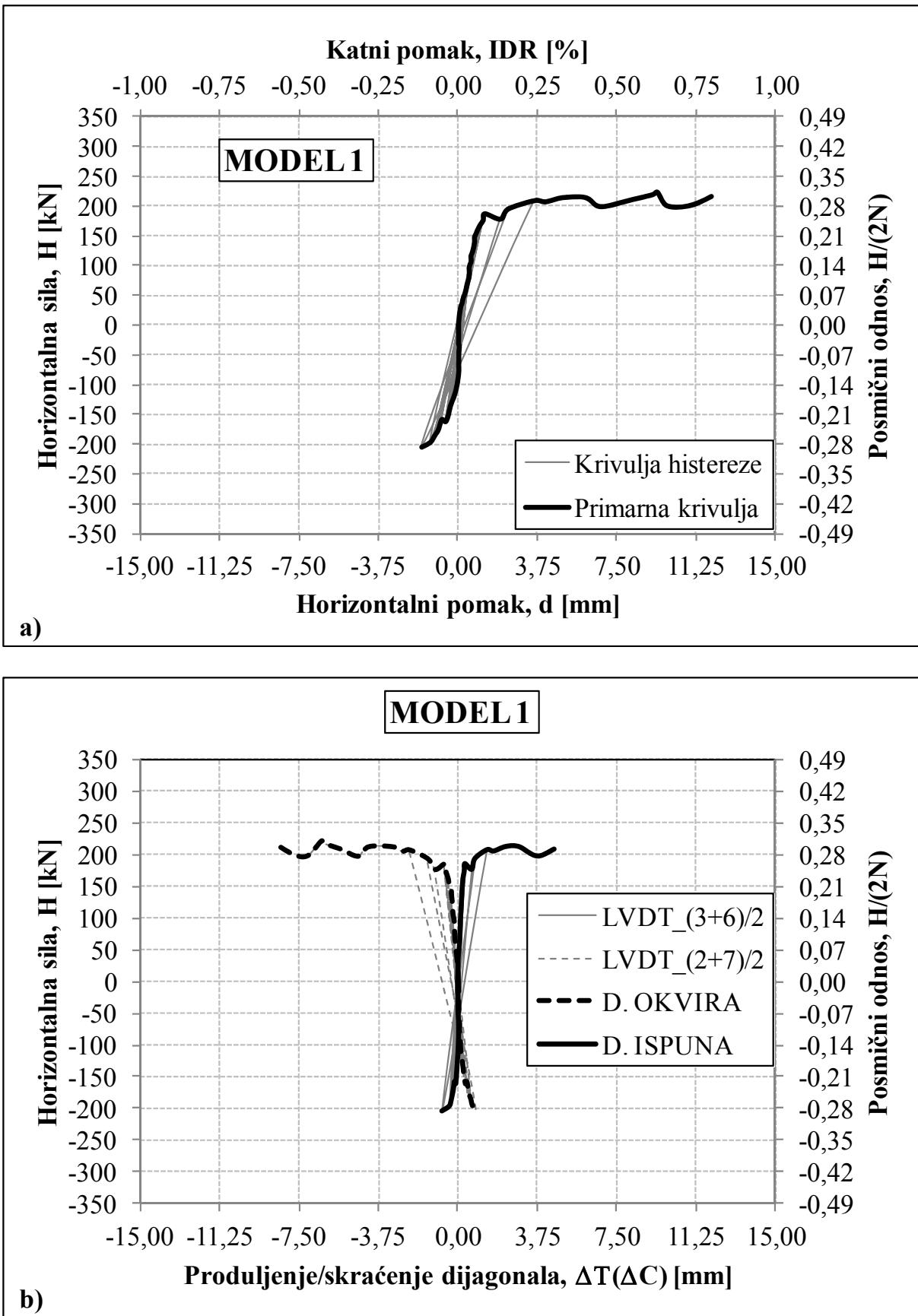
Slika 4.49 a) Krivulja horizontalna sila – pomak armirano-betonskog okvira sa zidnim ispunom za MODEL 1,
