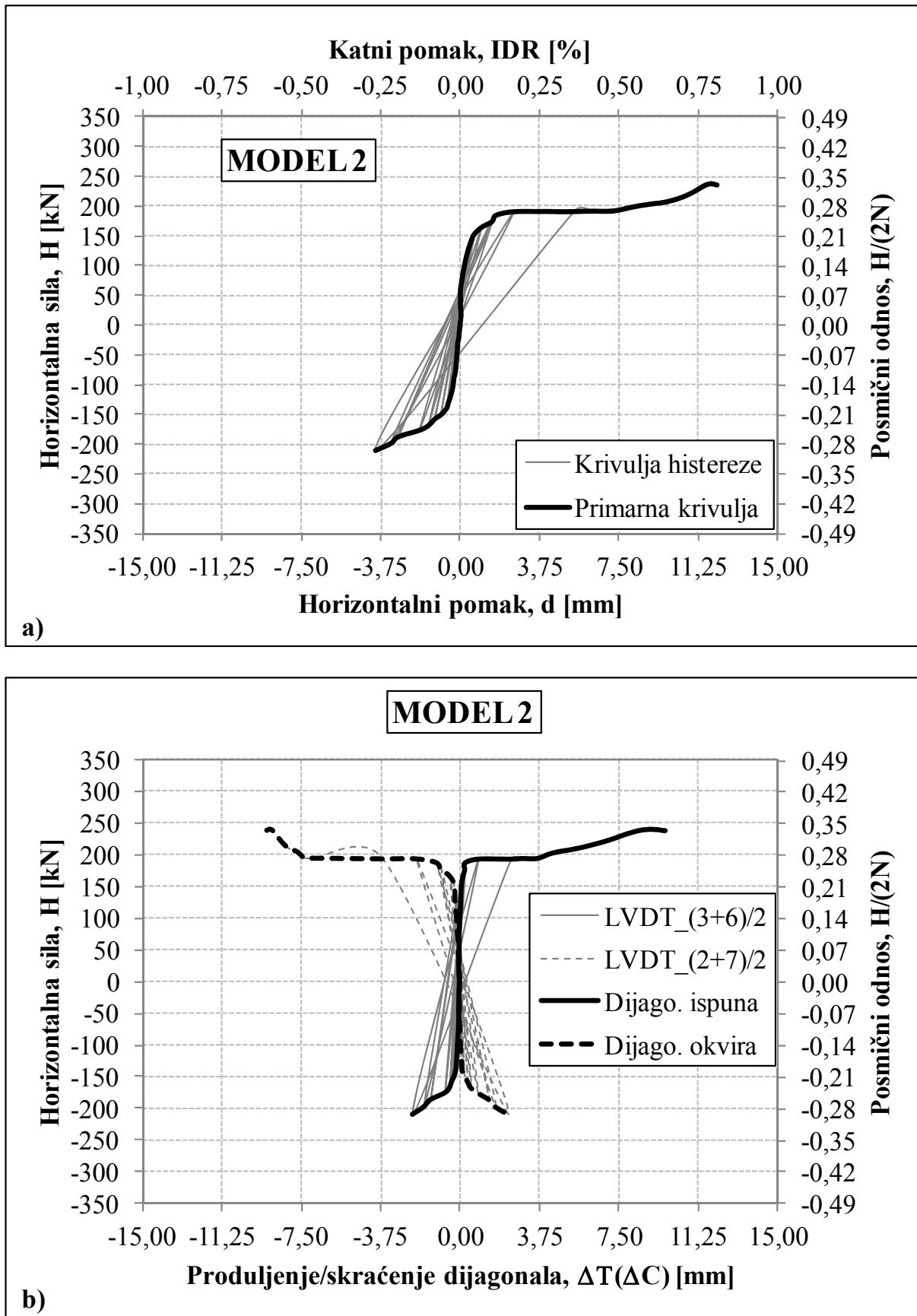
Slika 4.50 a) Krivulja horizontalna sila – pomak armirano-betonskog okvira sa zidnim ispunom za MODEL 2,
