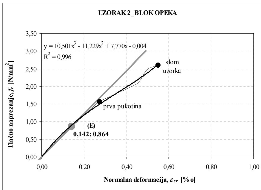
Slika 3.11 Odnos naprezanja i deformacije za UZORAK 2 zidnog ispuna od blok opeke
