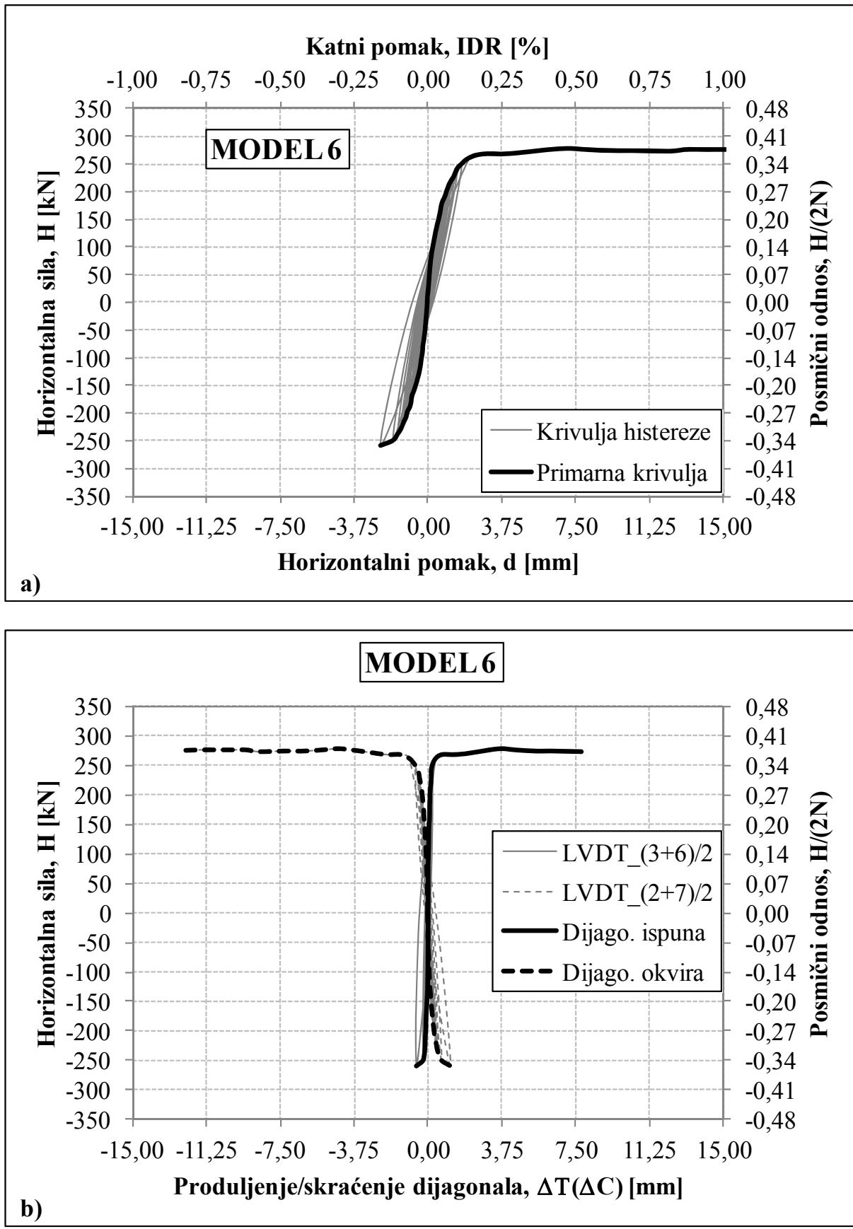
Slika 4.48 a) Krivulja horizontalna sila – pomak armirano-betonskog okvira sa zidnim ispunom za MODEL 6,
