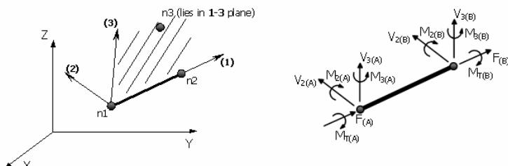
**Slika 6.12** Štapni elementi s označama lokalnih osi i unutarnjih sila
