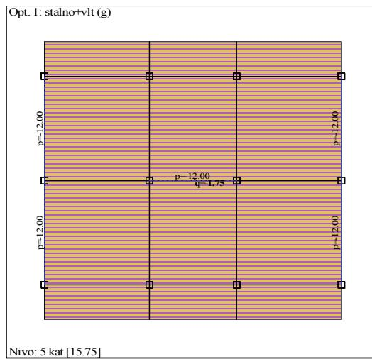
**Slika 2.10** Raspodjela stalnog opterećenja po stropnim pločama 1.-6. kata
