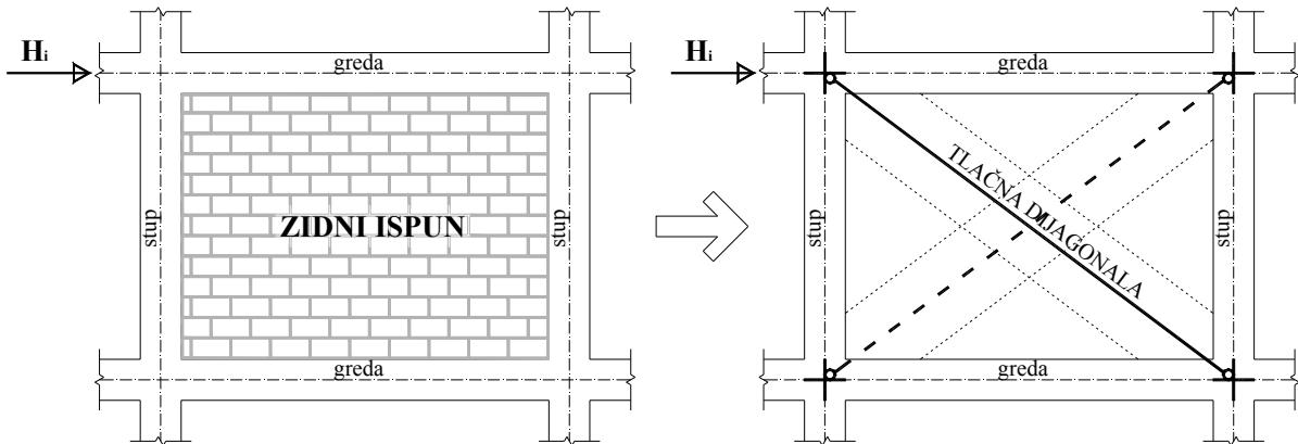
Slika 6.1 Makro-model zidnog ispuna kroz ekvivalentne tlačne dijagonale
