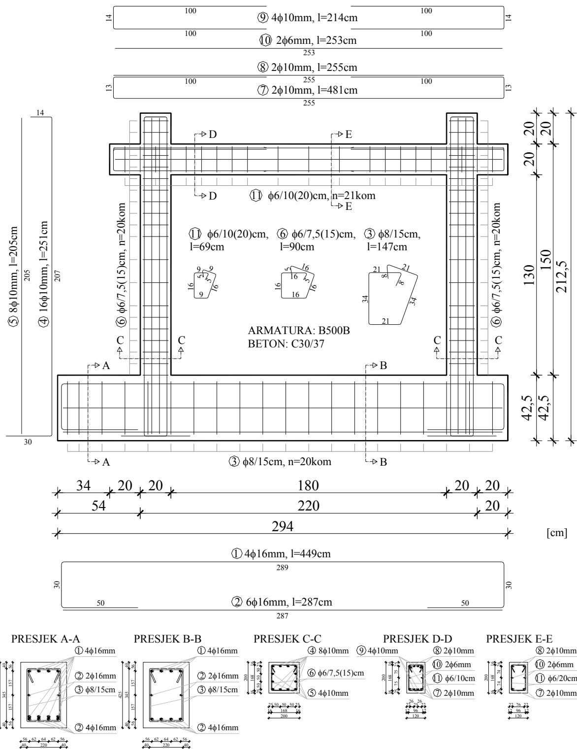
Slika 4.2 Prikaz dimenzija i nacrta armature armirano-betonskog okvira modela
