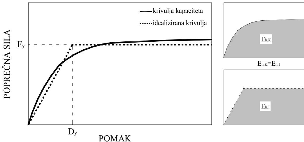
Slika 9.32 Idealizacija krivulje kapaciteta praznog armirano-betonskog okvira
