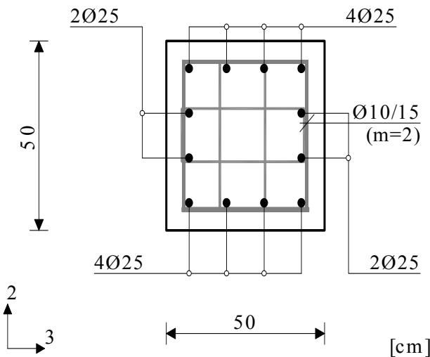
**Slika 2.20** Odabrana armatura u stupovima (PRESJEK 1-1 prema *slici 2.1*)
