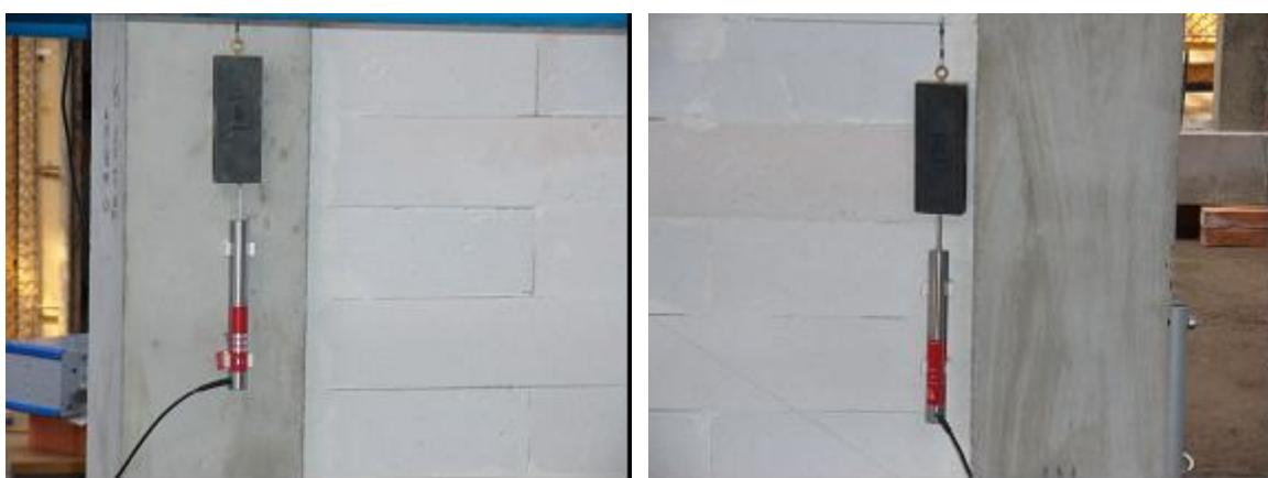
**Slika 4.15** Prikaz LVDT\_a za mjerjenje produljenja odnosno skraćenja dijagonala
