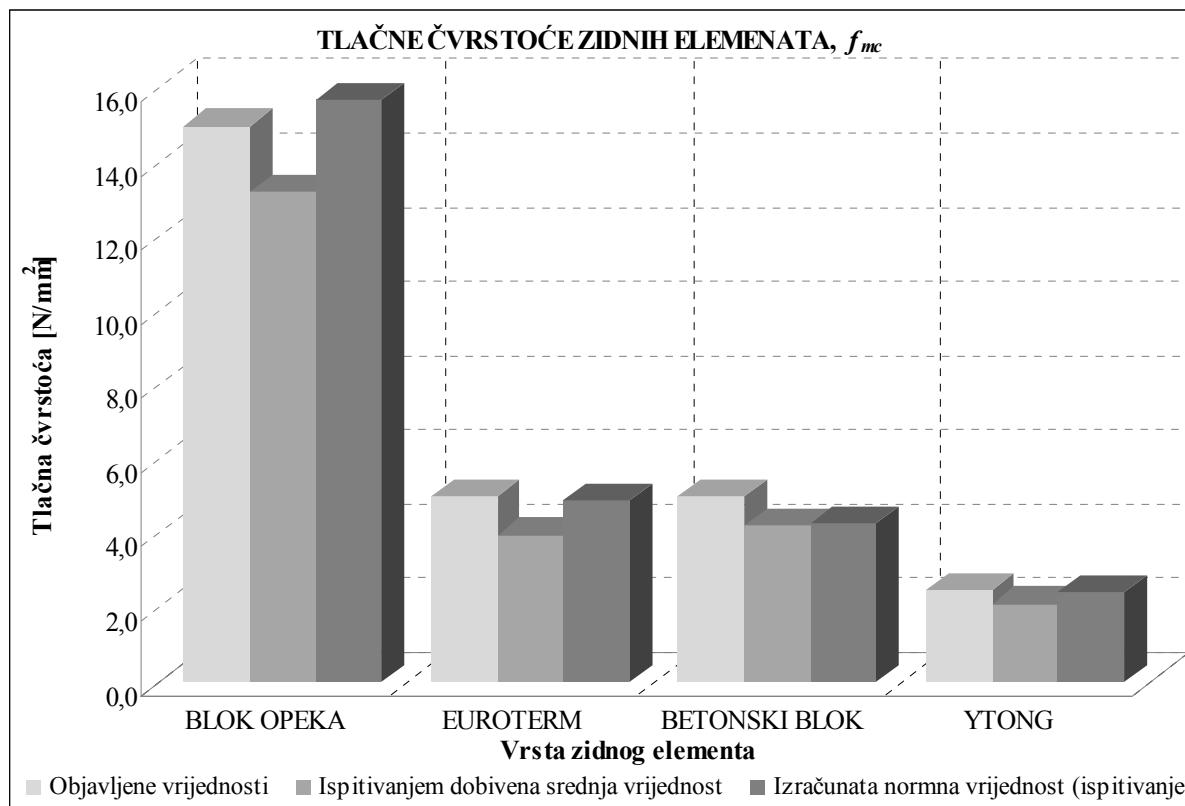
Slika 3.4 Grafički prikaz usporedbe tlačnih čvrstoća zidnih elemenata
