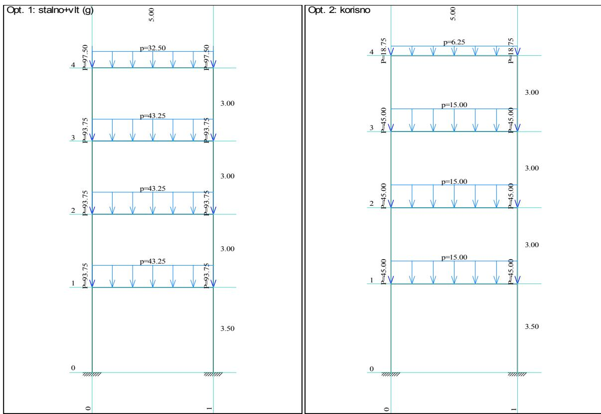
Slika 9.5 Raspodjela vertikalnog stalnog i korisnog opterećenja na modelu - 4. kata
