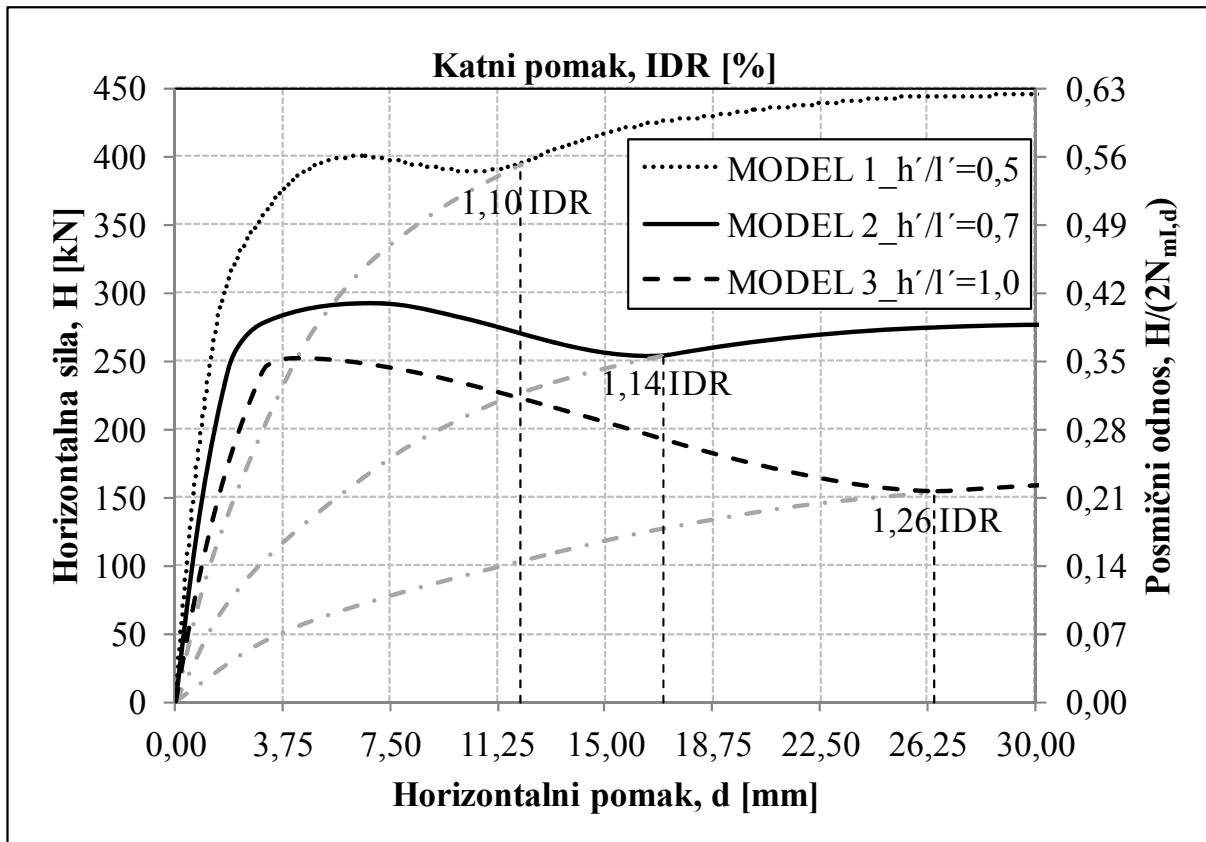
Slika 8.3 Utjecaj geometrije armirano-betonskog okvira na poprečnu nosivost
