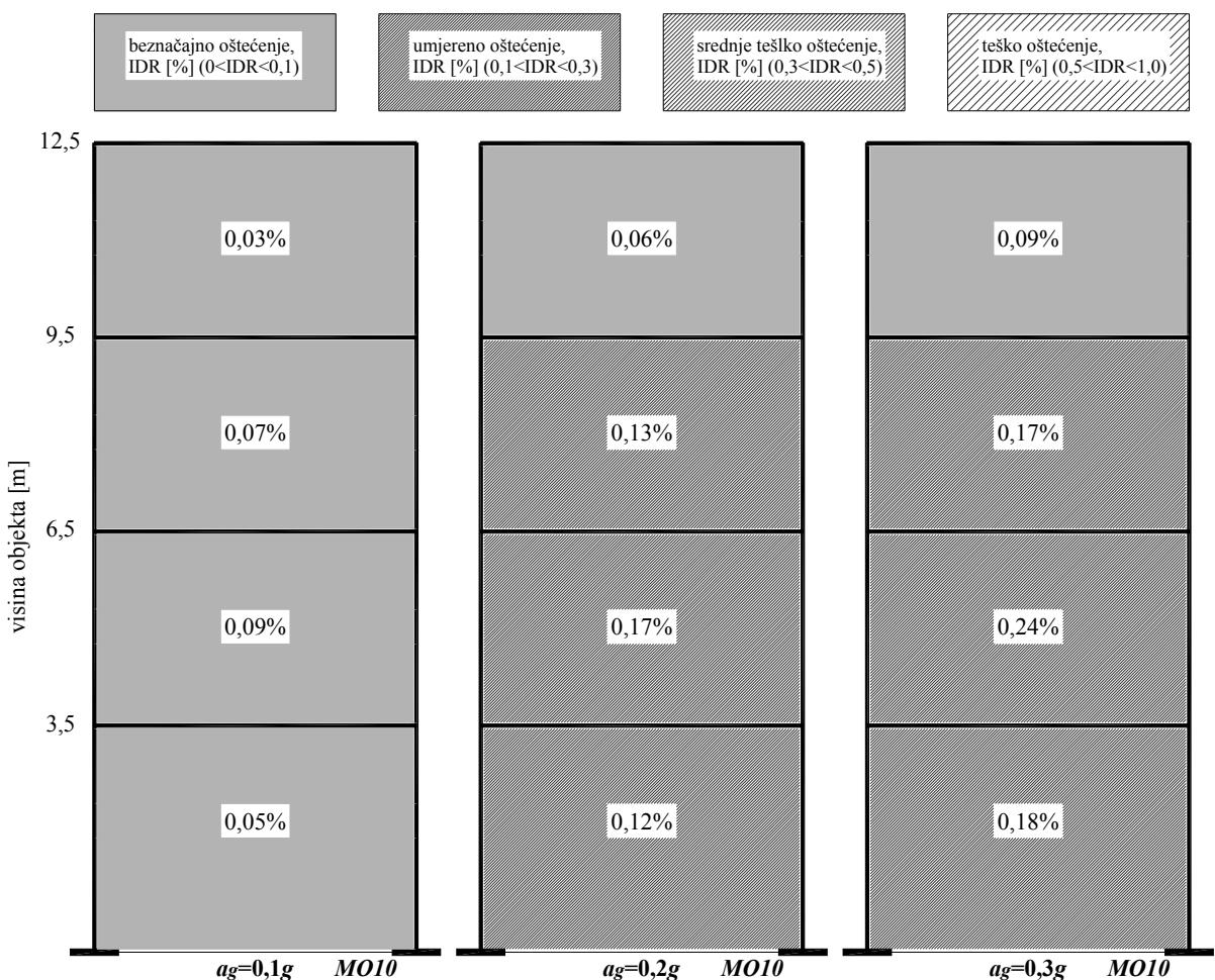
**Slika 9.92** Oštećenje zidnog ispuna za različita proračunska ubrzanja na temeljnem tlu za numeričke modele - 4. kata
