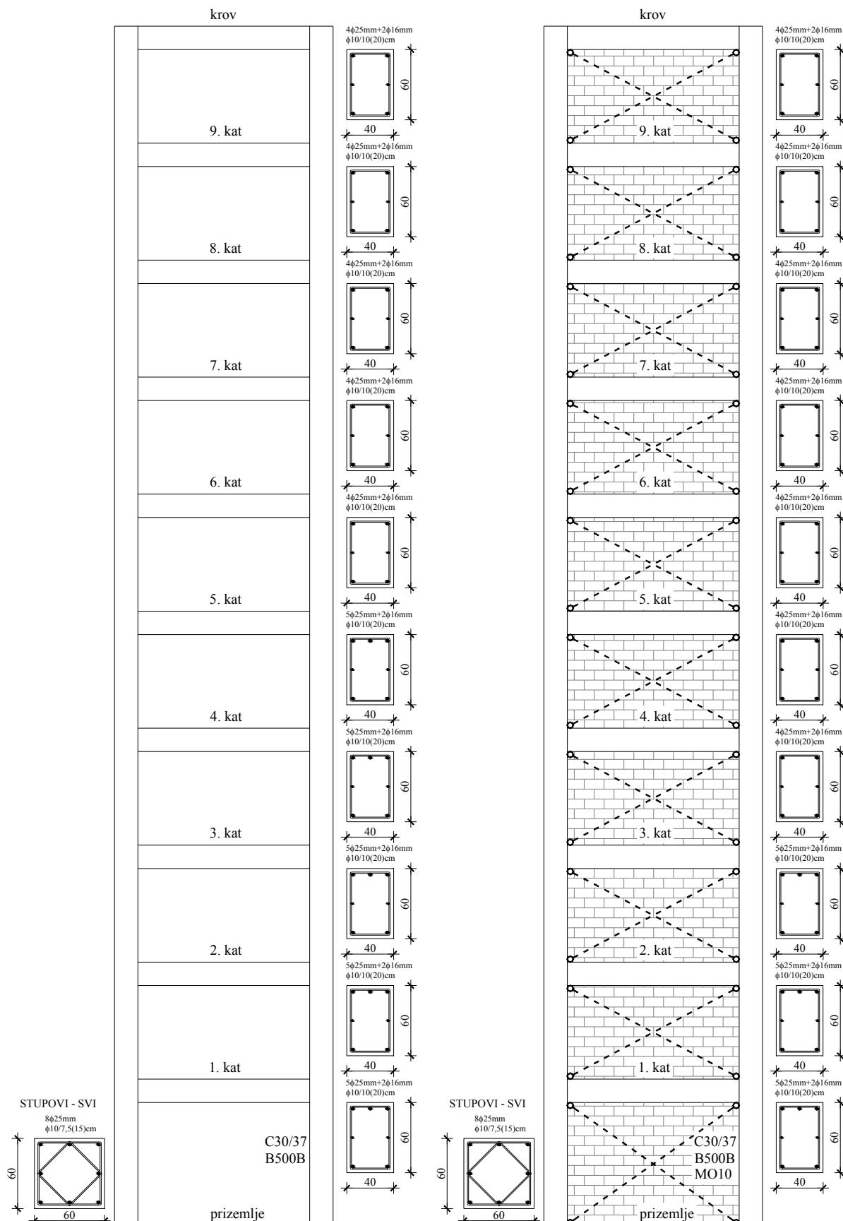
Slika 9.29 Odabrana armatura u elementima praznog armirano-betonskog okvira i armirano-betonskog okvira sa zidnim ispunom – 10. katova ( $a_g=0, l_g$ )
