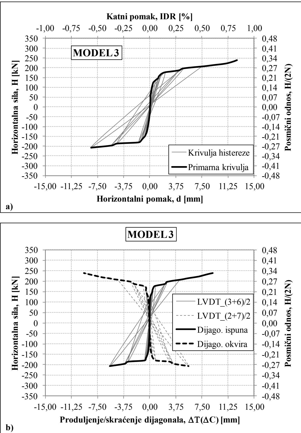
Slika 4.51 a) Krivulja horizontalna sila – pomak armirano-betonskog okvira sa zidnim ispunom za MODEL 3,
