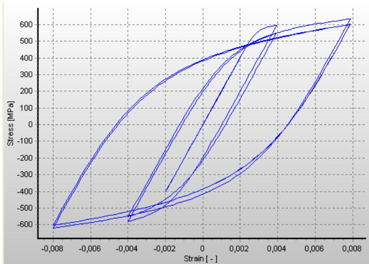
**Slika 6.10** Prikaz odnosa naprezanje-deformacija za model čelika prema Menegotto-Pinto
