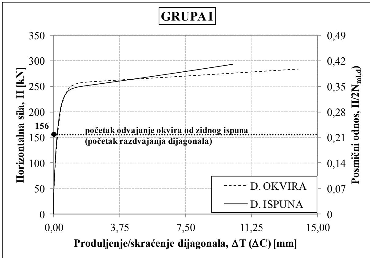
Slika 4.61 Optimalizirane krivulje deformacija dijagonala modela GRUPE I, preklopljene
