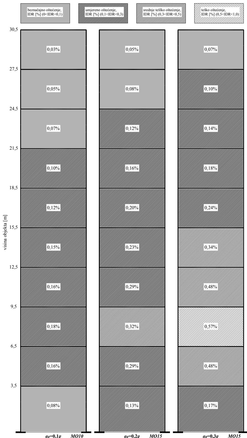
**Slika 9.94** Oštećenje zidnog ispuna za različita proračunska ubrzanja na temeljnem tlu za numeričke modele - 10. katova
