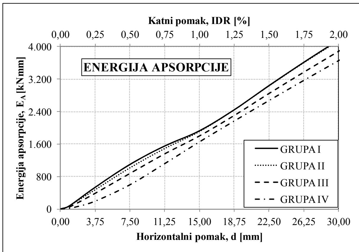
Slika 6.33 Količine apsorbirane energije pojedinih GRUPA modela
