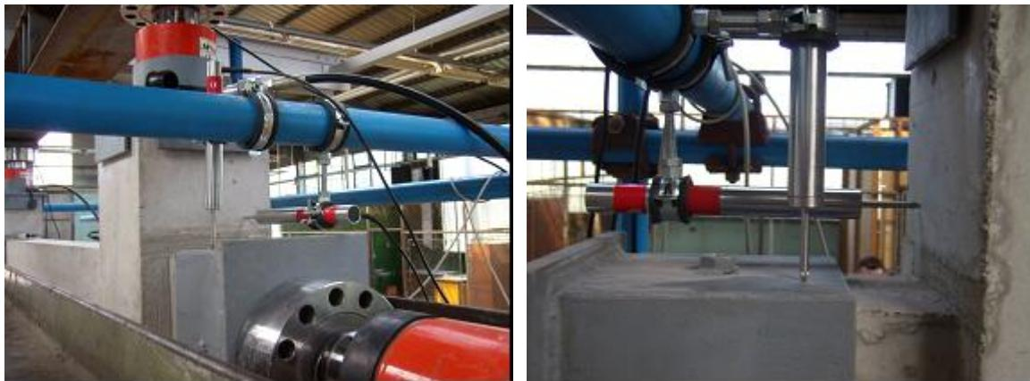
**Slika 4.14** Prikaz horizontalnih i vertikalnih LVDT\_a za mjerjenje pomaka
