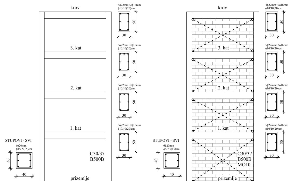
**Slika 9.23** Odabrana armatura u elementima praznog armirano-betonskog okvira i armirano-betonskog okvira sa zidnim ispunom – 4. kata ( $a_g=0,1g$ )
