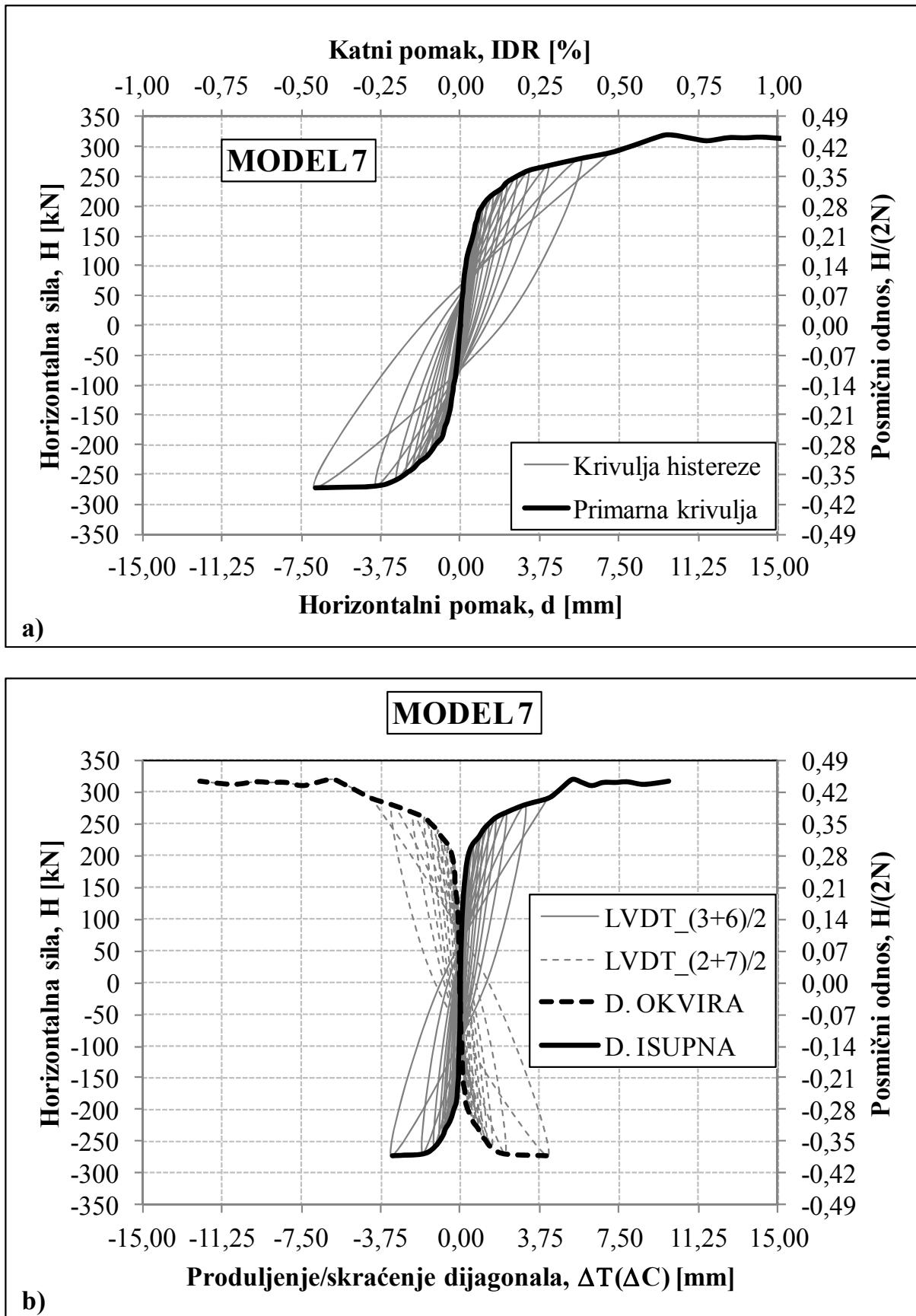
Slika 4.43 a) Krivulja horizontalna sila – pomak armirano-betonskog okvira sa zidnim ispunom za MODEL 7,
