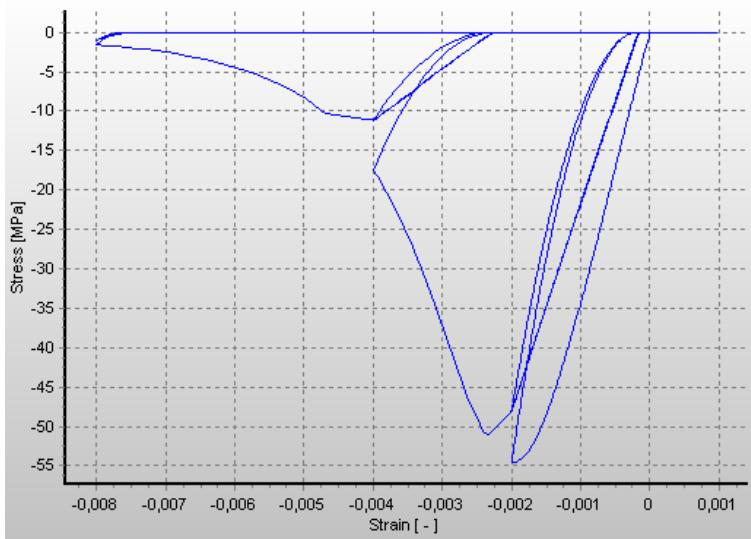
**Slika 6.9** Prikaz odnosa naprezanje-deformacija za model betona prema Manderu
