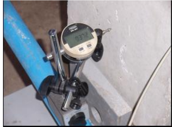
Slika 4.18 Prikaz mikroure za kontrolu klizanja na modelima (GRUPAMA)
