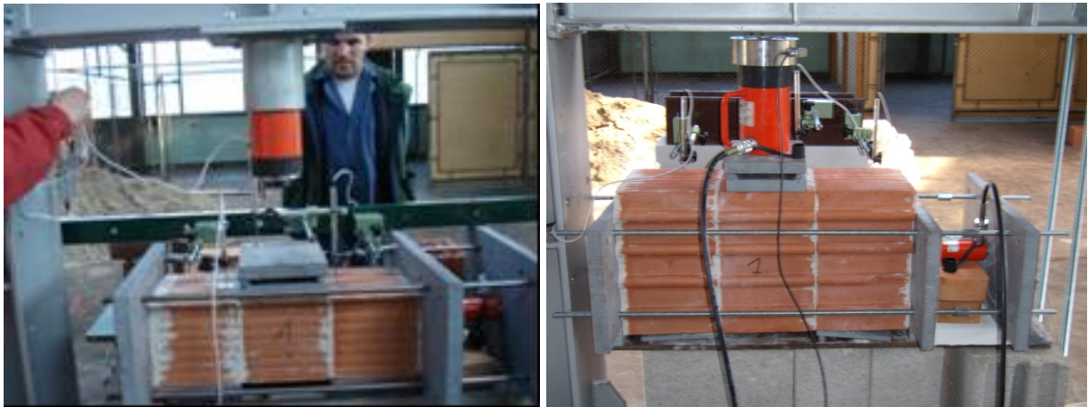
Slika 3.26 Ispitivanje posmične čvrstoće zidnog ispuna od blok opeke i euroterma
