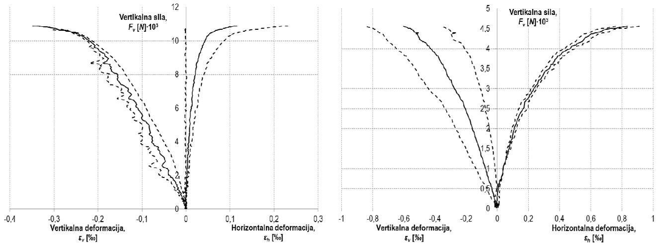
Slika 5.22 Ovisnost opterećenja i pripadnih deformacija dijagonala za cpm uzorke zidanog ispuna
