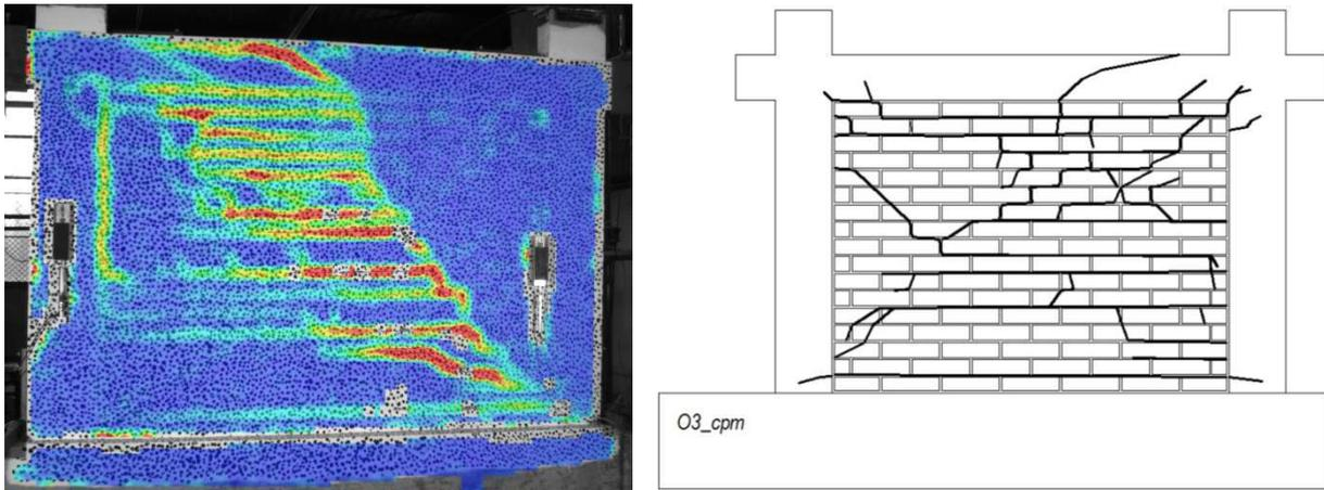
**Slika 6.107** Prikaz Oštećenja i pukotina ispitnog uzorka O3\_cpm
