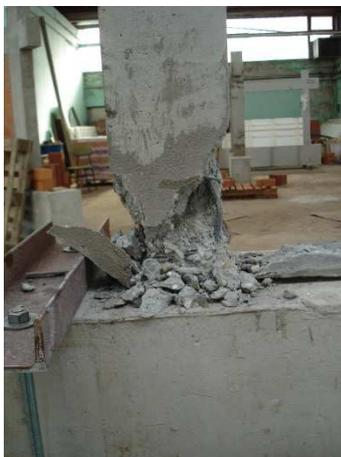
c) Oštećenje lijevog stupa ispitnog uzorka
