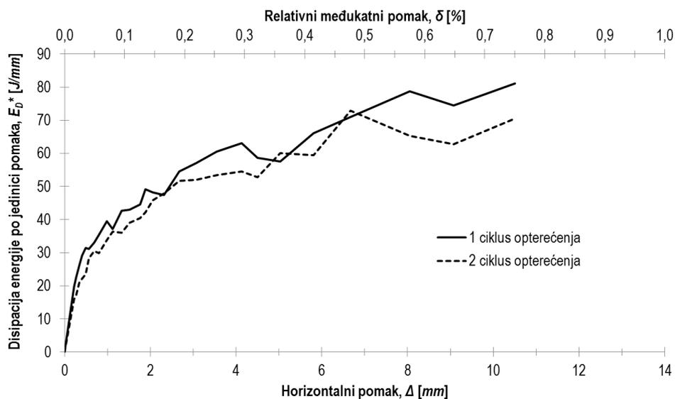
Slika 6.103 Disipacija energije po jedinici pomaka za O3\_cpm ispitni uzorak
