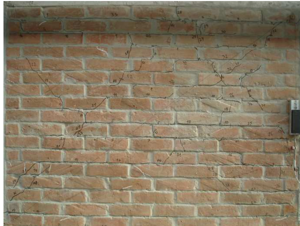
Slika 6.109 Prikaz dominantnog mehanizma sloma ispune (dijagonalni posmični slom) ispitnog uzorka O3_cpm
