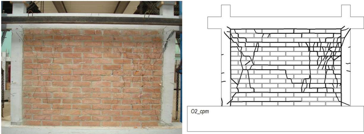
**Slika 6.78** Prikaz oštećenja i pukotina ispitnog uzorka O2\_cpm
