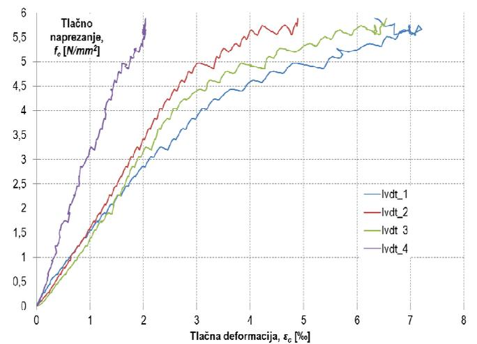
d) *cpm\_4*Slika 5.13 Odnos tlačno naprezanje-relativna deformacija za *cpm* uzorke zidanog ispuna
