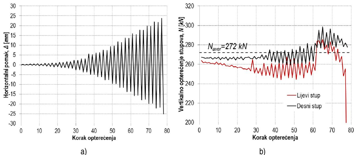
**Slika 6.80** Prikaz horizontalnog i vertikalnog opterećenja ispitnog uzorka O3
