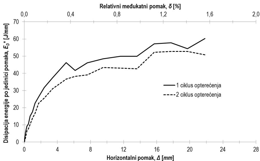
Slika 6.83 Disipacija energije po jedinici pomaka za ispitni uzorak O3
