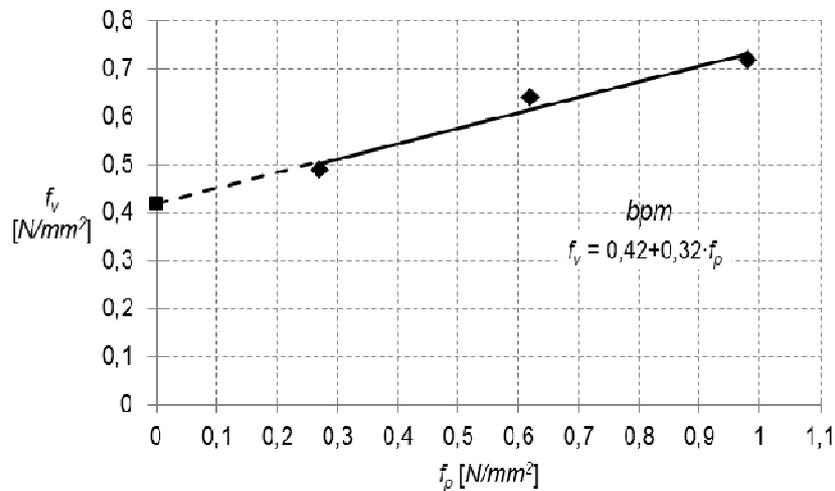
Slika 5.5 Prikaz rezultata ispitivanja posmične čvrstoće bpm uzoraka zidanog ispuna
