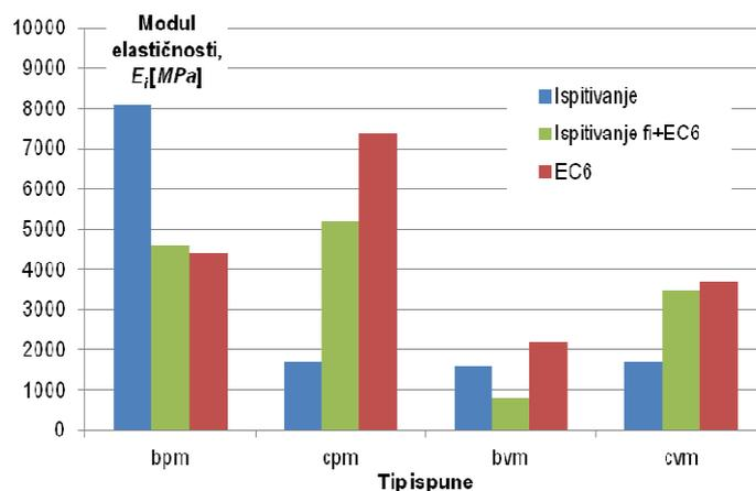
**Slika 5.26** Usporedba modula elastičnosti zidanog ispuna određenog ispitivanjem i preporukama danim u EC6
