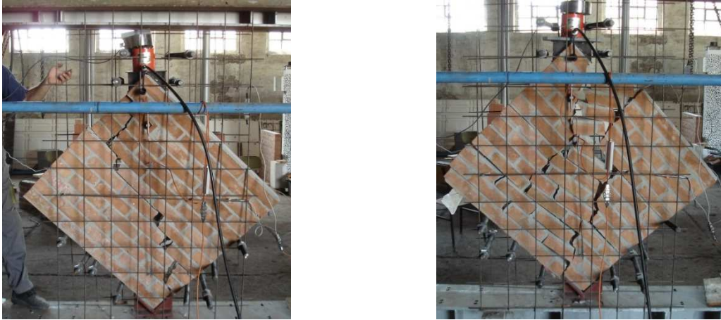
Slika 5.8 Slom cpm uzoraka zidanog ispuna pri dijagonalnom tlaku
