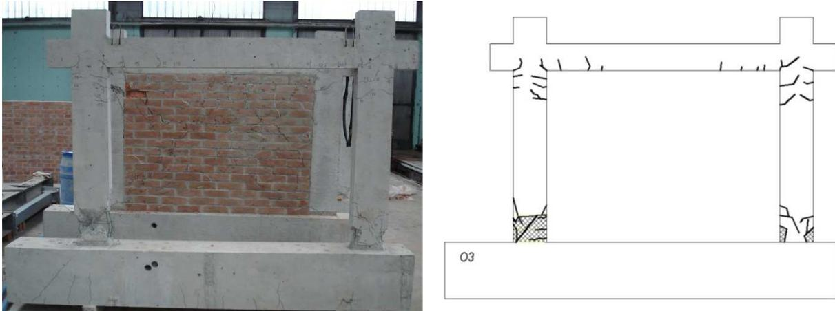
Slika 6.87 Prikaz oštećenja i pukotina ispitnog uzorka O3
