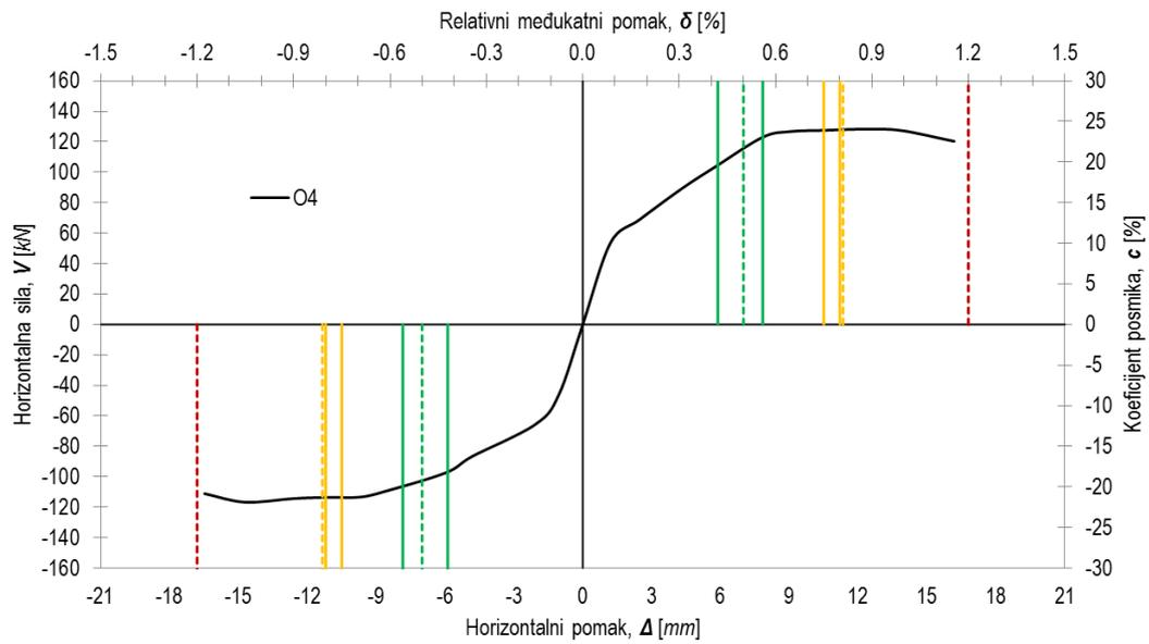
Slika 6.163 Shematski prikaz graničnih stanja uzoraka praznih okvira
