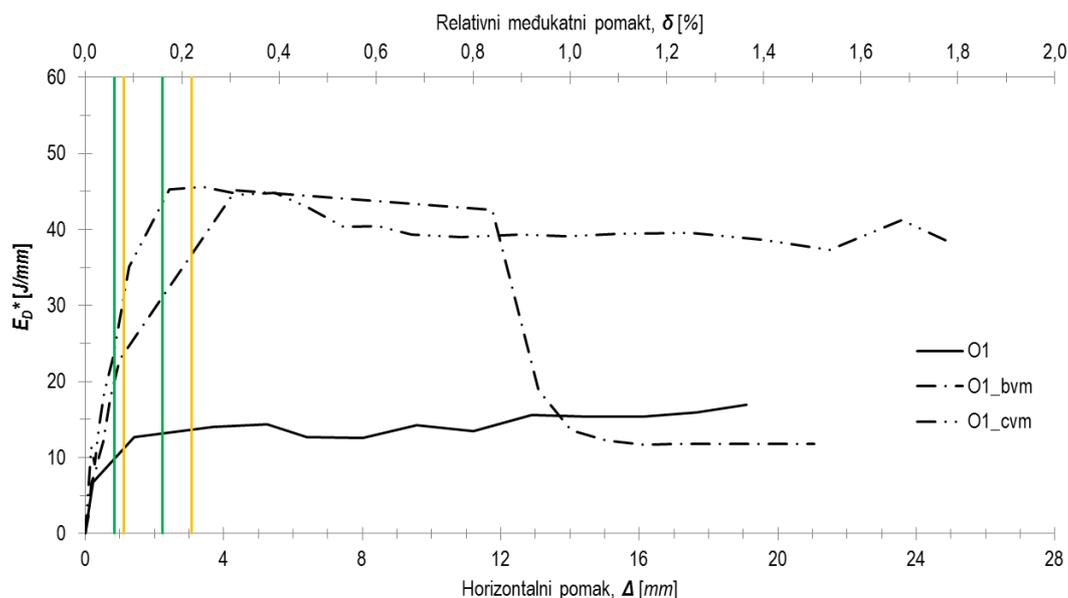
**Slika 6.144 b)** Prikaz disipacije energije po jedinici pomaka uzoraka skupine O1 kod kojih je ispun izvedena od vapnenog morta
