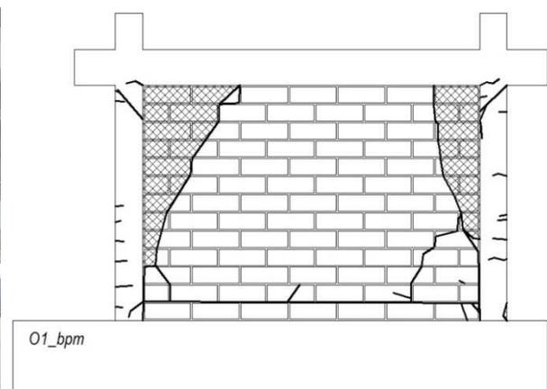
**Slika 6.26** Prikaz oštećenja i pukotina ispitnog uzorka O1\_bpm
