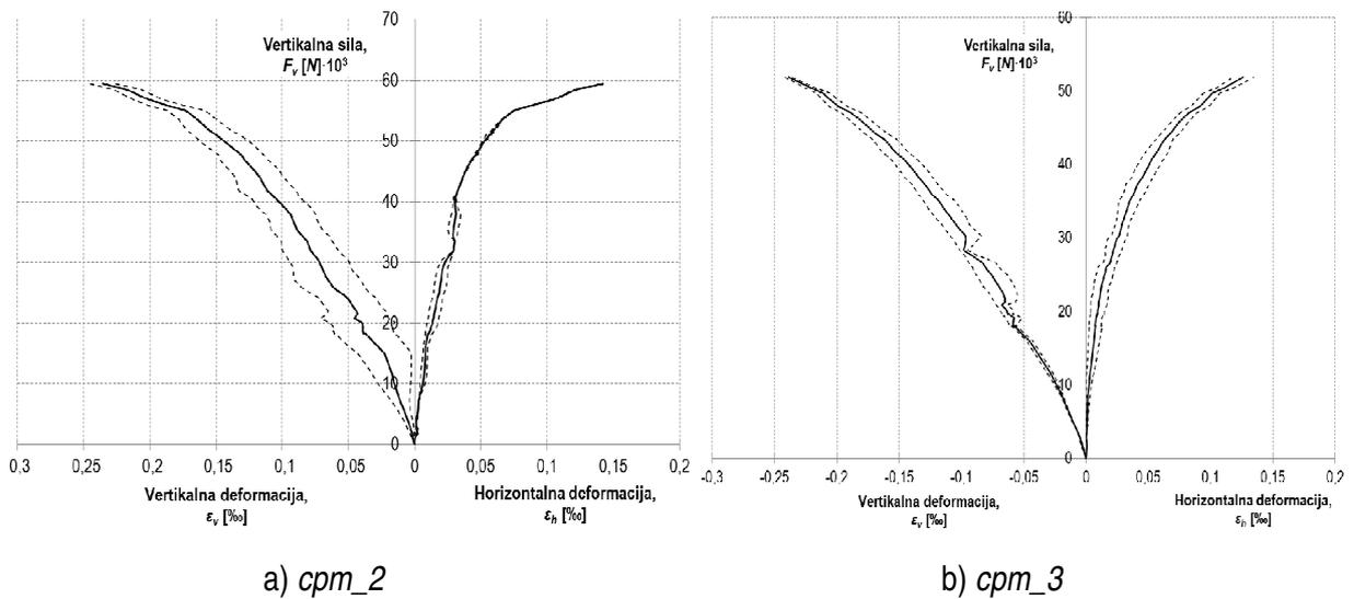
Slika 5.19 Ovisnost opterećenja i pripadnih deformacija dijagonala za cpm uzorke zidanog ispuna
