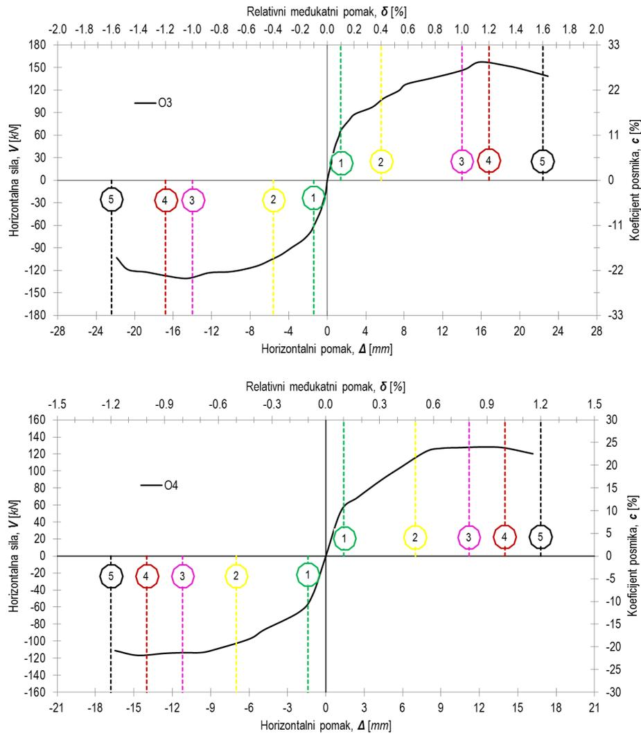
Slika 8.9 Shematski prikaz razina oštećenja uzoraka praznih okvira
