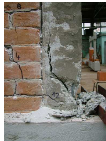
Slika 6.61 Prikaz oštećenja stupova ispitnog uzorka O1_cvm
