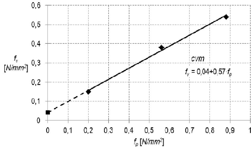
Slika 5.8 Prikaz rezultata ispitivanja posmične čvrstoće *cvm* uzoraka zidanog ispuna
