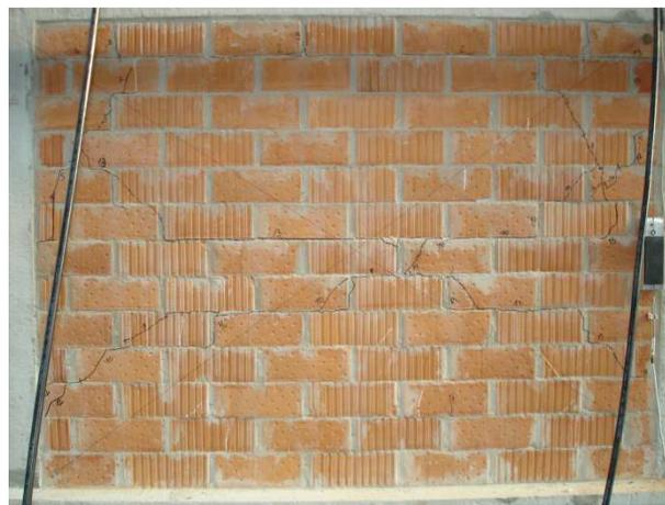
**Slika 6.97** Prikaz dominantnog mehanizma sloma ispune ispitnog uzorka O3\_bpm
