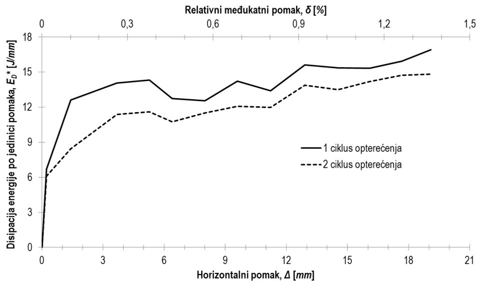
Slika 6.13 Disipacija energije po jedinici pomaka za ispitni uzorak O1
