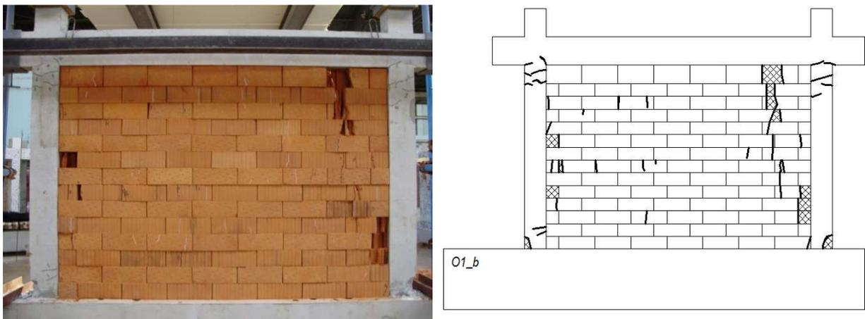
**Slika 6.69** Prikaz oštećenja i pukotina ispitnog uzorka *O1\_b*
