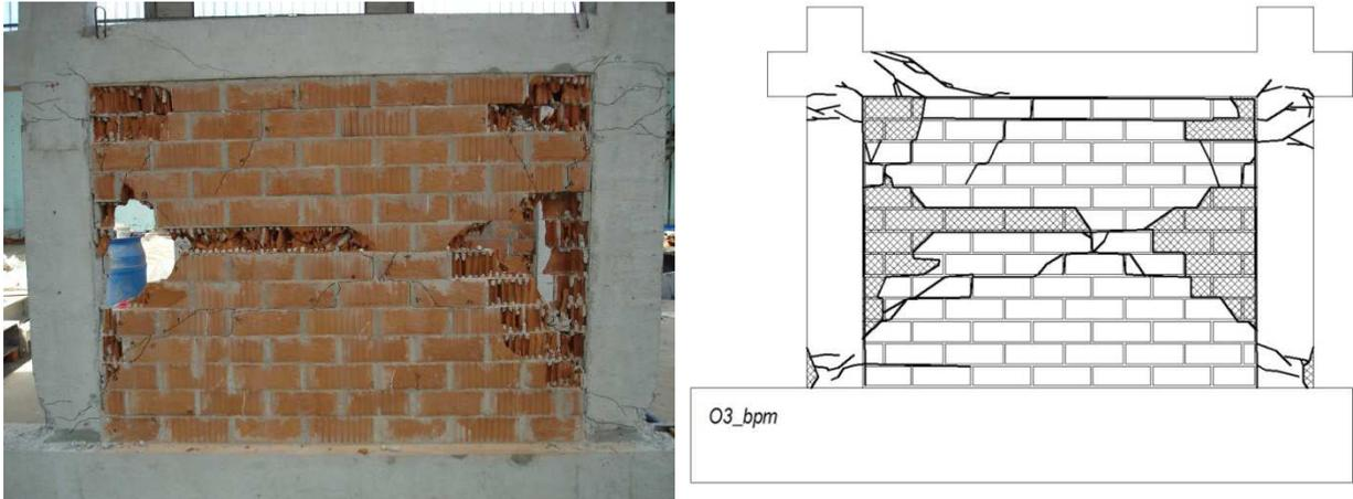
**Slika 6.96** Prikaz oštećenja i pukotina ispitnog uzorka O3\_bpm
