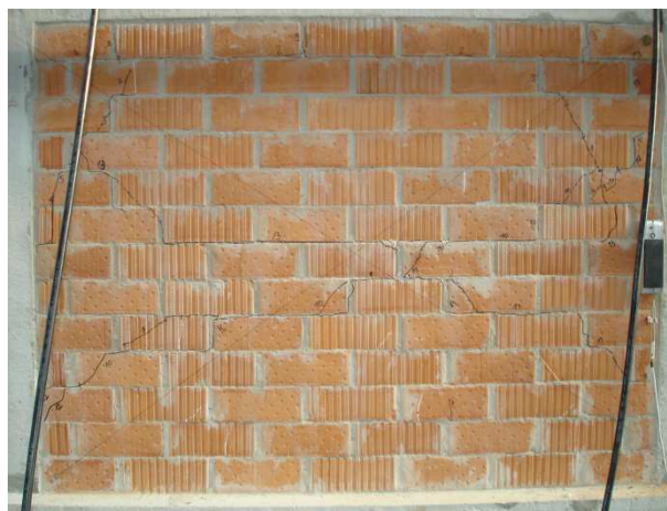
Slika 6.97 Prikaz dominantnog mehanizma sloma ispune ispitnog uzorka O3_bpm
