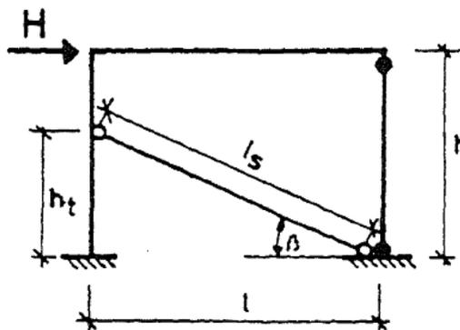
Slika 7.11 Model sa zamjenskom tlačnom dijagonalom prema Žarniću []
