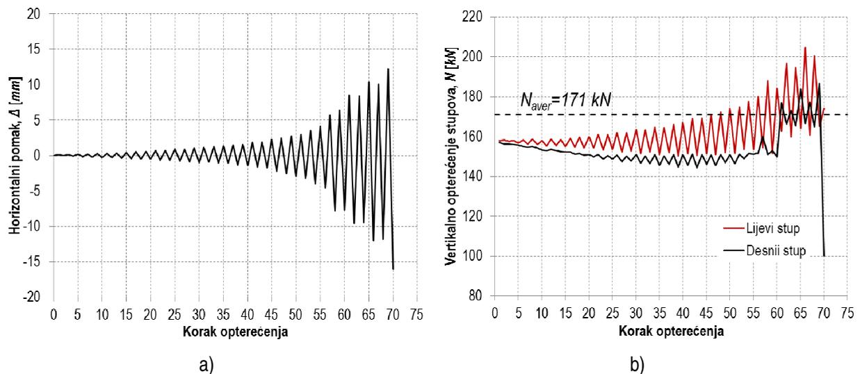
Slika 6.71 Prikaz horizontalnog i vertikalnog opterećenja ispitnog uzorka O2\_cpm
