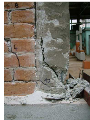
Slika 6.61 Prikaz oštećenja stupova ispitnog uzorka O1_cvm
