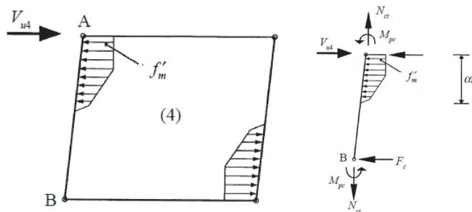
Slika 7.9 Prikaz unutarnjih sila za 4. mehanizam sloma, [12].
