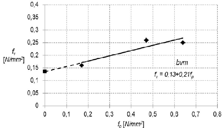
Slika 5.7 Prikaz rezultata ispitivanja posmične čvrstoće *bvm* uzoraka zidanog ispunaTablica 5.7 Rezultati ispitivanja posmične čvrstoće *cvm* uzoraka zidanog ispuna
