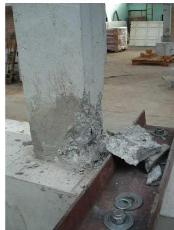
d) Oštećenje desnog stupa ispitnog uzorka
