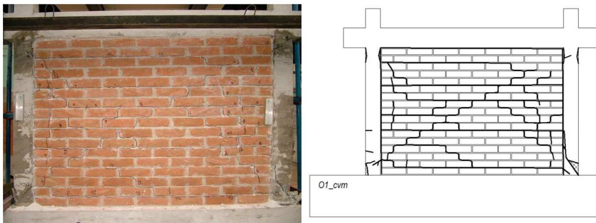
Slika 6.58 Prikaz oštećenja i pukotina ispitnog uzorka O1\_cvm
