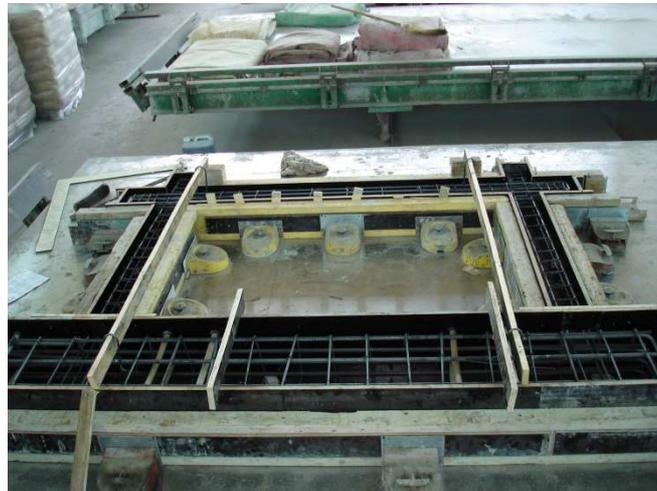
**Slika 3.5** Prikaz izvedbe ispitnih uzoraka neduktilniharmirano-betonskih okvira
