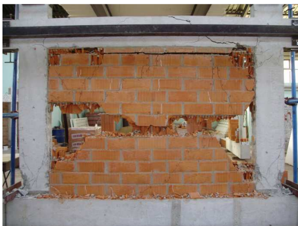
Slika 6.127 Prikaz oštećenja i pukotina ispitnog uzorka O4_bpm
