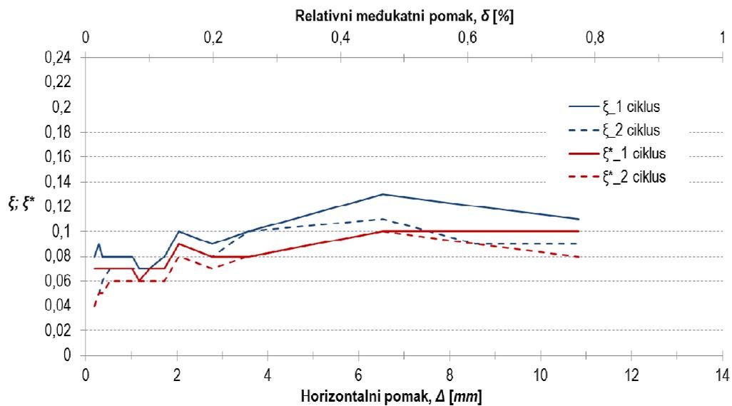
Slika 6.77 Ovisnost prigušenja ispitnog uzorka O2\_cpm o pomaku
