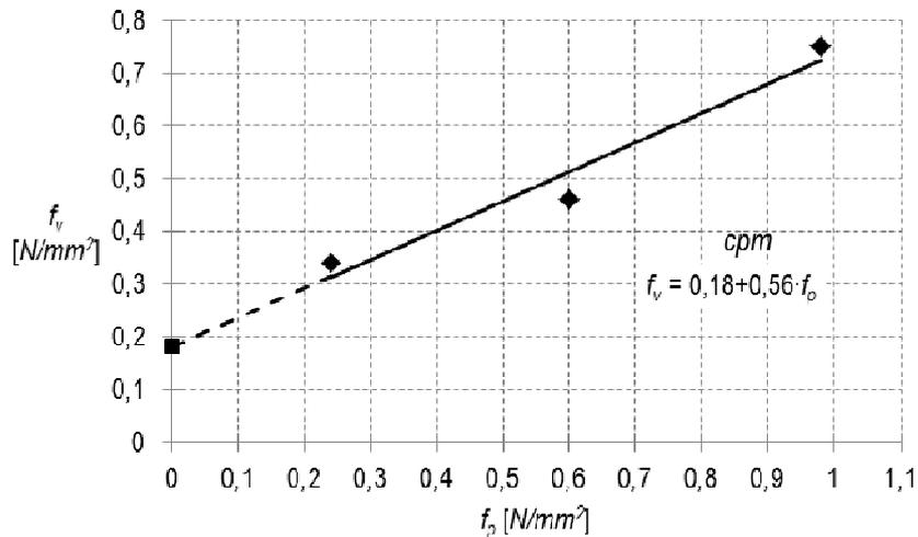
Slika 5.6 Prikaz rezultata ispitivanja posmične čvrstoće *cpm* uzoraka zidanog ispunaTablica 5.6 Rezultati ispitivanja posmične čvrstoće *bvm* uzoraka zidanog ispuna
