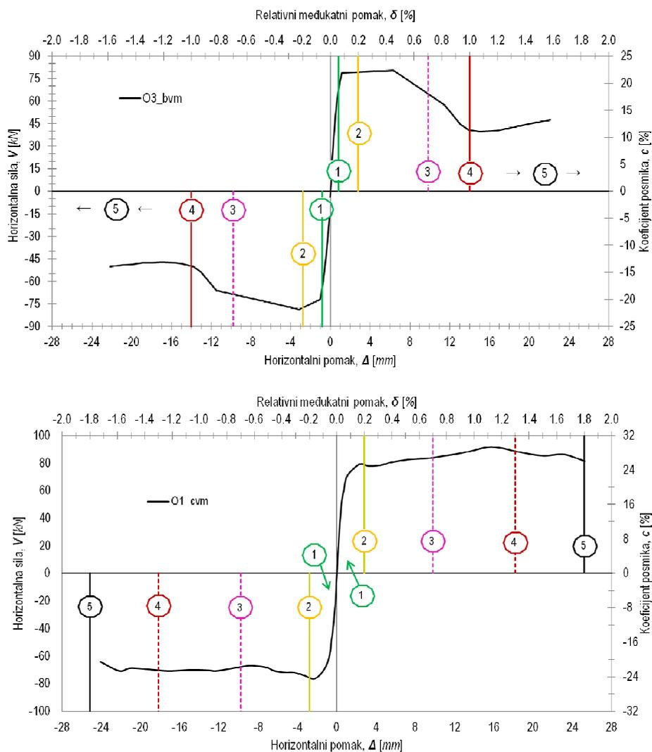
Slika 8.8 Shematski prikaz razina oštećenja uzoraka uokvirenog zida
