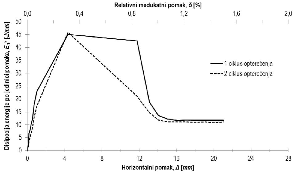
Slika 6.45 Disipacija energije po jedinici pomaka za ispitni uzorak O1\_bvm
