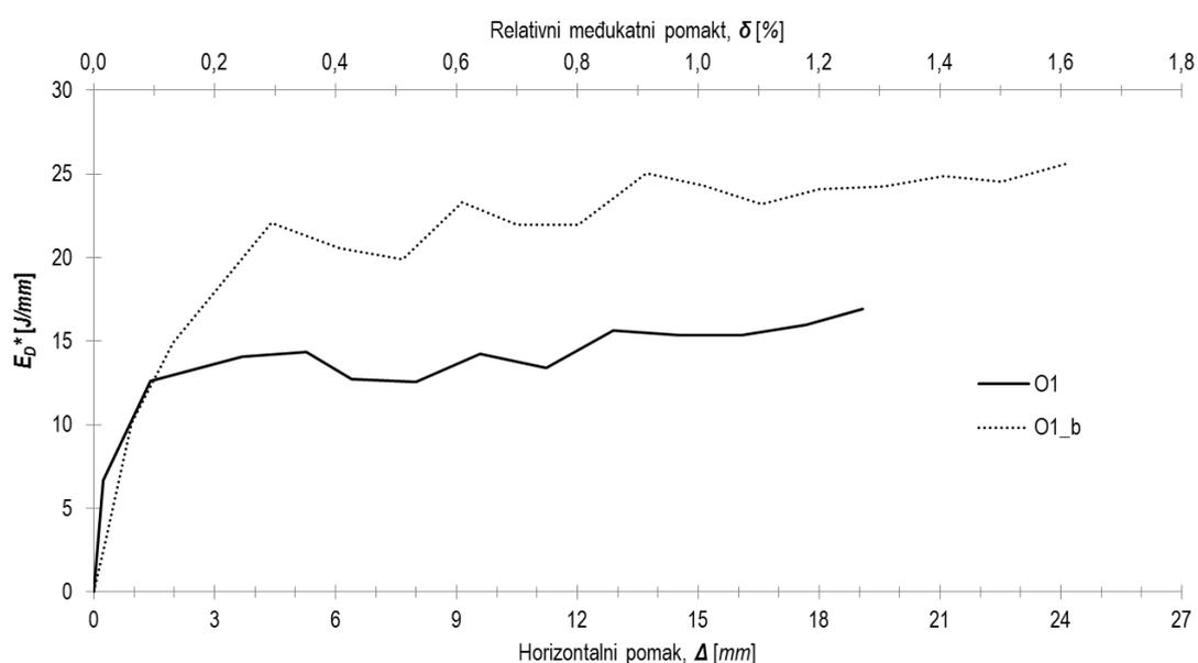
Slika 6.145 Prikaz disipacije energije ispitnog uzorka *O1\_b*
