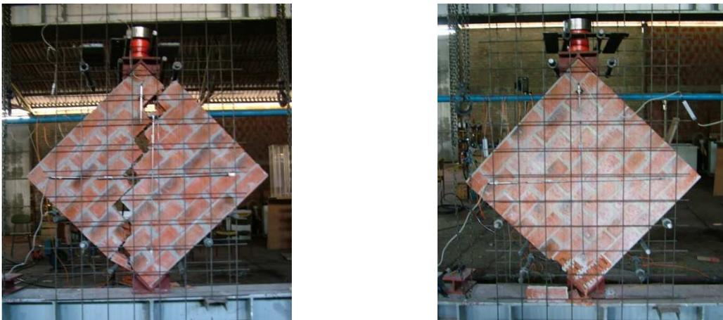
**Slika 5.6** Slom *bpm* uzoraka zidanog ispuna pri dijagonalnom tlaku: a) dijagonalni slom i b) drobljenje uglova
