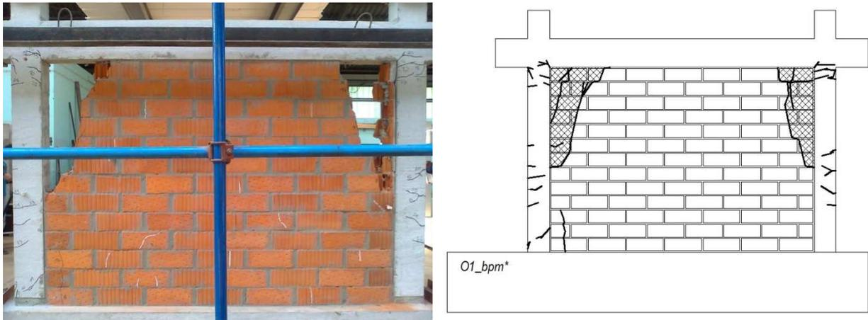
Slika 6.31 Prikaz oštećenja i pukotina ispitnog uzorka O1\_bpm\*
