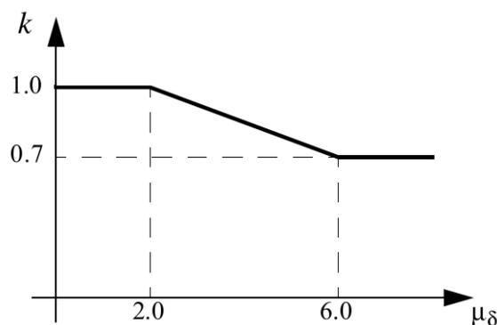
**Slika 7.18** Vrijednost koeficijenta  $k$  u ovisnosti o duktilnosti presjeka elementa [71]
