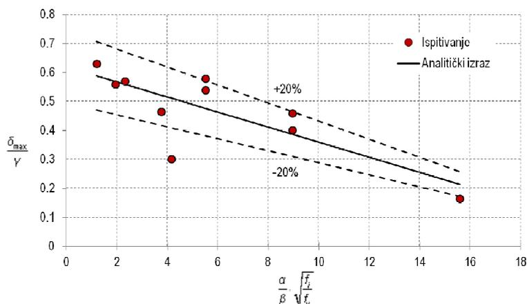
**Slika 7.23** Usporedba eksperimentalnih i analitički procijenjenih vrijednosti  $\delta_{max}$
