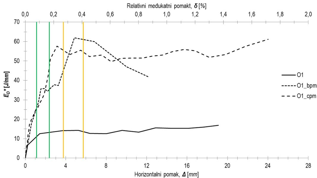
**Slika 6.144 a)** Prikaz disipacije energije po jedinici pomaka uzoraka skupine O1 kod kojih je ispun izvedena od morta opće namjene
