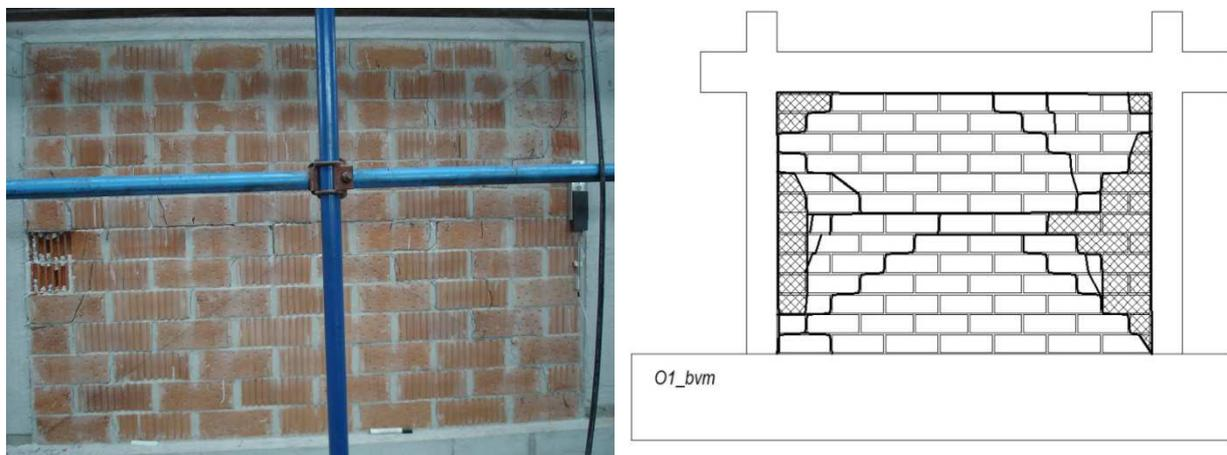
**Slika 6.49** Prikaz oštećenja i pukotina ispitnog uzorka O1\_bvm
