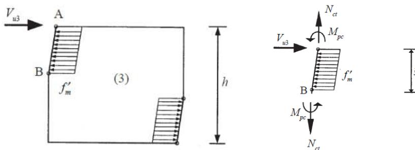
Slika 7.8 Prikaz unutarnjih sila za 3. mehanizam sloma [12]
