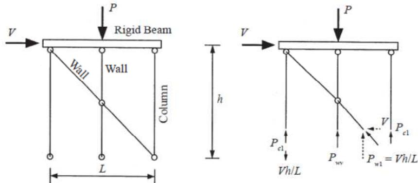
Slika 7.4 Model raspodjele vertikalnog opterećenje prema Fioratu [65]
