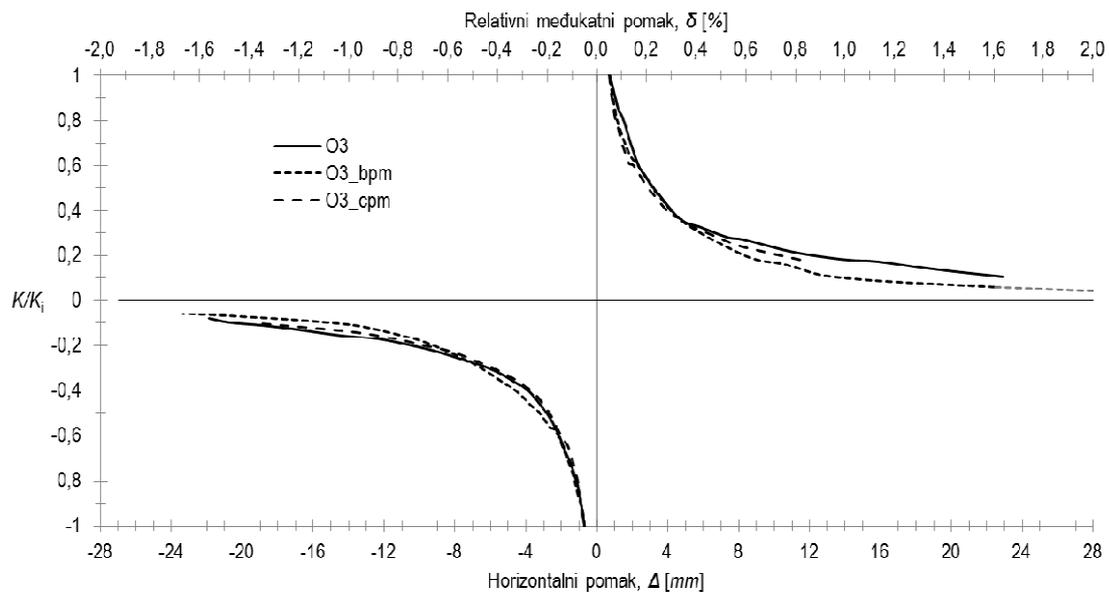
**Slika 6.153** Prikaz degradacije sekantne krutosti ispitnih uzoraka skupine O3 u ovisnosti o horizontalnom pomaku
