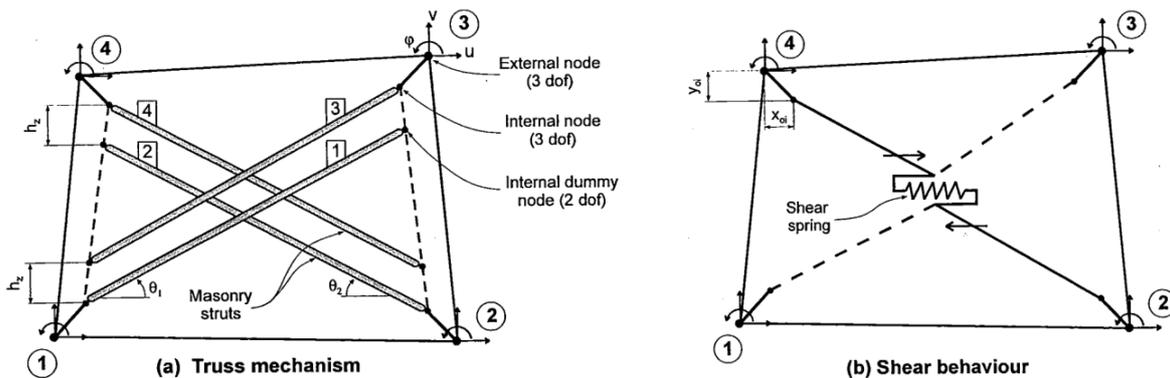
Slika 2.3 Makro model: a) zamjenske tlačne dijagonale i b) posmična dijagonala [13]
