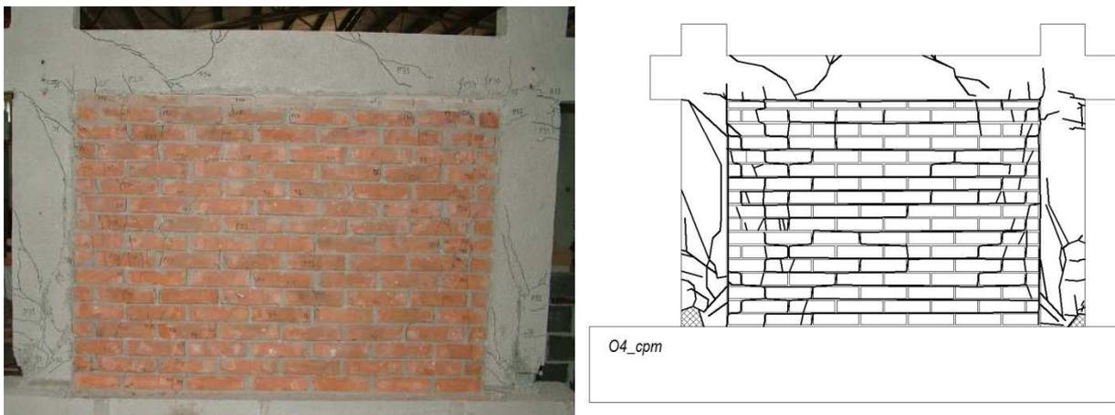
**Slika 6.137** Prikaz oštećenja i pukotina ispitnog uzorka O4\_cpm
