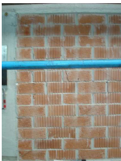
Slika 6.50 Prikaz prvih pukotina ispitnog uzorka O1_bvm
