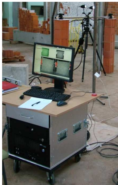
Slika 6.2 Prikaz mjernog optičkog sustava ARAMIS
