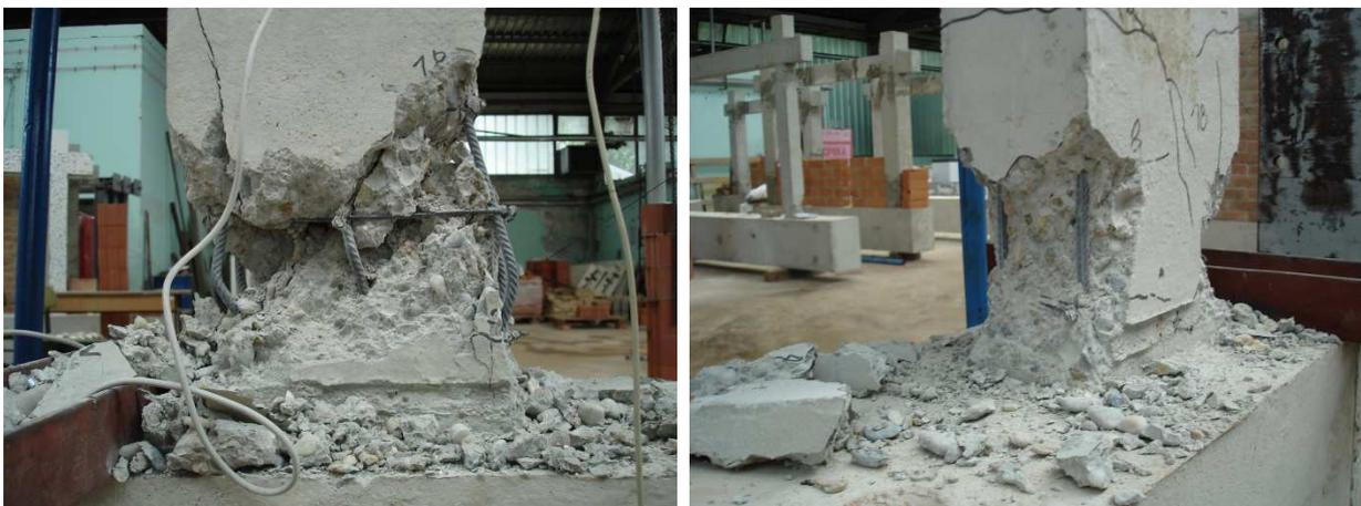
Slika 6.88 Slom i oštećenje stupova ispitnog uzorka O3
