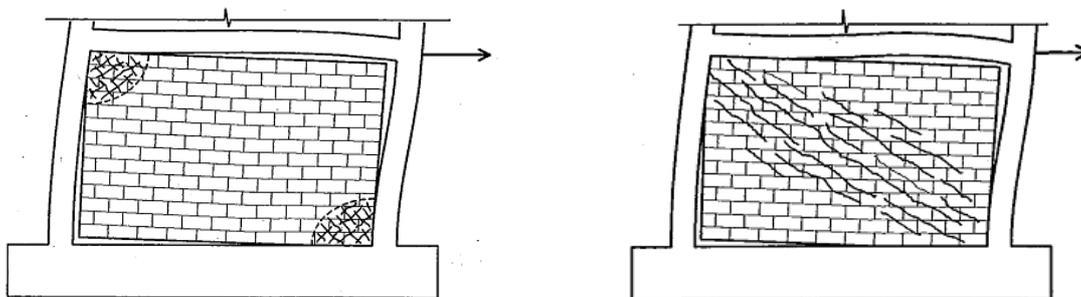
**Slika 2.10** Tlačni slom zidanog ispuna a) drobljenje uglova, b) slom dijagonale [13]
