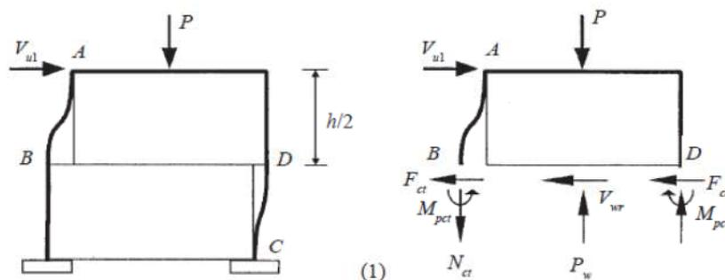
Slika 7.6 Prikaz unutarnjih sila za 1. mehanizam [12]
