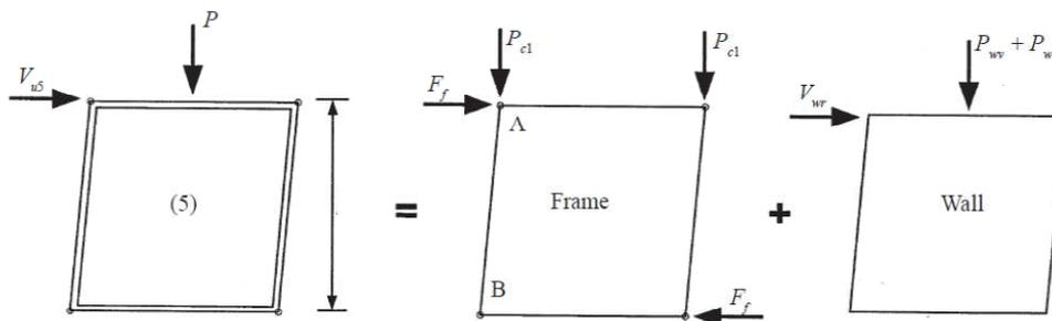
Slika 7.10 Prikaz unutarnjih sila za 5. mehanizam sloma [12]
