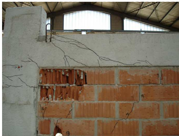
c) Greda okvira ispitnog uzorka
