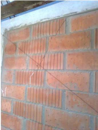
a) Prva značajna pukotina pri pozitivnom smjeru opterećenja
