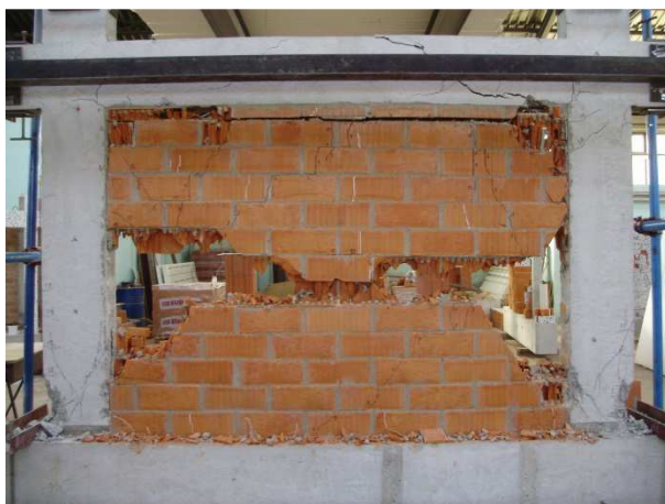
Slika 6.127 Prikaz oštećenja i pukotina ispitnog uzorka O4_bpm
