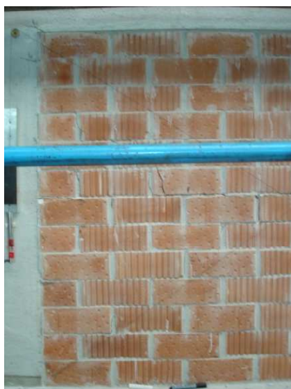
Slika 6.50 Prikaz prvih pukotina ispitnog uzorka O1_bvm
