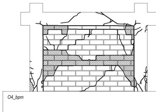
**Slika 6.127** Prikaz oštećenja i pukotina ispitnog uzorka O4\_bpm
