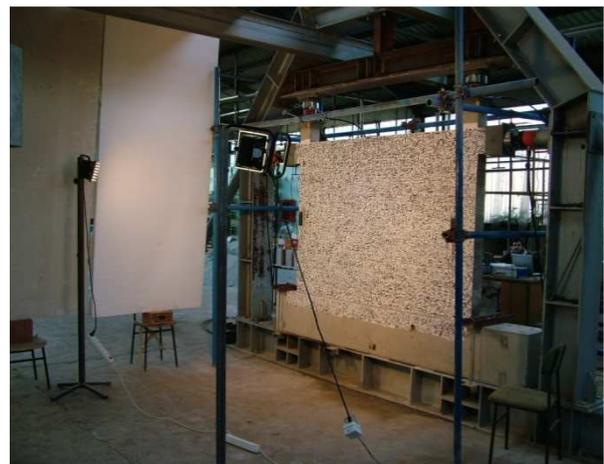
Slika 6.5 Osvjetljenje ispitnog uzorka
