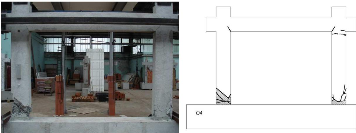
**Slika 6.118** Prikaz oštećenja i pukotina ispitnog uzorka O4
