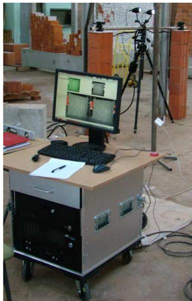
**Slika 6.2** Prikaz mjernog optičkog sustava ARAMIS
