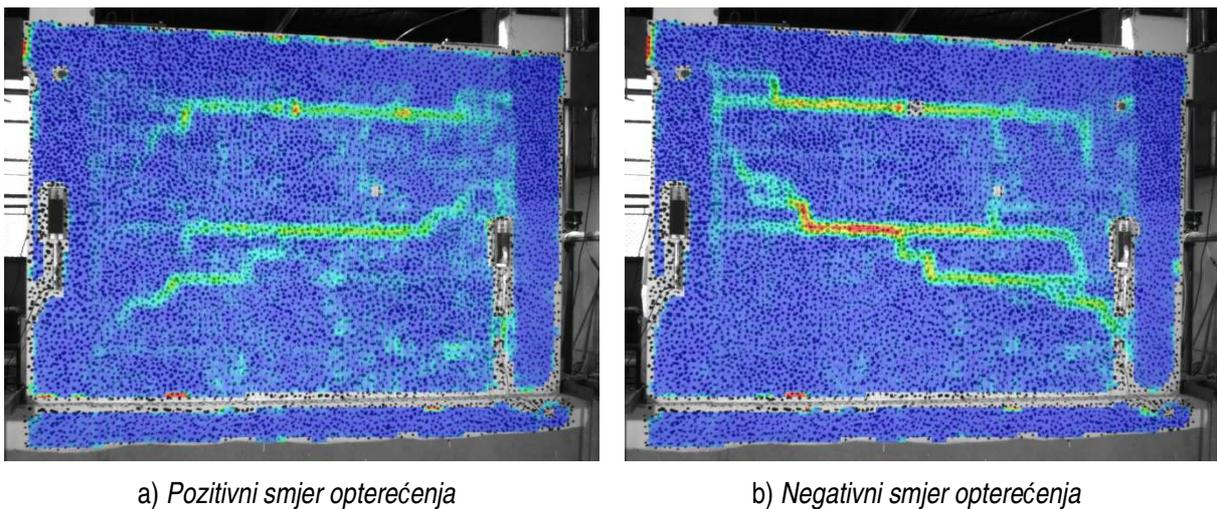
**Slika 6.98** Prikaz dominantnih ploha sloma ispune ispitnog uzorka O3\_bpm pri pojavi horizontalnog klizanja
