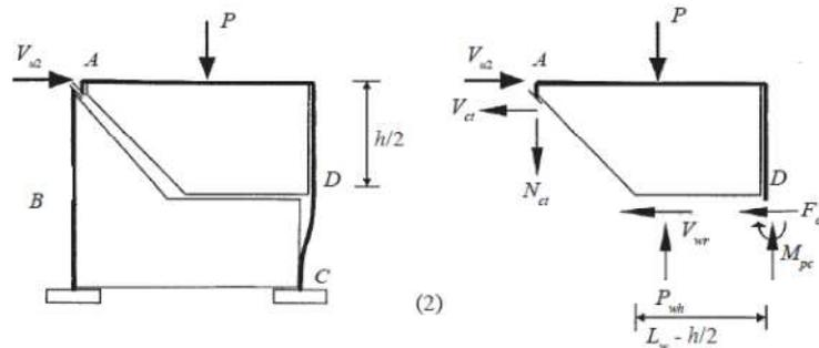
Slika 7.7 Prikaz unutarnjih sila za 2. mehanizam [12]
