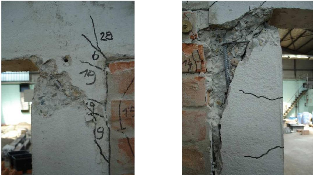
Slika 6.41 Prikaz posmičnih pukotina stupova okvira ispitnog uzorka O1\_cpm
