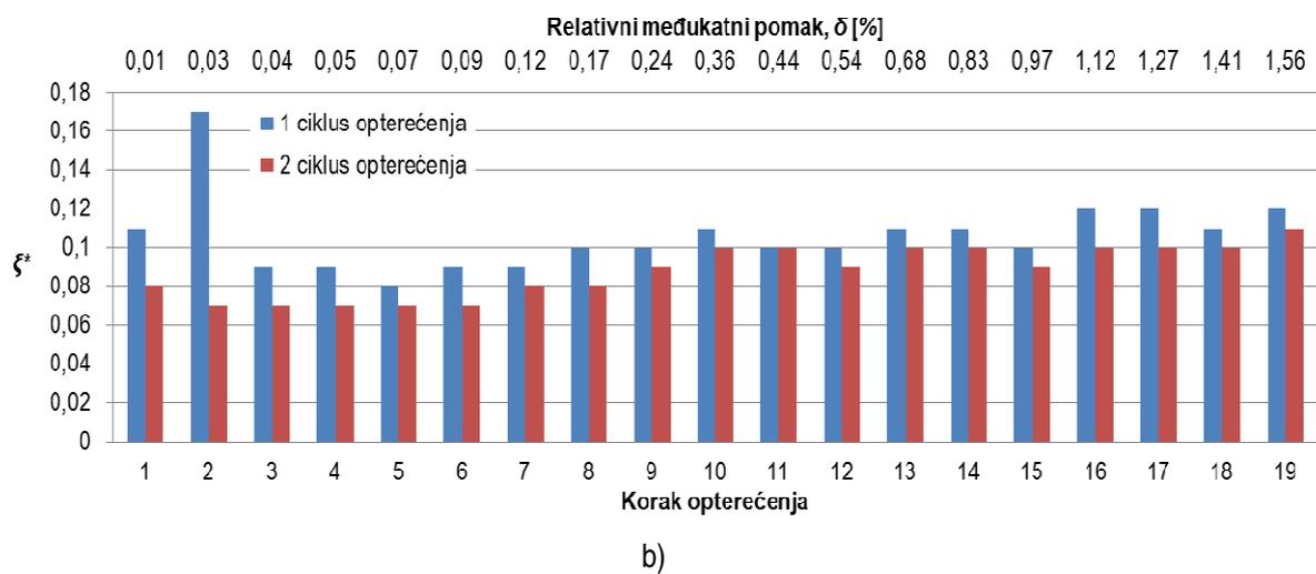
Slika 6.85 Prigušenje ispitnog uzorka O3 u ovisnosti o načinu izračuna apsorbirane energije
