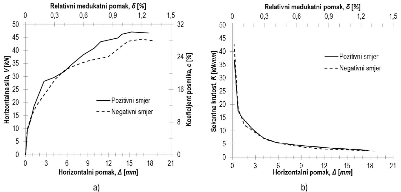
**Slika 6.12** Prikaz primarnih krivulja odgovora i sekantne krutosti, u ovisnosti o pomaku, pri pozitivnom i negativnom smjeru opterećenja ispitnog uzorka O1
