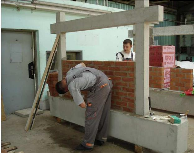
**Slika 3.6** Zidanje ispuna uzorka
