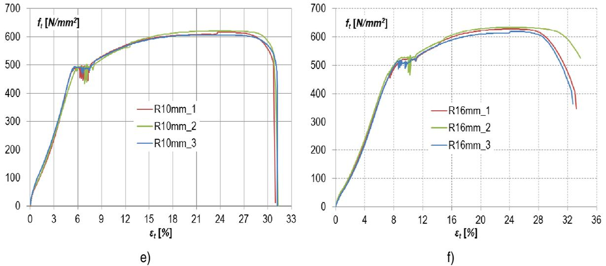
Slika 4.2 a) Prikaz ispitnog uzorka, b) radni dijagrami uzorka  $G\Phi 3,2mm$ , c) radni dijagrami uzorka  $G\Phi 8mm$ , d) radni dijagrami uzorka  $R\Phi 8mm$ , e) radni dijagrami uzorka  $R\Phi 10mm$  i f) radni dijagrami uzorka  $R\Phi 16mm$
