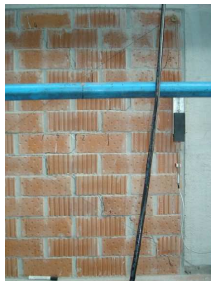
Slika 6.50 Prikaz prvih pukotina ispitnog uzorka O1_bvm
