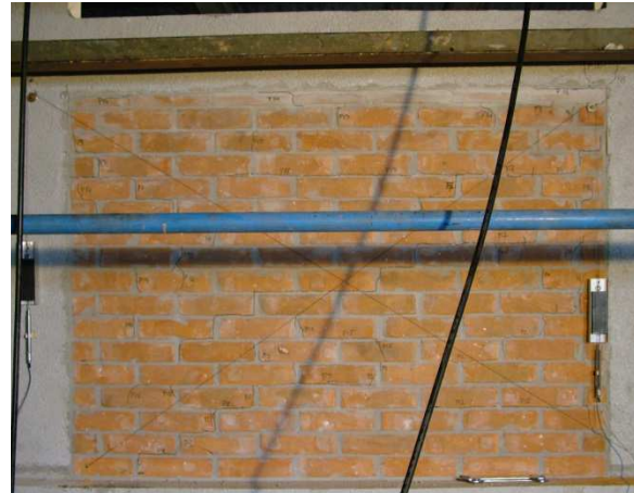
b) Prve značajne pukotine pri pozitivnom smjeru opterećenja
