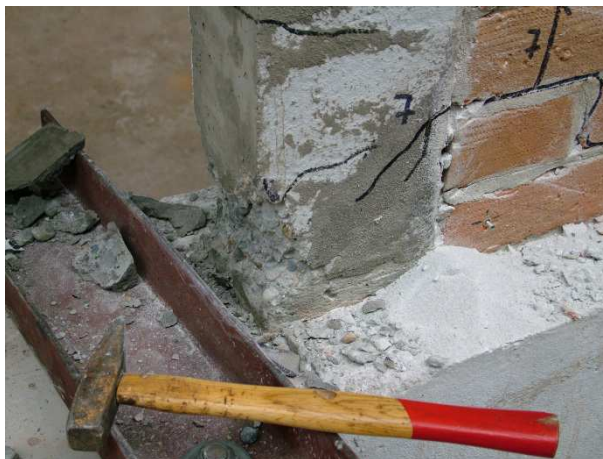
Slika 6.61 Prikaz oštećenja stupova ispitnog uzorka O1_cvm
