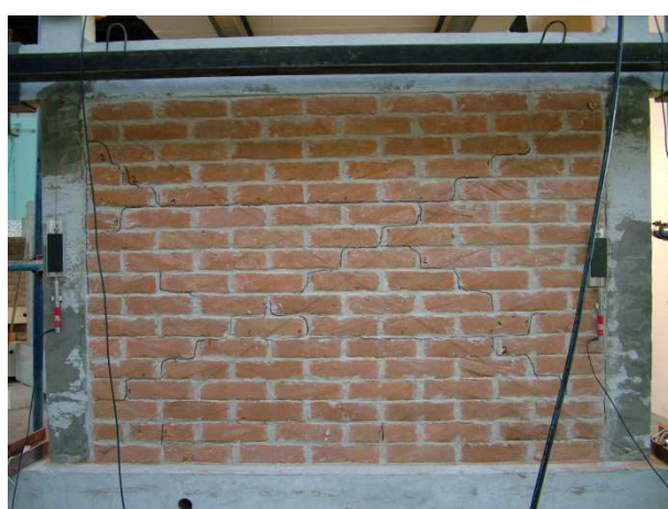
Slika 6.59 Prve značajne pukotine u ispuni ispitnog uzorka O1_cvm
