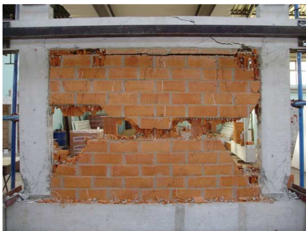
Slika 6.127 Prikaz oštećenja i pukotina ispitnog uzorka O4_bpm
