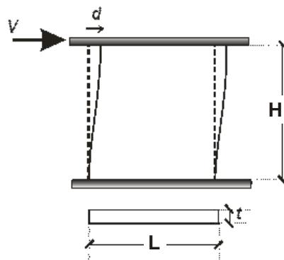
Slika 4.14. Deformacija zida upetog na oba horizontalna ruba
