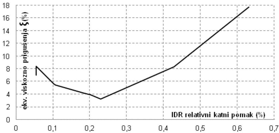
Slika 4.77. Prigušenje uzorka B3
