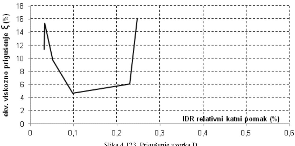
Slika 4.123. Prigušenje uzorka D
