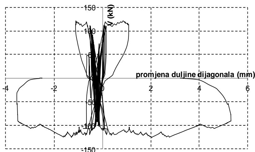
Slika 4.29. Promjena duljina dijagonala ovisnosti o promjeni hor. Sile V uzorka A2
