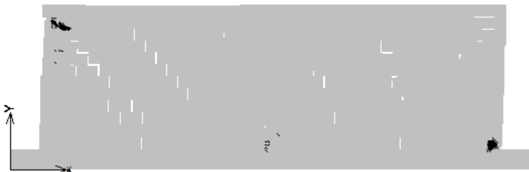
Slika 5.32. Slika deformacija i pukotina većih od 0,1mm pri relativnom katnom pomaku od 0,5% (hor. pomici povećani 10 puta) model zida F
