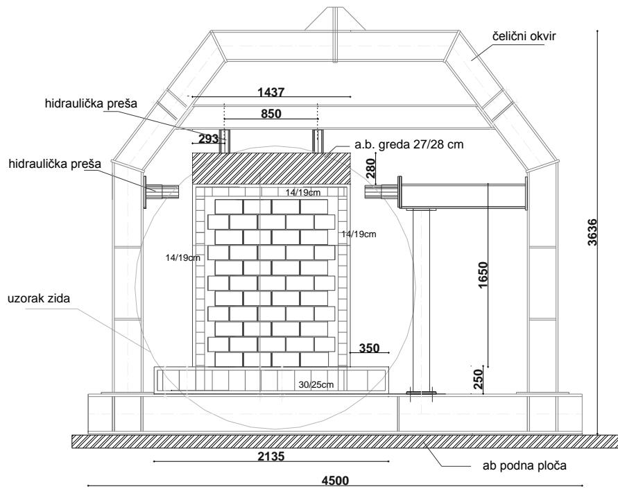
Slika 4.8. Položaj uzorka i preša za opterećenje
