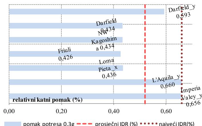
Slika A3. Procijenjeni pomaci jednoetažne građevine gustoće zida  $d_{WA}=3\%$  za potrebe projektnog ubrzanja 0.1g, 0.2g i 0.3g
