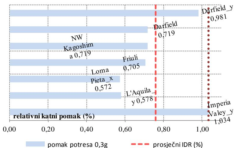
Slika A24. Procijenjeni pomaci četveroetažne građevine gustoće zida  $d_{wA}=6\%$  za potrebe projektnog ubrzanja 0.1g, 0.2g i 0.3g
