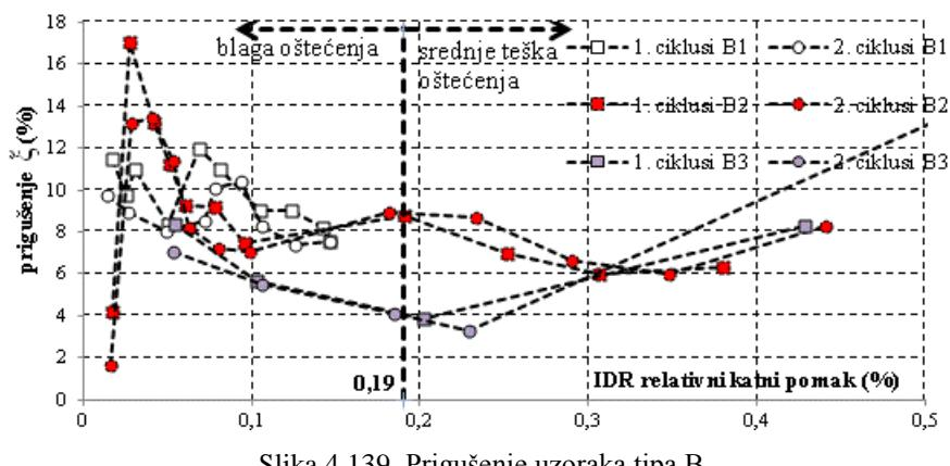
Slika 4.139. Prigušenje uzorka tipa B
