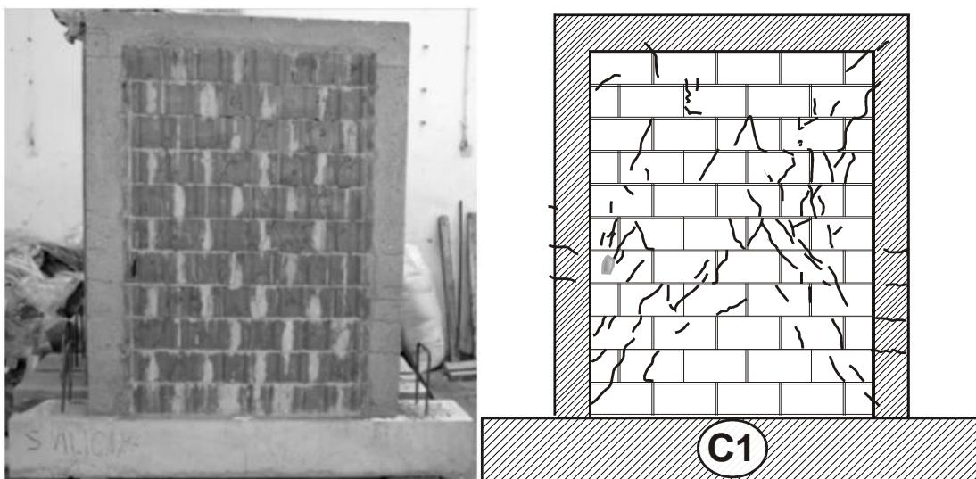
Slika 4.79. Fotografija i crtež pukotina ispitanog uzorka C1
