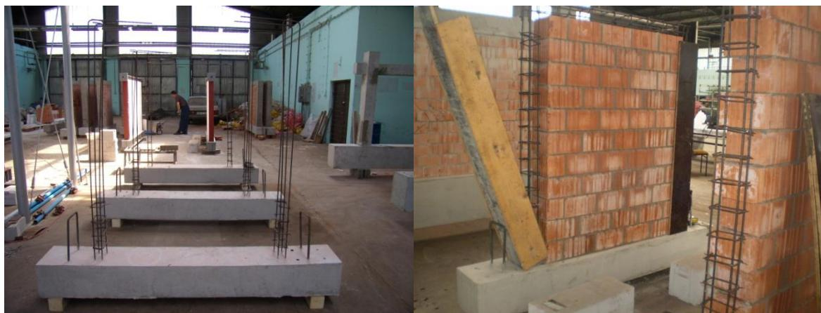
Slika 4.6. Izrada temelja uzoraka, priprema oplate za betoniranje vertikalnih serklaža uzoraka
