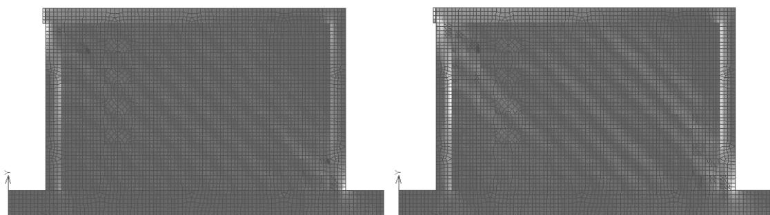
Slika 5.23. Slika glavnih tlačnih naprezanja pri relativnom katnom pomaku od 0,25% i 0,5% modela zida E
