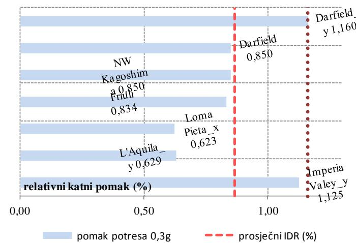
Slika A23. Procijenjeni pomaci četveroetažne građevine gustoće zida  $d_{wA}=5\%$  za potrebe projektnog ubrzanja 0.1g, 0.2g i 0.3g
