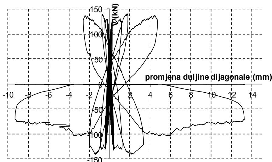
Slika 4.105. Promjena duljina dijagonala ovisnosti o promjeni hor. sile uzorka C3
