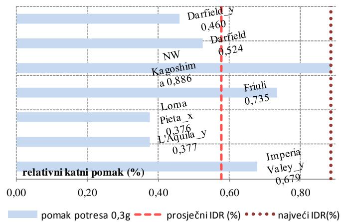
Slika A19. Procijenjeni pomaci četveroetažne građevine gustoće zida  $d_{wA}=2\%$  za potrebe projektnog ubrzanja 0.1g, 0.2g i 0.3g
