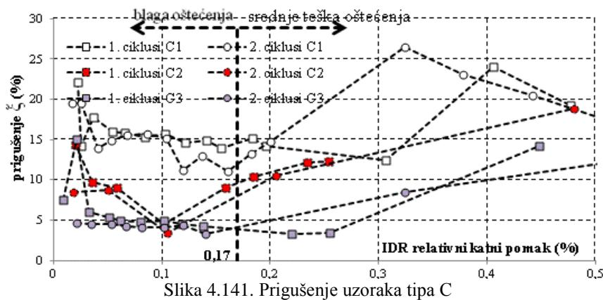
Slika 4.141. Prigušenje uzorka tipa C
