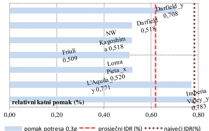
Slika A2. Procijenjeni pomaci jednoetažne građevine gustoće zida  $d_{WA}=2,46\%$  za potrebe projektnog ubrzanja 0.1g, 0.2g i 0.3g
