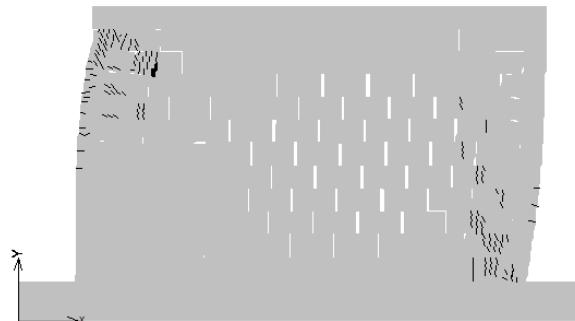
Slika 5.25. Slika deformacija i pukotina većih od 0,1mm pri relativnom katnom pomaku od 1.% (pomaci povećani 10 puta) modela zida E
