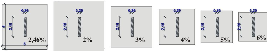
Slika 6.10. Promjena ploštine međukatne konstrukcije pripadajuće zidu
