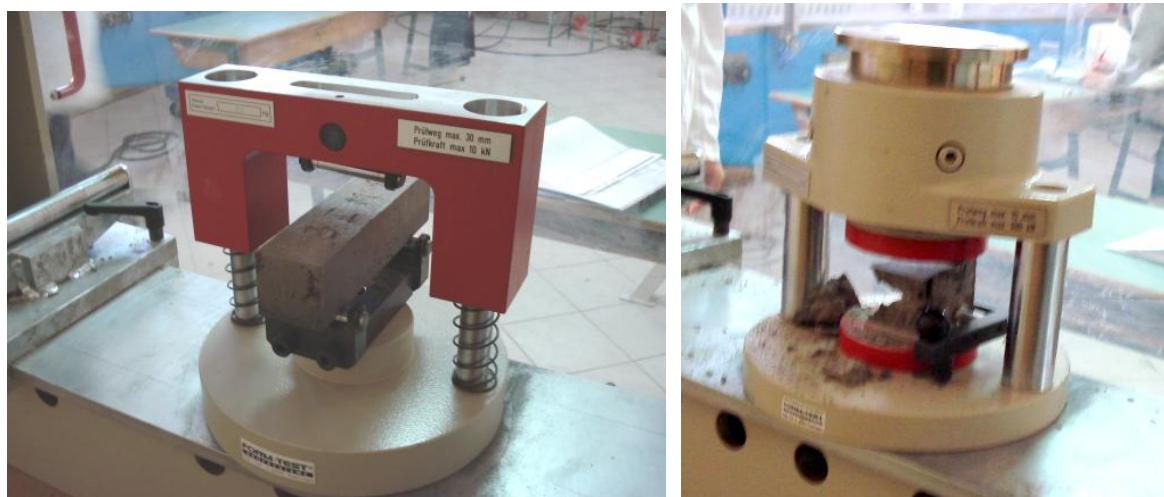
Slika 3.3. Ispitivanje tlačne i čvrstoće morta na savijanje
