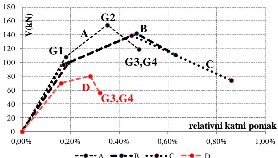
Slika 4.126. Krvilje oštećenja uzoraka A,B,C i D
