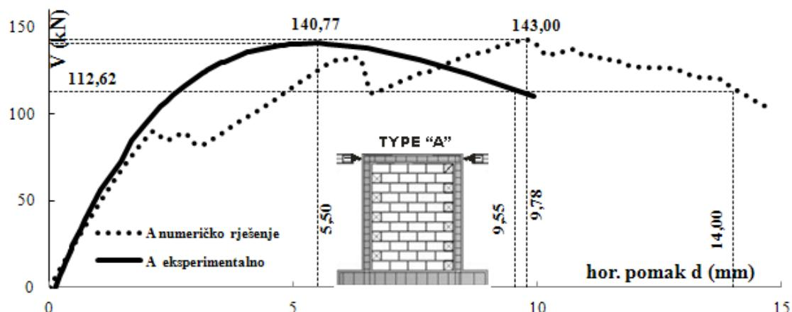
Slika 5.8. Usporedba eksperimentalnih i rezultata numeričke analize za tip A
