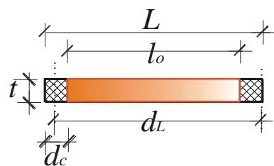
Slika 4.129. Tlocrt omeđenog uzorka zida s označama za proračun
