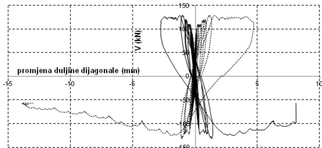
Slika 4.94. Promjena duljina dijagonala ovisnosti o promjeni hor. sile uzorka C2
