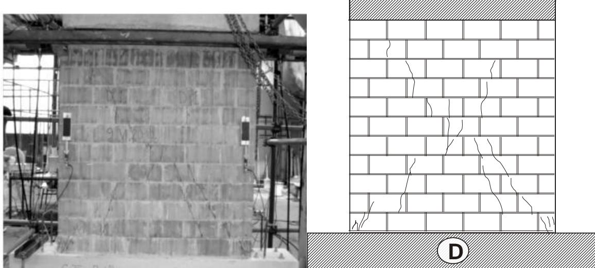
Slika 4.113. Fotografija i crtež pukotina ispitanog uzorka D
