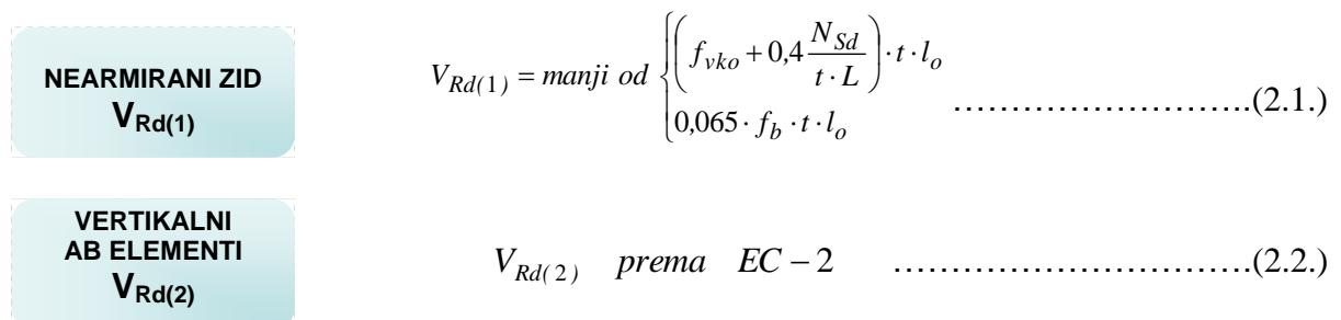
Značenje geometrijskih veličina  $L$ ,  $t$ ,  $d_c$  i  $l_o$  prikazane su slikom.  $f_{vk0}$  je karakteristična posmična čvrstoća zida ako u njemu nema tlačnog naprezanja, koeficijent trenja iznosi 0,4,  $\frac{N_{Sd}}{t \cdot L} = \sigma_{Sd}$  je računsko tlačno naprezanje u zidu, a  $f_b$  normalizirana tlačna čvrstoća zidnog elementa. Doprinos nosivosti vertikalnih armiranobetonskih elemenata računa se kako je to propisano u EC-2 za betonske grede.
