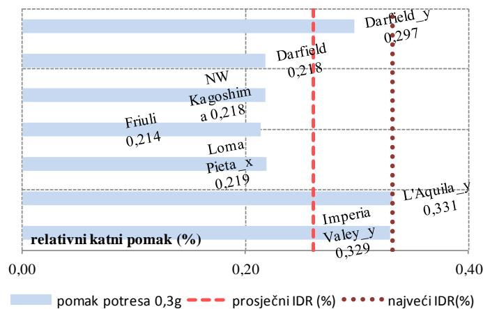
Slika A7. Procijenjeni pomaci dvoetažne građevine gustoće zida  $d_{wA}=2\%$  za potrebe projektnog ubrzanja 0.1g, 0.2g i 0.3g
