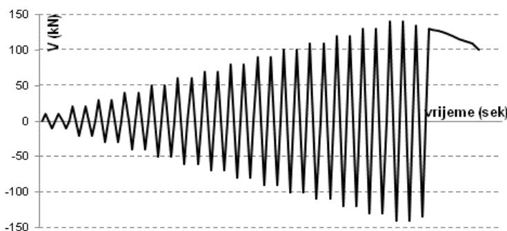
Slika 4.12. Promjena horizontalne sile tijekom ispitivanja
