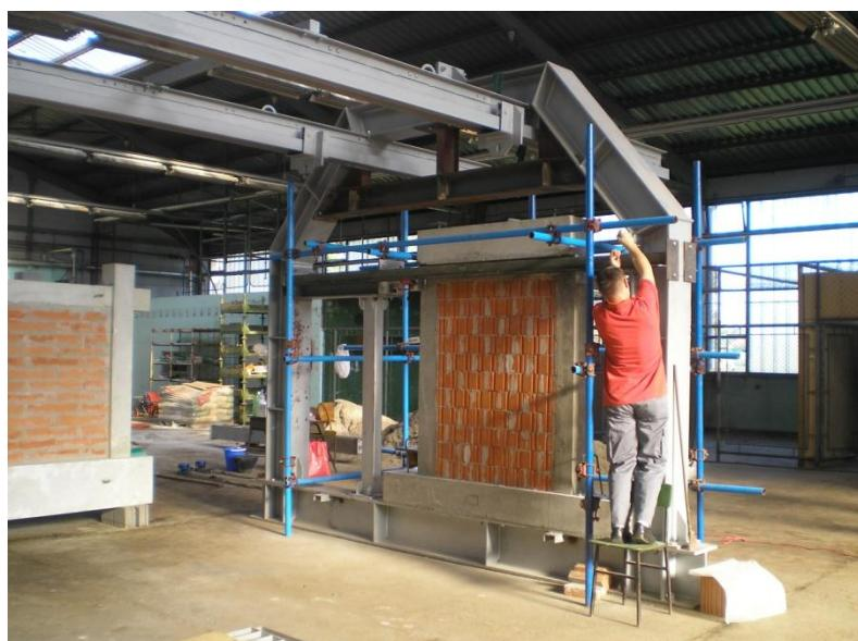
Slika 4.7. Prikaz gotovog uzorka u okviru za ispitivanje
