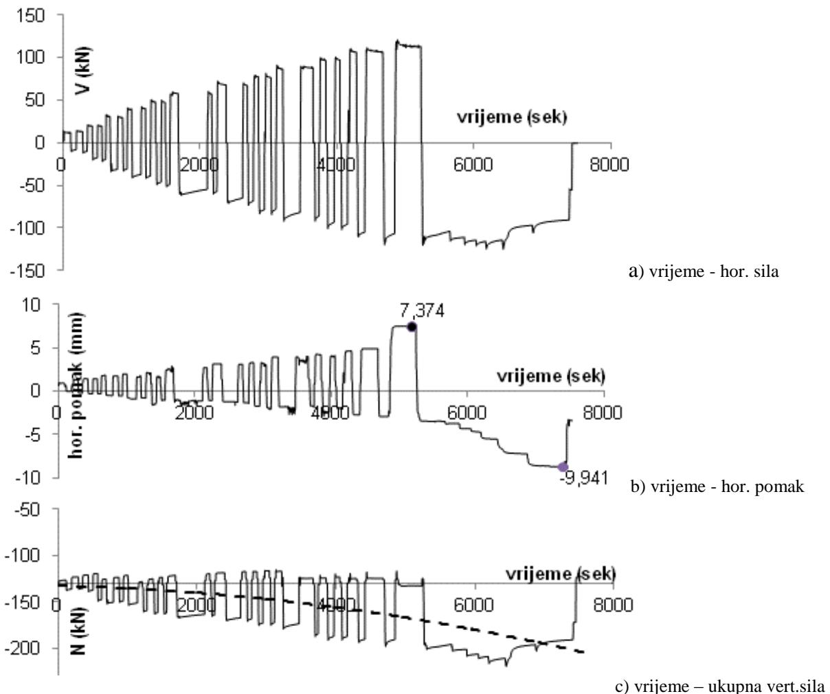
Slika 4.25. Promjena horizontalne sile, pomaka i vertikalnog pritiska uzorka A2
