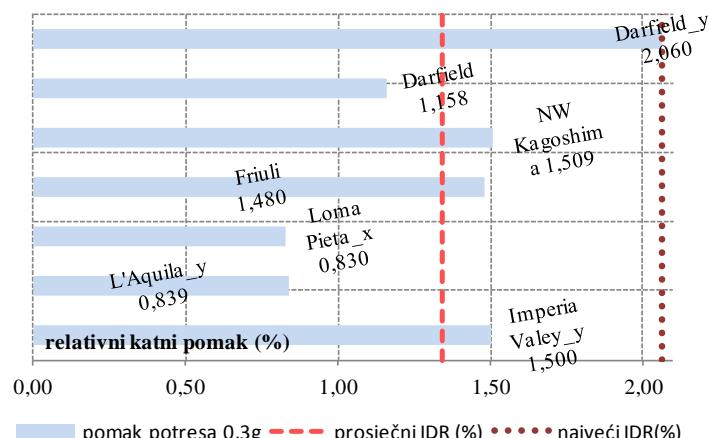
Slika A20. Procijenjeni pomaci četveroetažne građevine gustoće zida  $d_{wA}=2,46\%$  za potrebe projektnog ubrzanja 0.1g, 0.2g i 0.3g
