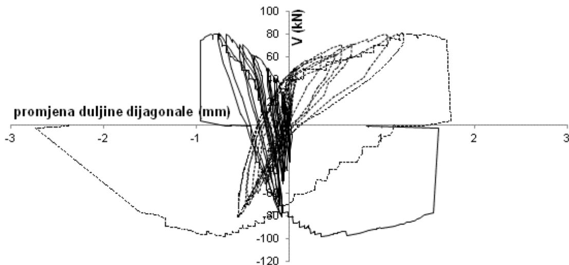
Slika 4.117. Promjena duljina dijagonala ovisno o promjeni hor. sile uzorka D
