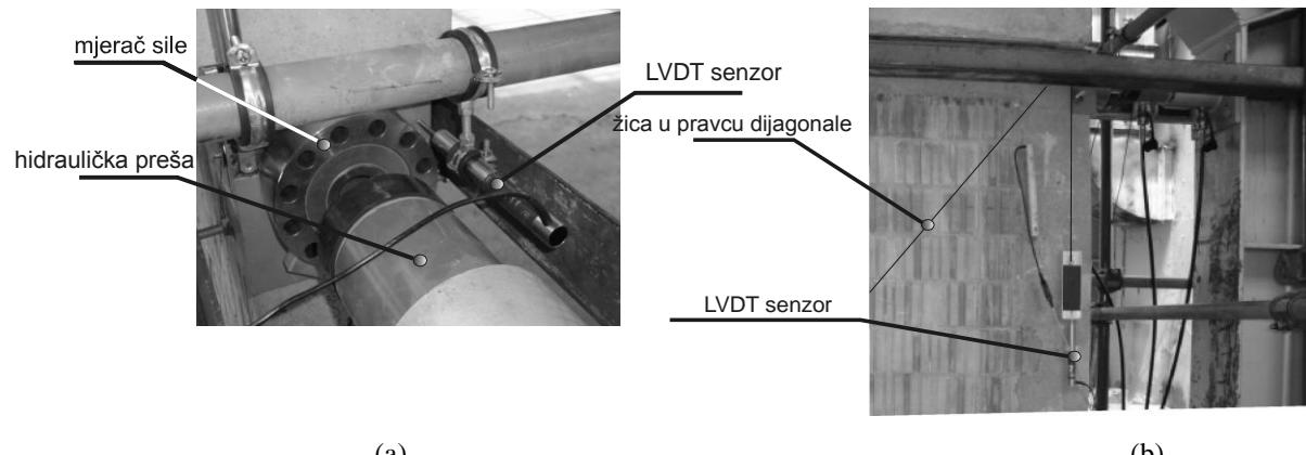
Slika 4.10. Nivo gornjeg vertikalnog serklaža (a), mjerenoj promjeni duljine dijagonale (b)
