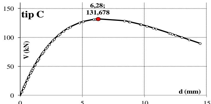
Slika 4.146. Primarna krivulja uzorka tipa „C“
