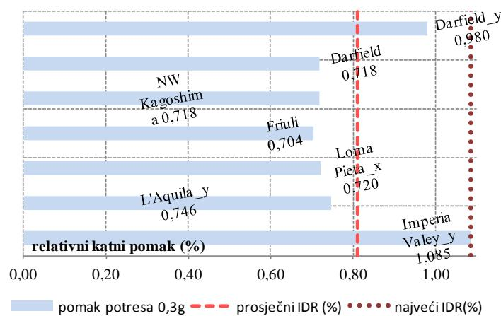
Slika A9. Procijenjeni pomaci dvoetažne građevine gustoće zida  $d_{wA}=3\%$  za potrebe projektnog ubrzanja 0.1g, 0.2g i 0.3g
