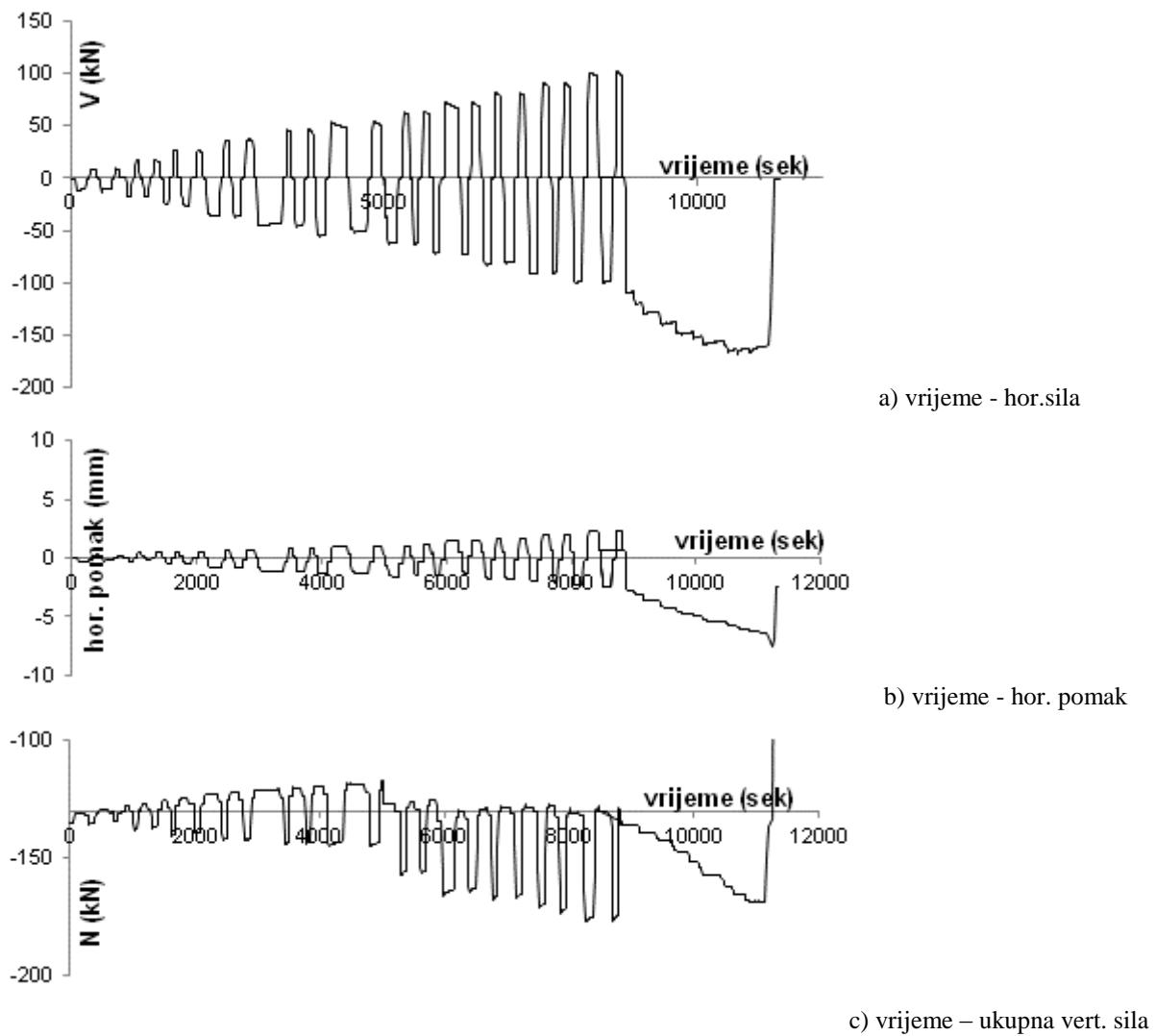
Slika 4.46. Promjena horizontalne sile, pomaka i vertikalnog pritiska uzorka B1
