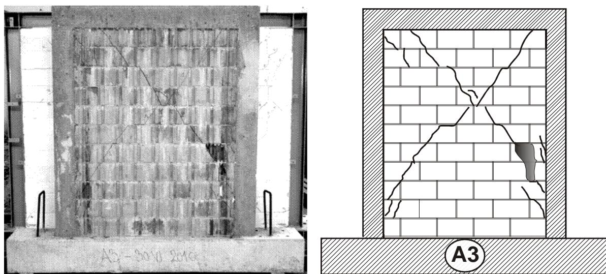
Slika 4.37. Fotografija i crtež pukotina ispitanog uzorka A3
