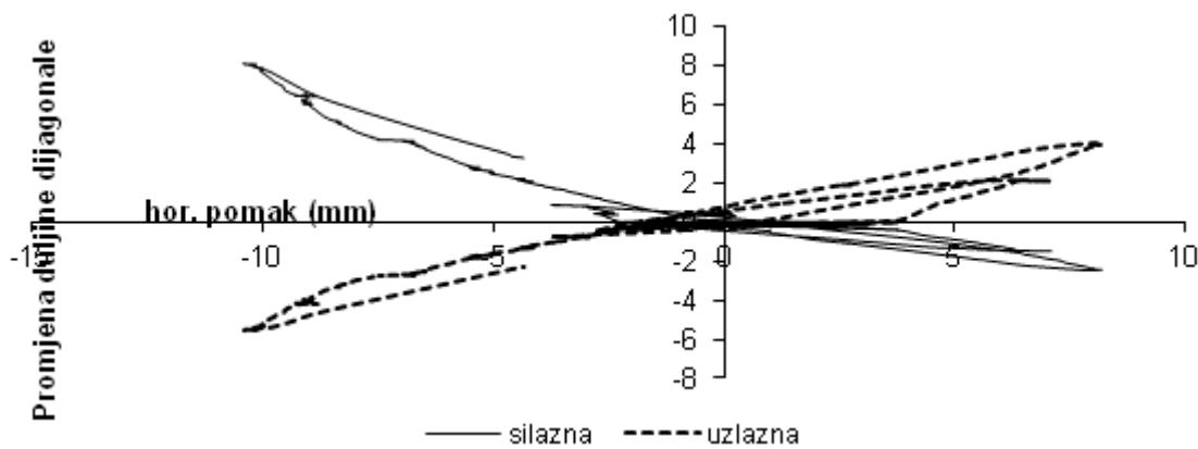
Slika 4.70. Promjena duljina dijagonala u ovisnosti o horizontalnom pomaku uzorka B3
