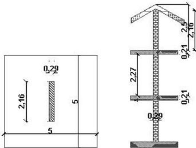
Slika 4.1. Položaj i dimenzije prototipa zida
