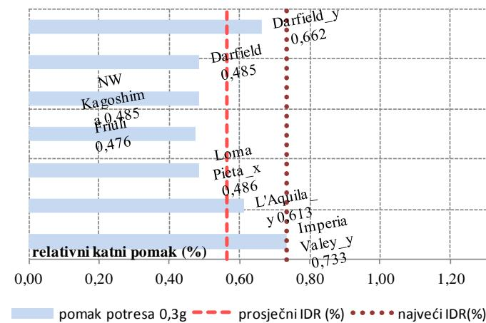
Slika A11. Procijenjeni pomaci dvoetažne građevine gustoće ziđa  $d_{wA}=5\%$  za potrebe projektnog ubrzanja 0.1g, 0.2g i 0.3g
