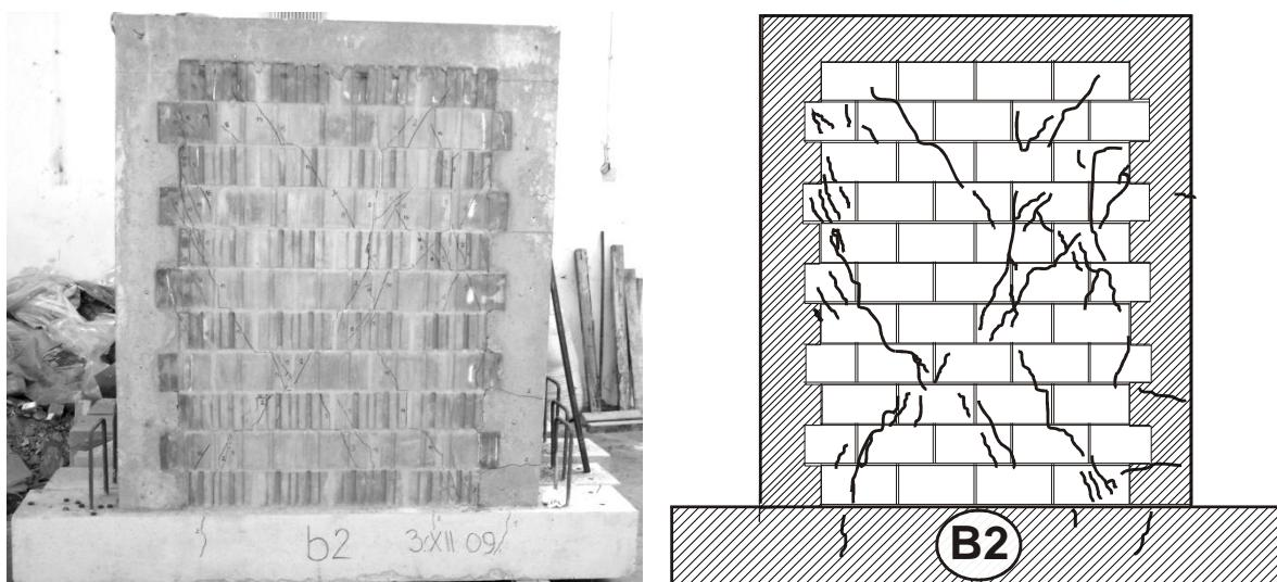
Slika 4.57. Fotografija i crtež pukotina ispitanog uzorka B2
