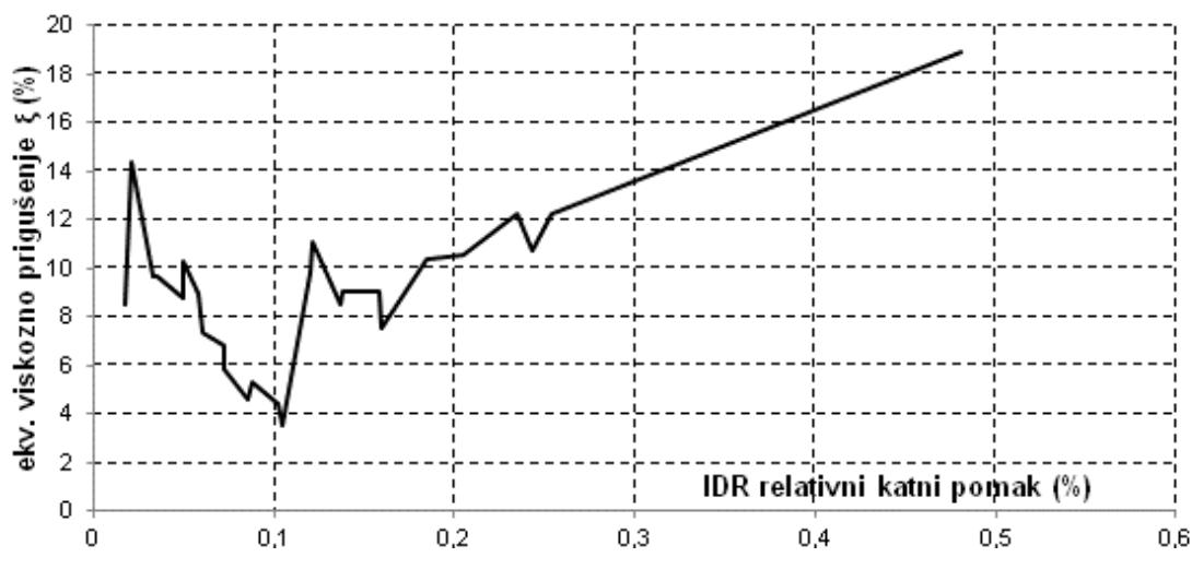
Slika 4.100. Prigušenje uzorka C2
