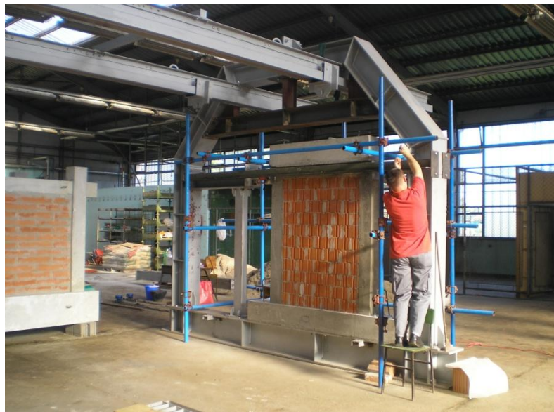
Slika 4.7. Prikaz gotovog uzorka u okviru za ispitivanje
