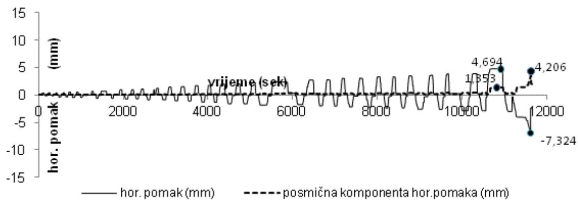
Slika 4.40. Odnos veličine ukupnog mjerenog horizontalnog i pomaka od smicanja uzorka A3
