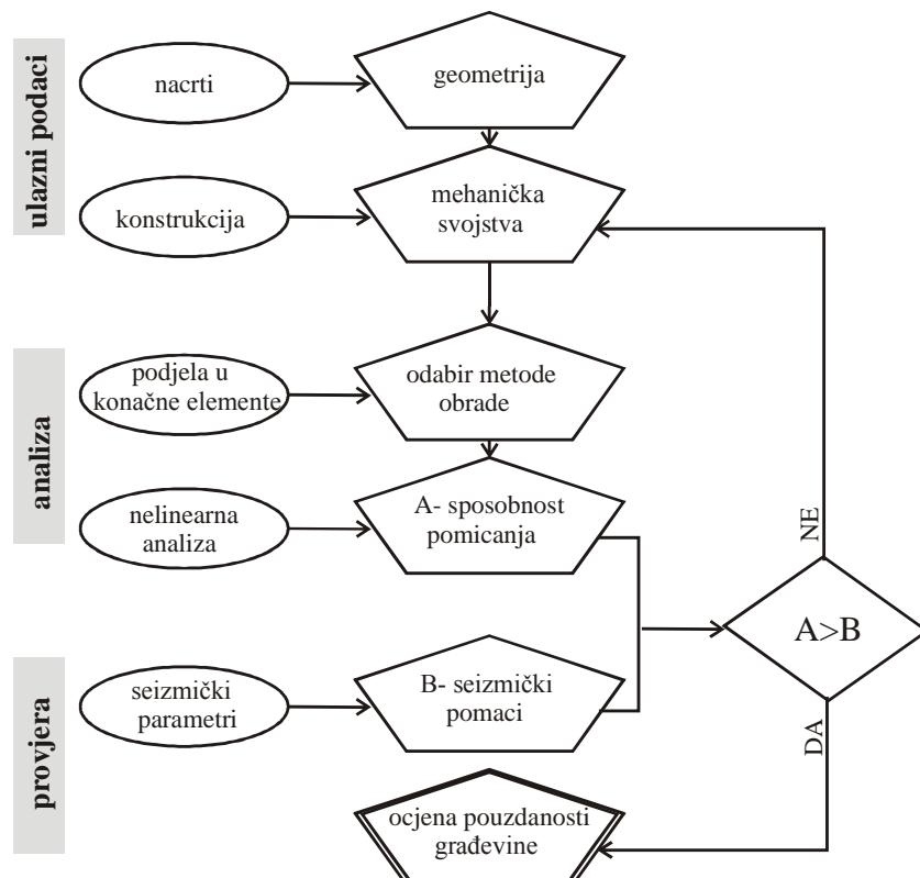
Slika 5.4. Način provjere sposobnosti horizontalne deformacije zgrade
