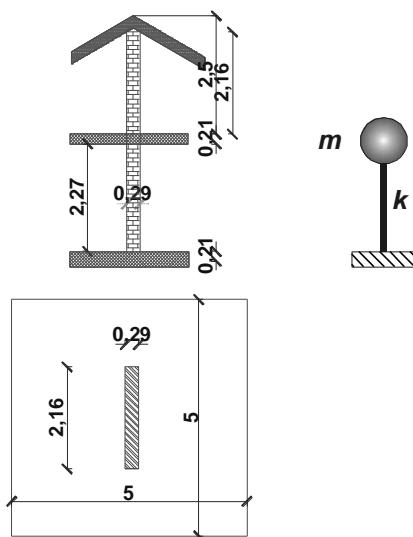
Slika 6.9. Prototip s jednim stupnjem slobode
