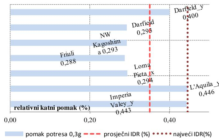
Slika A5. Procijenjeni pomaci jednoetažne građevine gustoće zida  $d_{wA}=5\%$  za potrebe projektnog ubrzanja 0.1g, 0.2g i 0.3g
