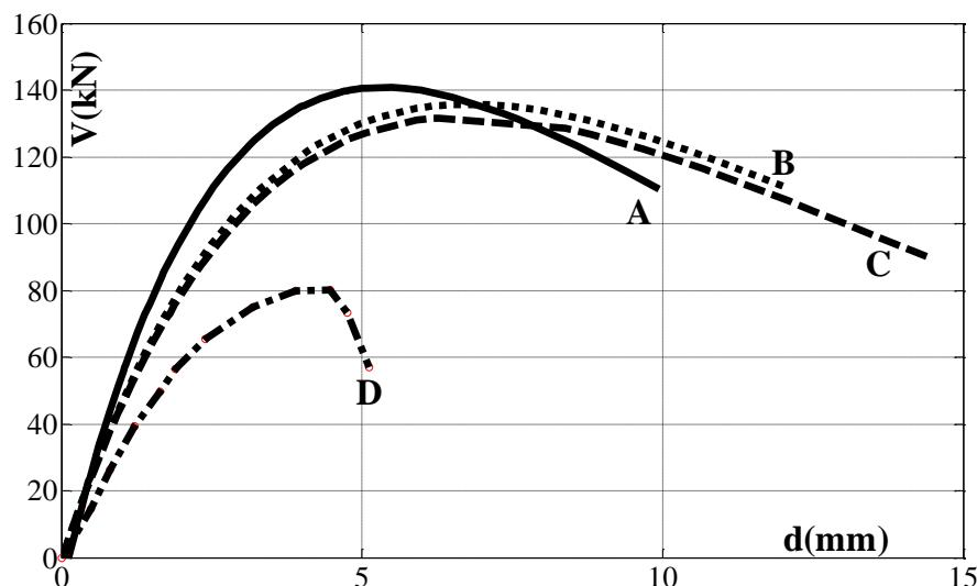
Slika 4.148. Primarne krivulje uzoraka tipa A, B, C i D
