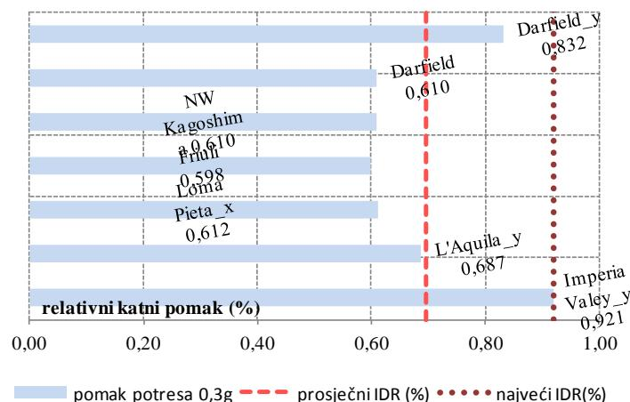
Slika A10. Procijenjeni pomaci dvoetažne građevine gustoće zida  $d_{wA}=4\%$  za potrebe projektnog ubrzanja 0.1g, 0.2g i 0.3g
