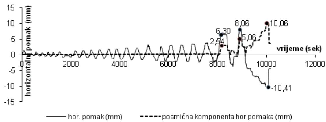
Slika 4.72. Odnos veličine ukupnog mјerenog horizontalnog i pomaka od smicanja uzorka B3
