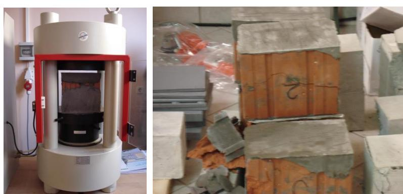
Slika 3.2. Ispitivanje tlačne čvrstoće glinenih šupljih blokova
