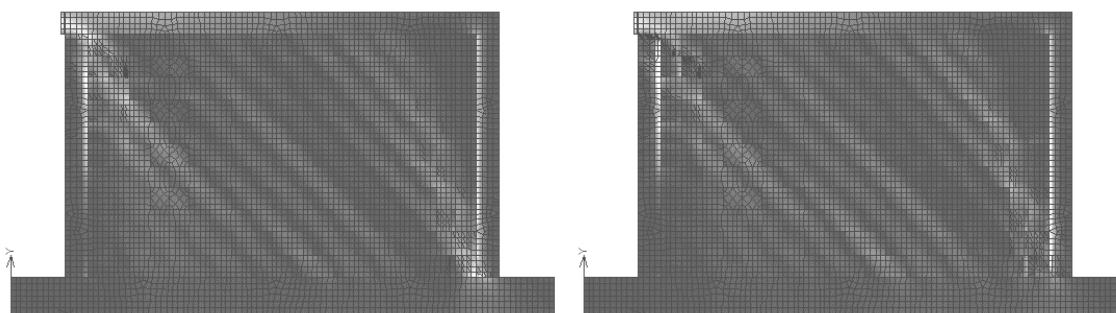
Slika 5.24. Slika glavnih tlačnih naprezanja pri relativnom katnom pomaku od 0,75% i 1.% modela zida E
