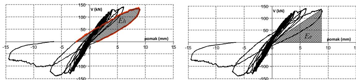
Slika 4.18. Prikaz potrošene energije  $E_h$  i energije idealno elastične deformacije  $E_e$
