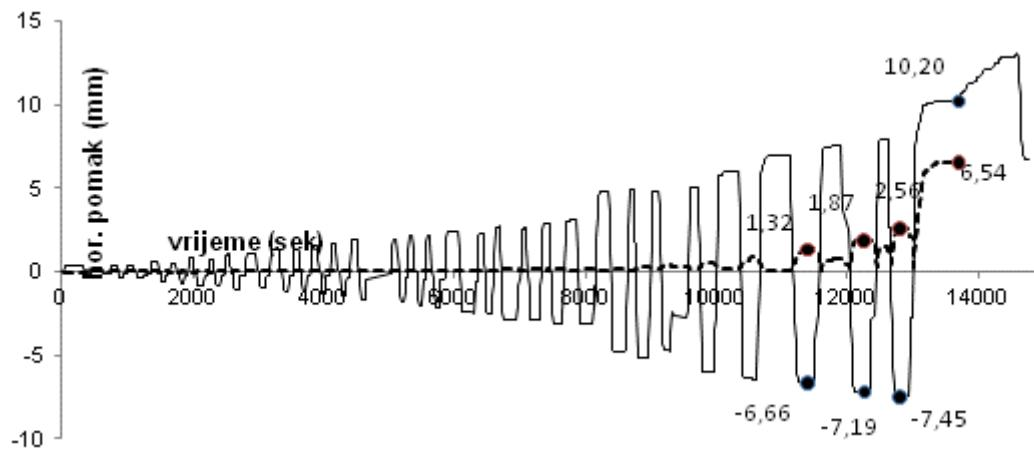
Slika 4.84. Odnos veličine ukupnog mјerenog horizontalnog i pomaka od smicanja uzorka C1
