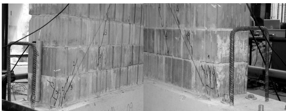
Slika 4.114. Rasprostiranje pukotina po dubini zida uzorka D
