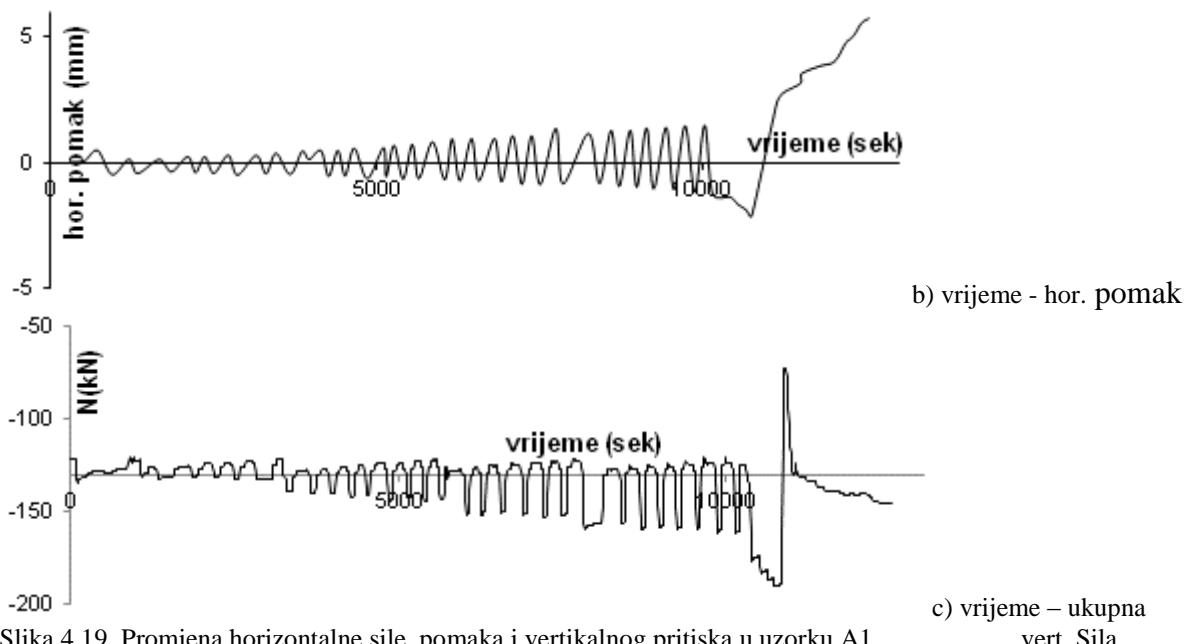
Slika 4.19. Promjena horizontalne sile, pomaka i vertikalnog pritiska u uzorku A1
