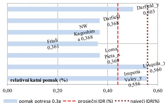
Slika A4. Procijenjeni pomaci jednoetažne građevine gustoće zida  $d_{WA}=4\%$  za potrebe projektnog ubrzanja 0.1g, 0.2g i 0.3g
