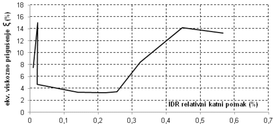
Slika 4.111. Prigušenje uzorka C3
