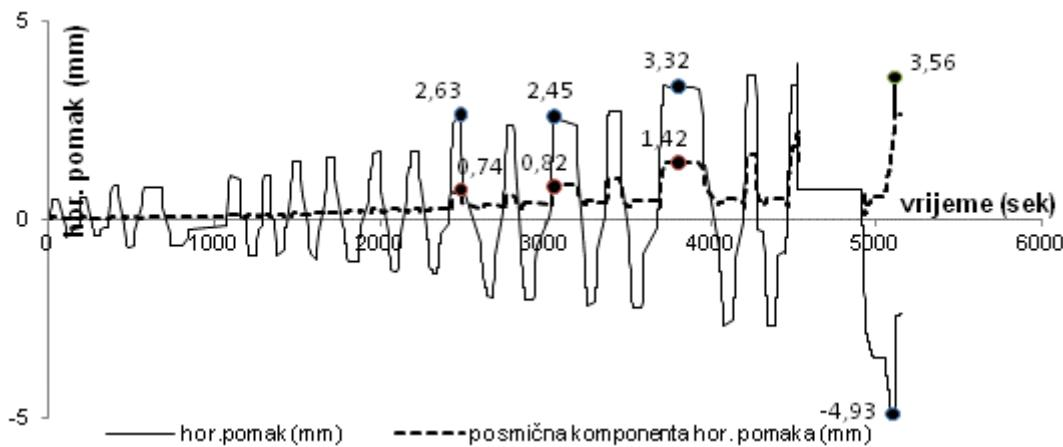
Slika 4.118. Odnos veličine ukupnog mjerенog horizontalnog i pomaka od smicanja uzorka D
