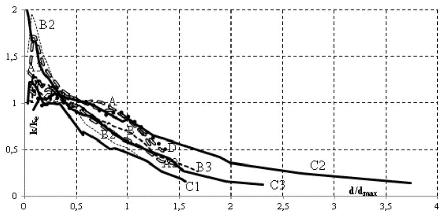
Slika 4.133. Promjena omjera krutosti  $\frac{K}{K_e}$  svih uzoraka ovisnosti o omjeru relativnog pomaka  $\frac{d}{d_{Vax}}$
