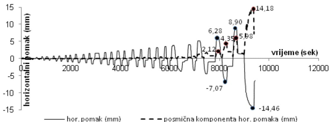
Slika 4.106. Odnos veličine ukupnog mjerенog horizontalnog i pomaka od smicanja uzorka C3
