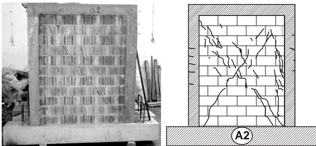
Slika 4.26. Fotografija i crtež pukotina ispitanih uzorka A2
