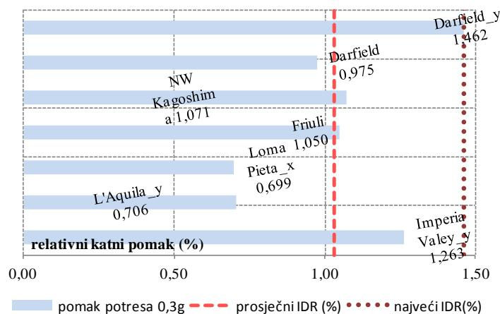
Slika A22. Procijenjeni pomaci četveroetažne građevine gustoće zida  $d_{wA}=4\%$  za potrebe projektnog ubrzanja 0.1g, 0.2g i 0.3g
