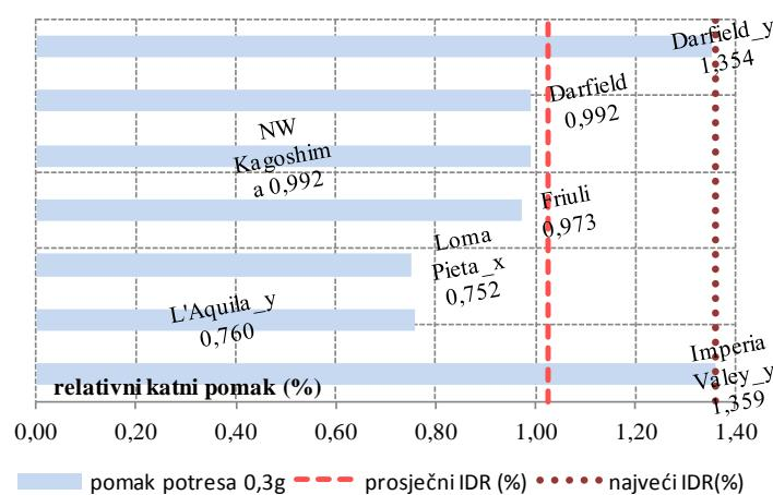
Slika A15. Procijenjeni pomaci troetažne građevine gustoće zida  $d_{wA}=3\%$  za potrebe projektnog ubrzanja 0.1g, 0.2g i 0.3g
