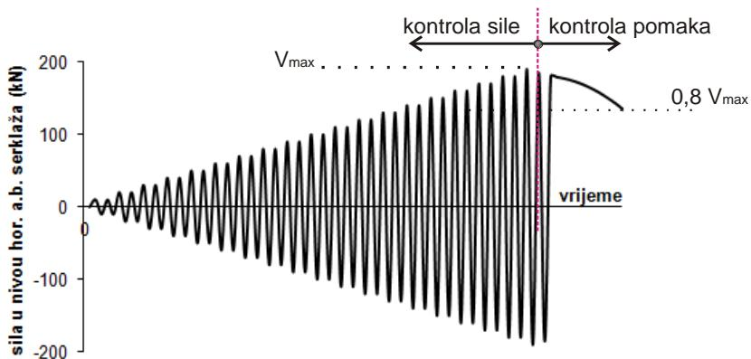
Slika 1.7. Naizmjenična horizontalna sila na vrhu zida
