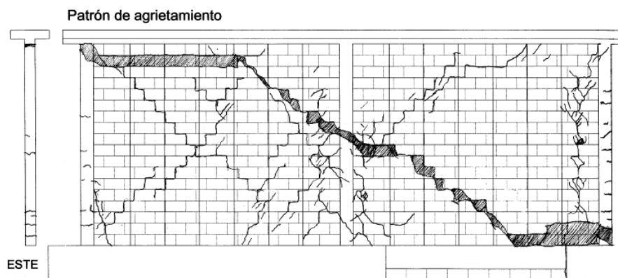
Slika 2.3. Slika pukotina eksperimentalno ispitovanog omeđenog zida ( Perez-Gavilan 2009.)
