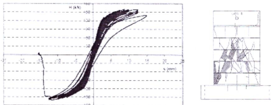
Slika 4.124. Histerezna petlja i slika pukotina savojnog mehanizma sloma
