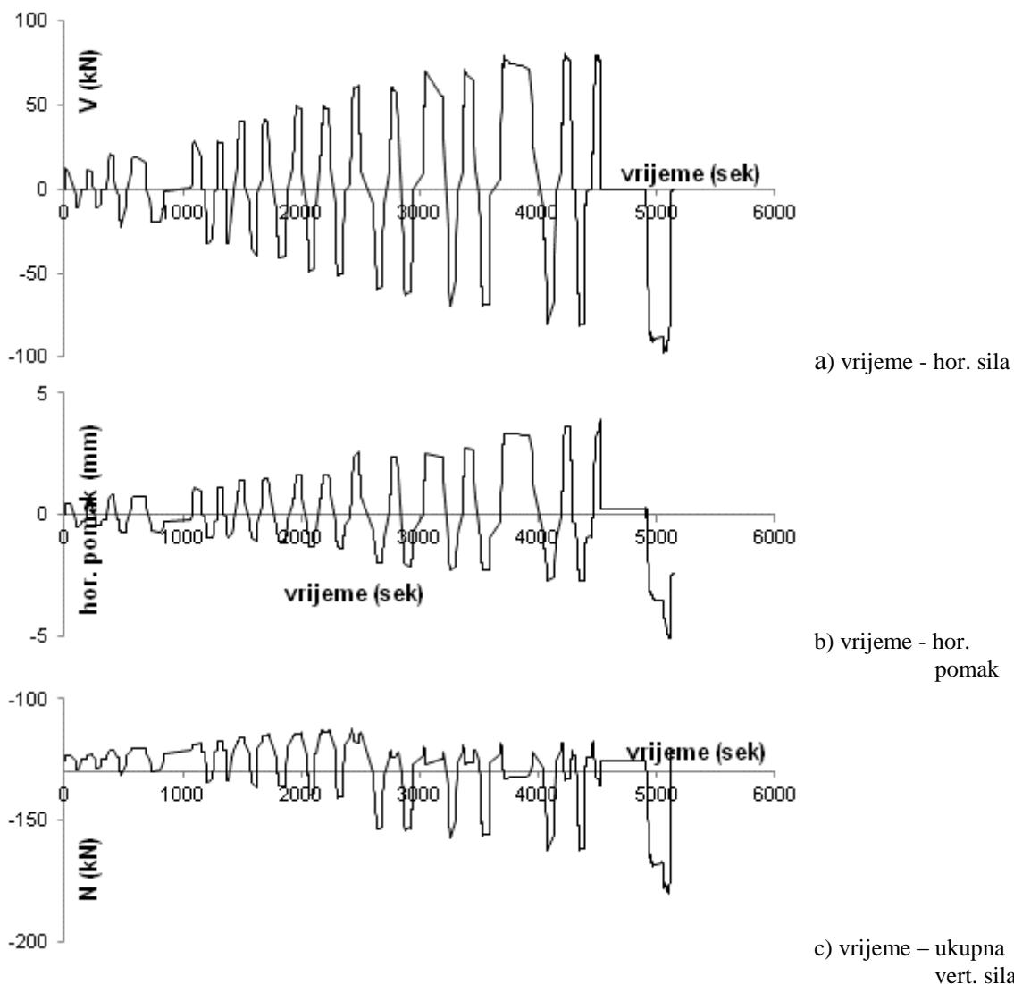
Slika 4.112. Promjena horizontalne sile, pomaka i vertikalnog pritiska
