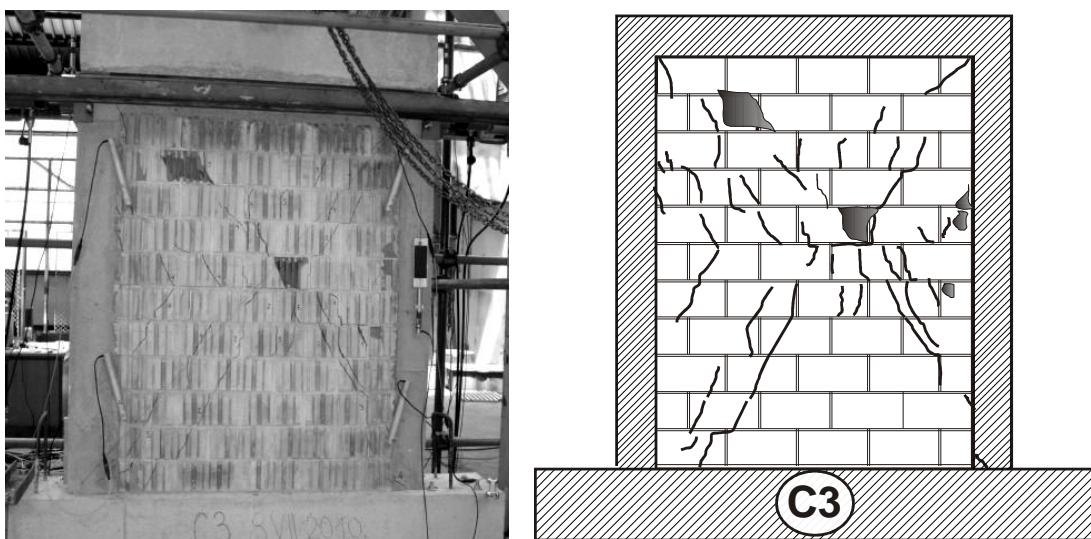
Slika 4.102. Fotografija i crtež pukotina ispitanih uzorka C3
