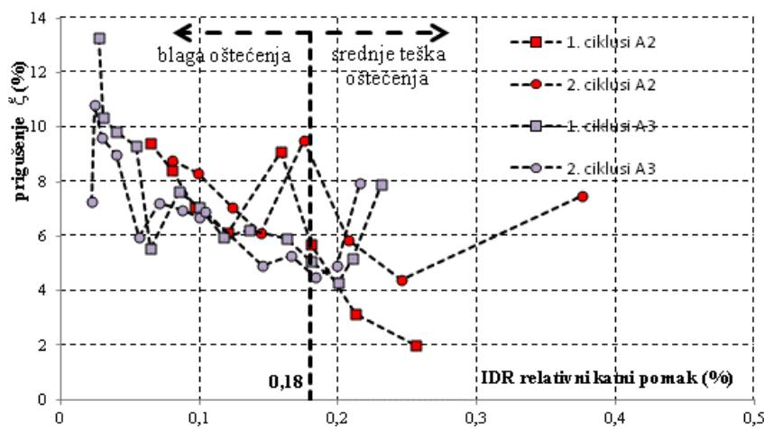
Slika 4.137. Prigušenje uzorka tipa A
