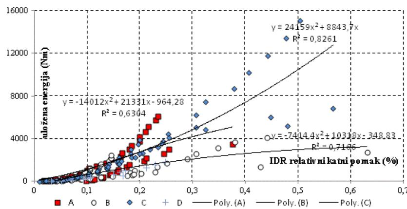
Slika 4.135. Ukupno uložena energija do granice teških oštećenja za tipove uzoraka A, B, C i D
