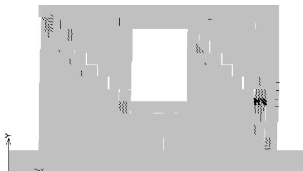
Slika 5.37. Slika deformacija i pukotina većih od 0,1mm pri relativnom katnom pomaku od 0,7% (hor. pomici povećani 3 puta) modela zida G
