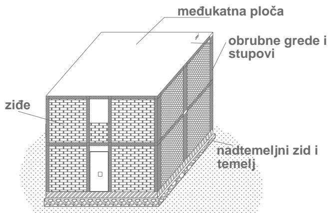
Slika 2.1. Konstruktivni elementi zgrade od omeđenog zida
