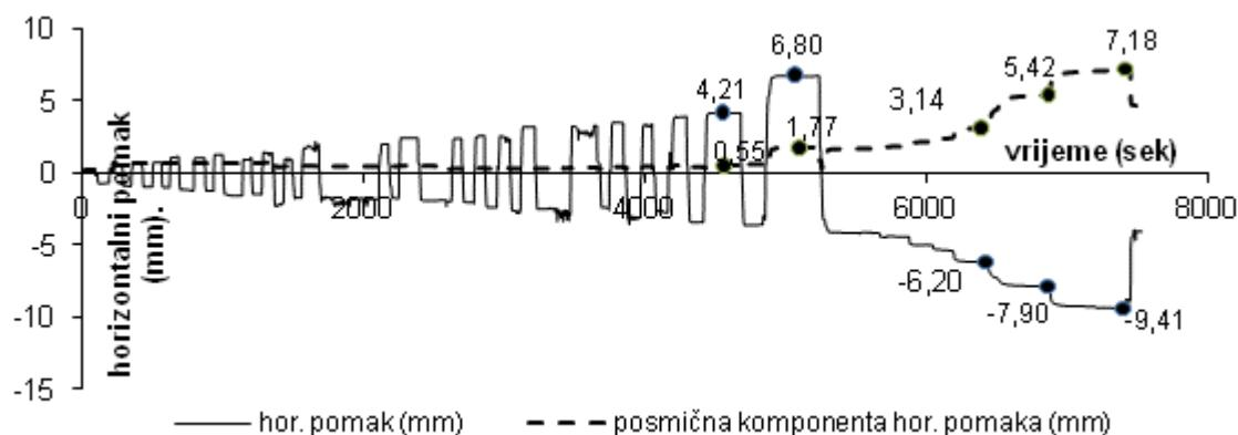
Slika 4.30. Odnos veličine ukupnog mjerenog horizontalnog i pomaka od smicanja uzorka A2
