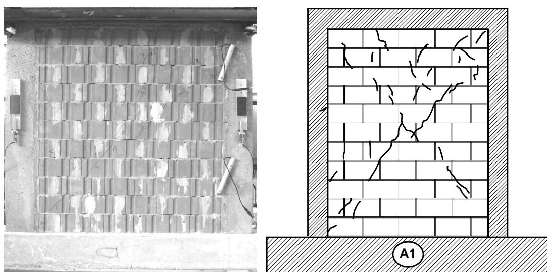
Slika 4.20. Fotografija i crtež pukotina ispitovanog uzorka A1
