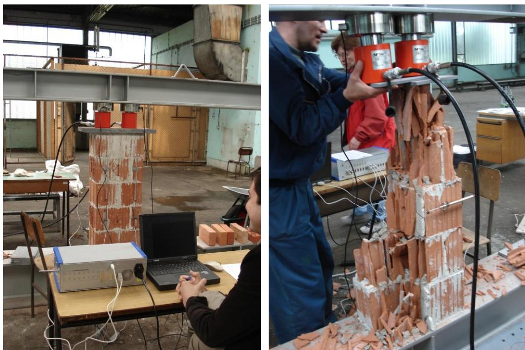
Slika 3.4. Ispitivanje tlačne čvrstoće zida
