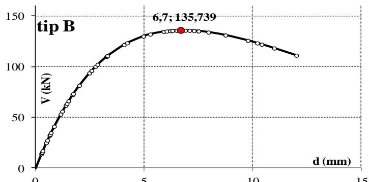
Slika 4.145. Primarna krivulja uzorka tipa „B“
