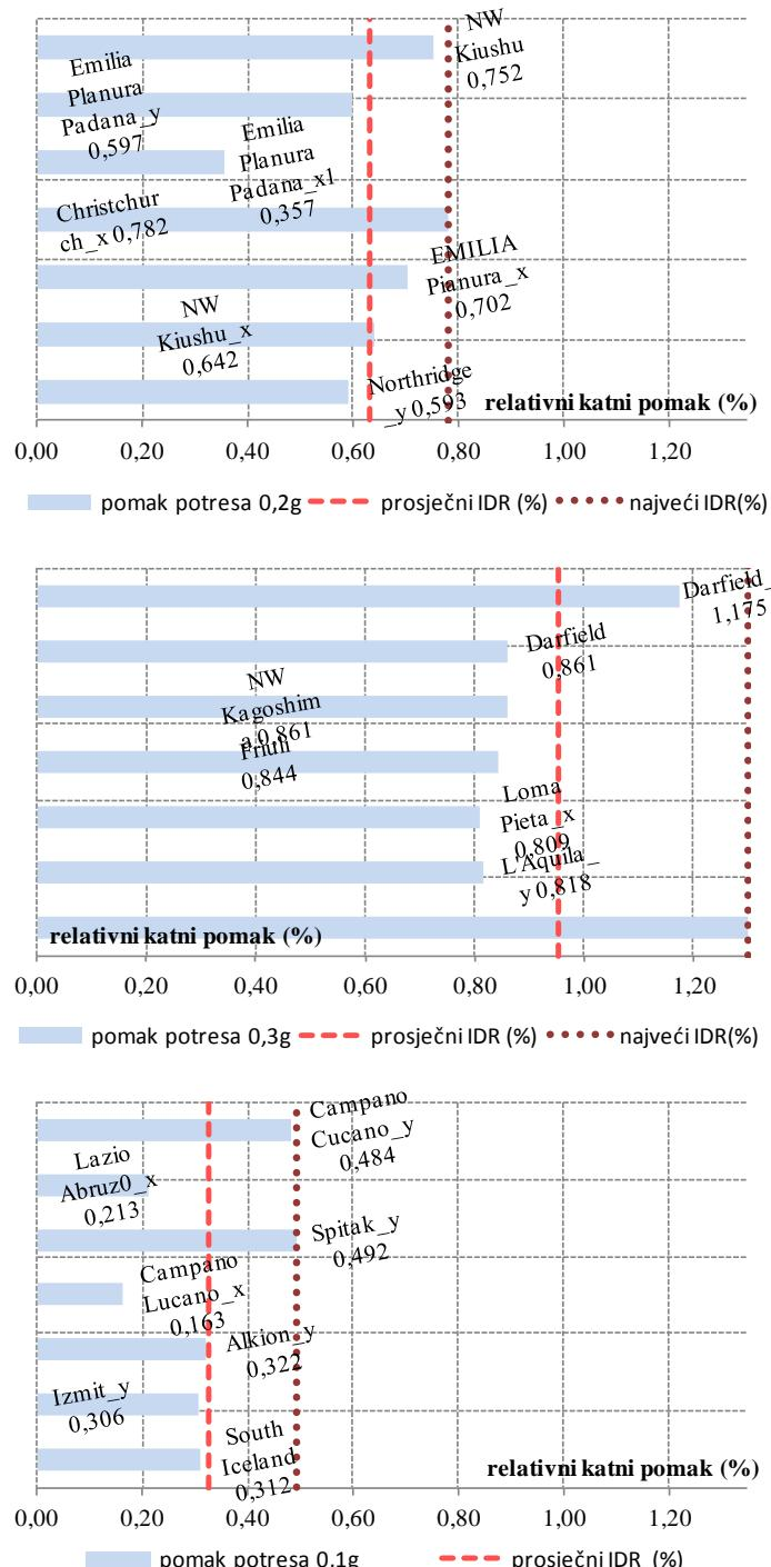
Slika A8. Procijenjeni pomaci dvoetažne građevine gustoće zida  $d_{wA}=2,46\%$  za potrebe projektnog ubrzanja 0.1g, 0.2g i 0.3g
