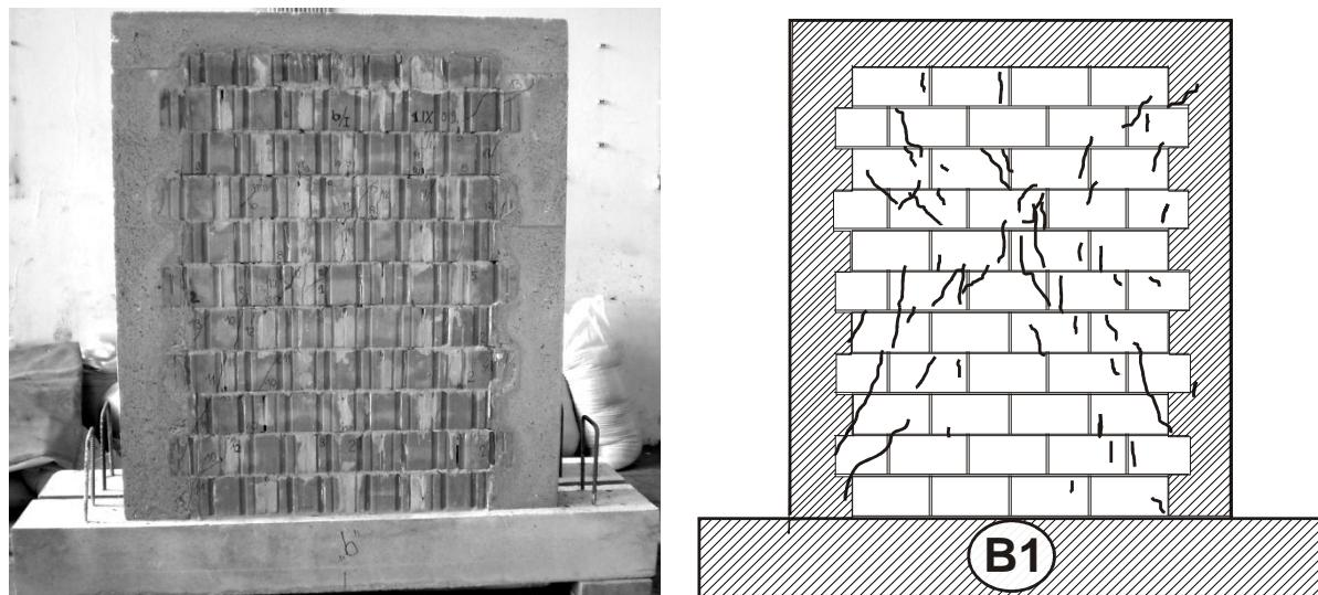
Slika 4.47. Fotografija i crtež pukotina ispitanog uzorka B1
