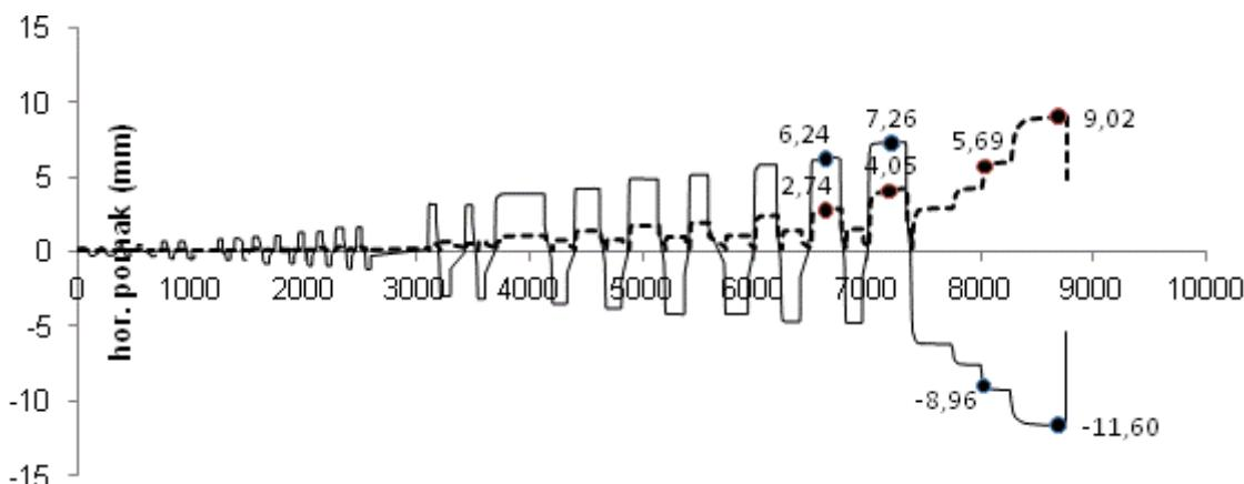
Slika 4.61. Odnos veličine ukupnog mjerenoj horizontalnog i pomaka od smicanja
