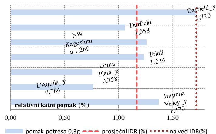
Slika A21. Procijenjeni pomaci četveroetažne građevine gustoće zida  $d_{wA}=3\%$  za potrebe projektnog ubrzanja 0.1g, 0.2g i 0.3g
