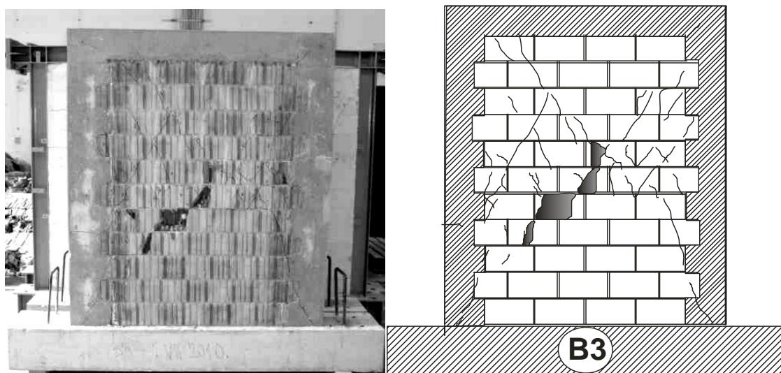
Slika 4.68. Fotografija i crtež pukotina ispitanih uzorka B3
