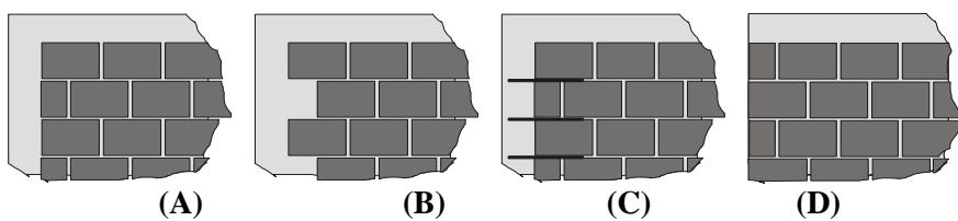
Slika 4.2. Detalji povezivanja zida i vertikalnih serklaža : tip A, B, C, D
