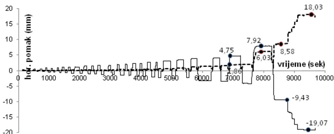
Slika 4.95. Odnos veličine ukupnog mjereno horizontalnog i pomaka od smicanja u uzorku C2
