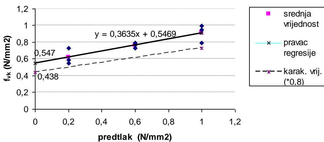
Slika 3.6. Posmična čvrstoća zida
