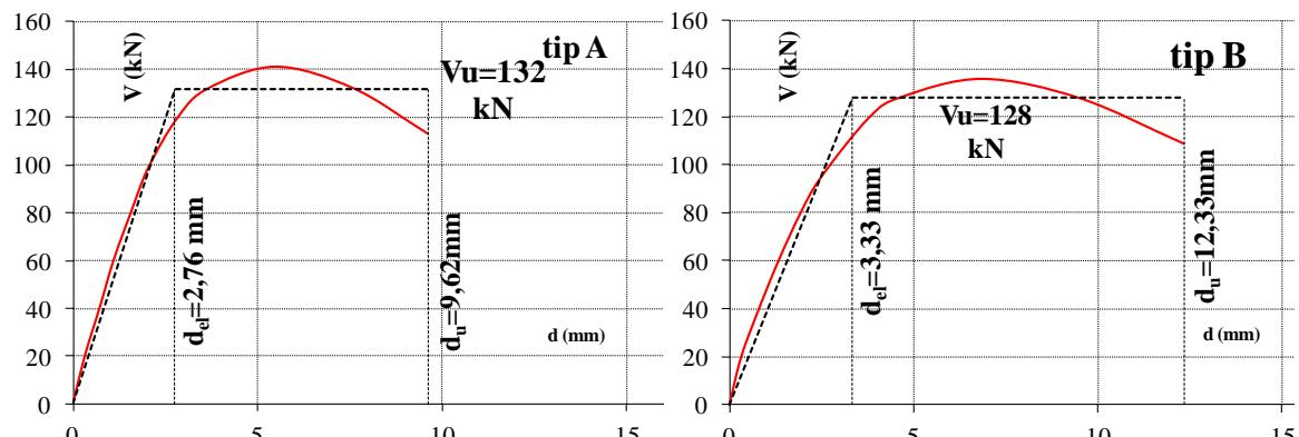
Slika 4.149. Bilinearne idealizacije osnovnih krivulja nosivosti uzoraka tipa A i B
