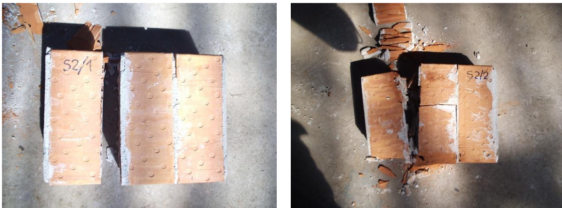
Slika 2.20. Pravilan (lijevo) i nepravilan slom (desno) uzorka
