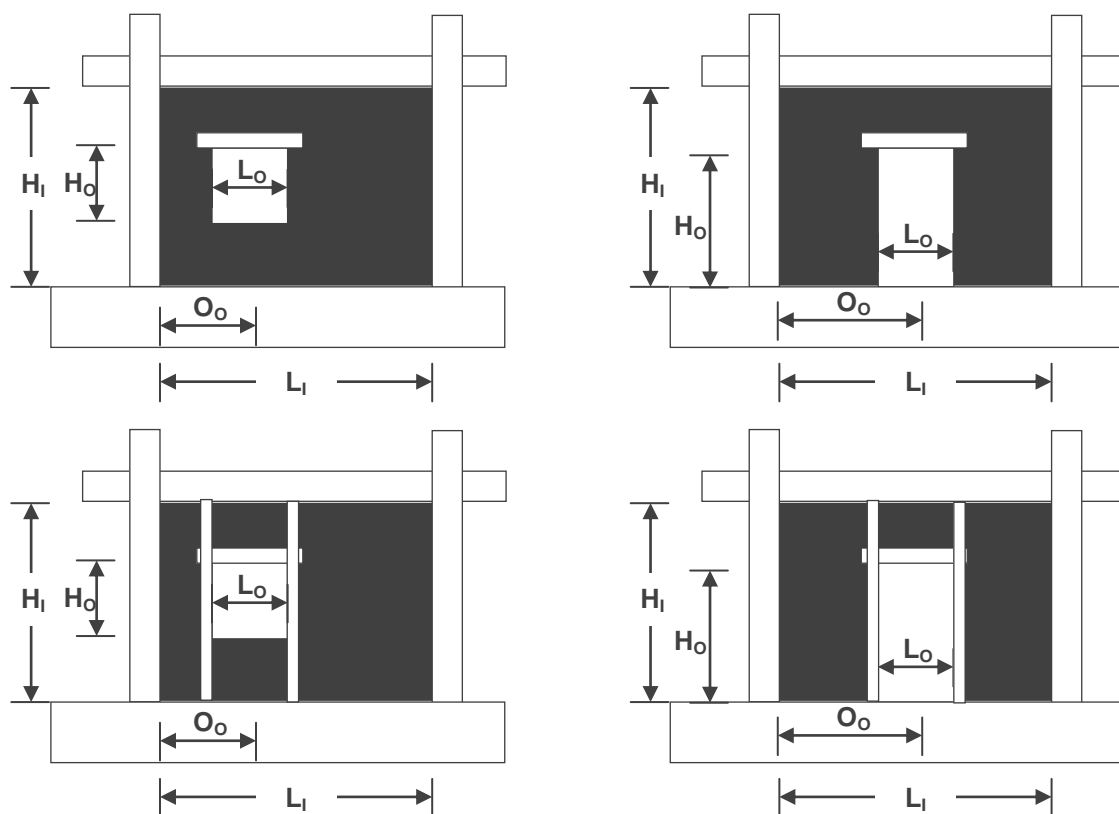
Slika 10.2. Otvor u ispunu s osnovnim izmjerama
