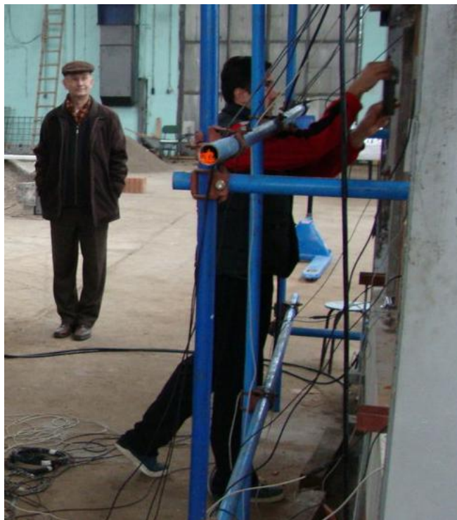
Slika 10.1. Postavljanje mjernih uređaja tijekom pripreme ispitivanja
