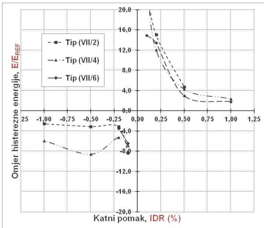
Slika 7.6. Histerezna energija numeričkih modela grupe VII,  $E$  (kNmm) i omjer energije,  $E/E_{REF}$  u odnosu na energiju praznog okvira pri jednakom katnom pomaku, IDR (%)
