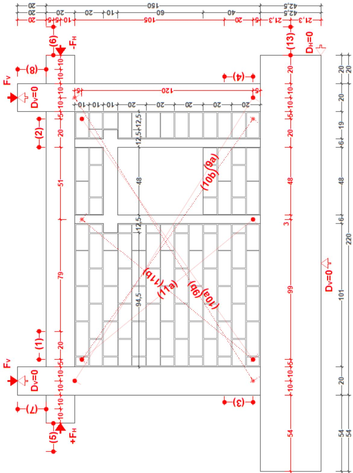
Slika 2.35. Raspored mjernih uređaja i rubni uvjeti za uzorak tip (II/4)
