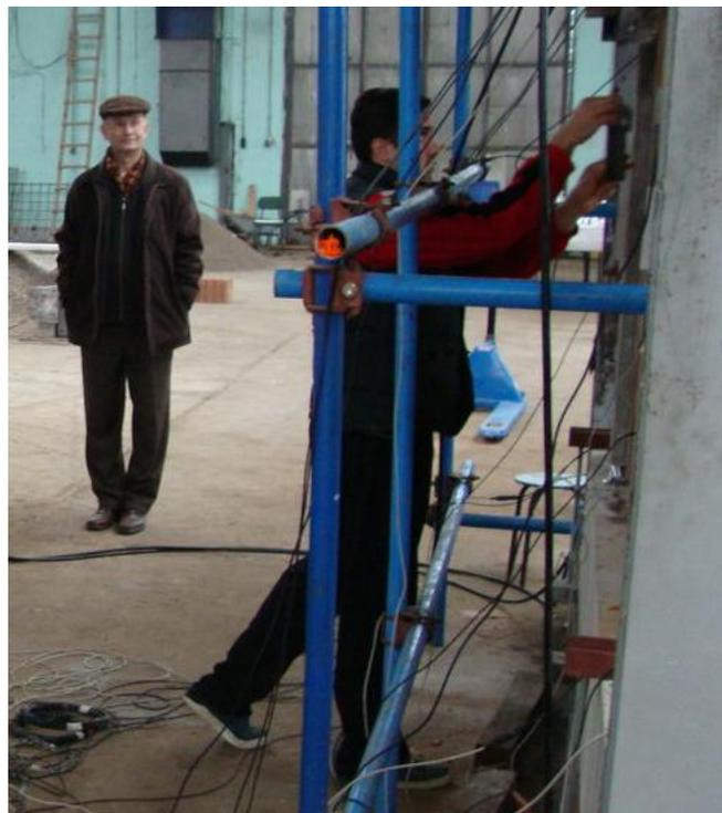
**Slika 10.1.** Postavljanje mjernih uređaja tijekom pripreme ispitivanja
