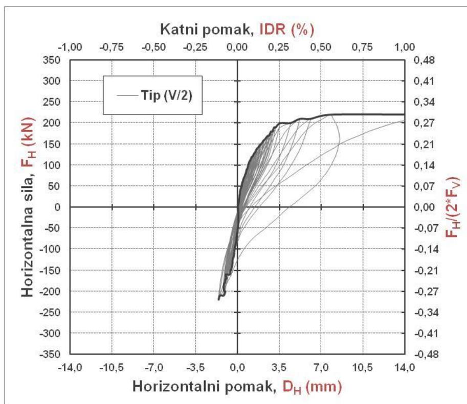
Slika 6.35. Histerezna petlja i primarna krivulja odnosa horizontalnih sila i pomaka numeričkih modela a) tip (V/1) i b) tip (V/2)
