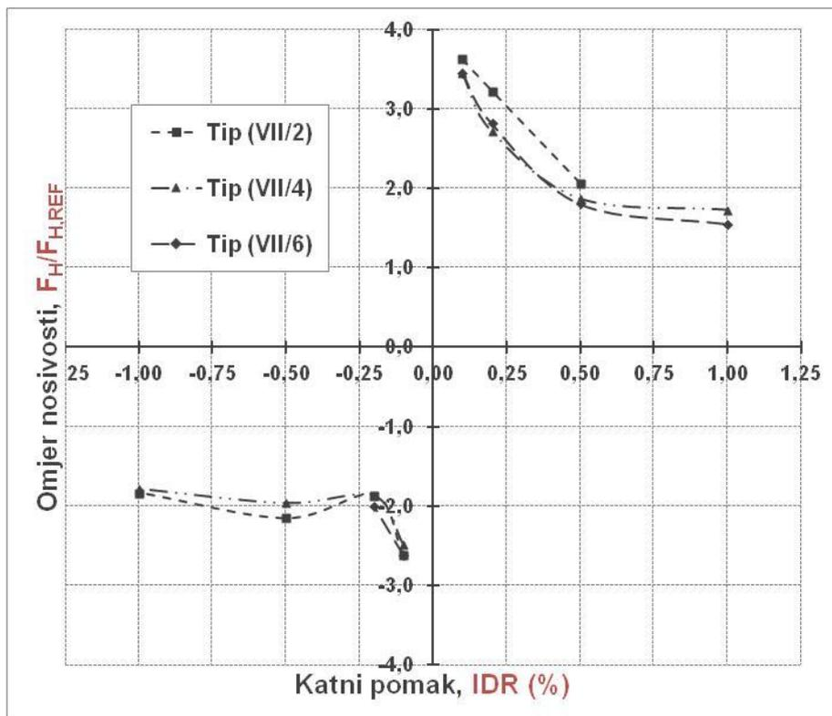
Slika 7.4. Nosivost numeričkih modela grupe VII,  $F_H$  (kN) i omjer nosivosti,  $F_H/F_{H,REF}$  u odnosu na nosivost praznog okvira pri jednakom katnom pomaku, IDR (%)
