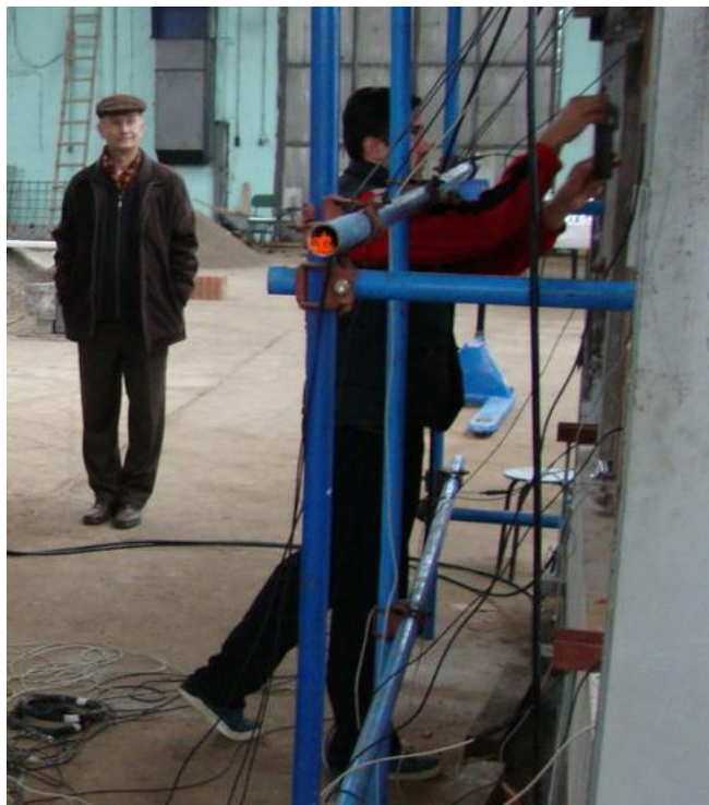
Slika 10.1. Postavljanje mjernih uređaja tijekom pripreme ispitivanja
