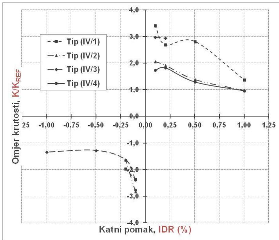
Slika 6.44. Krutost numeričkih modela grupe IV,  $K$  (kN/mm) i omjer nosivosti,  $K/K_{REF}$  u odnosu na nosivost praznog okvira pri jednakom katnom pomaku, IDR (%)
