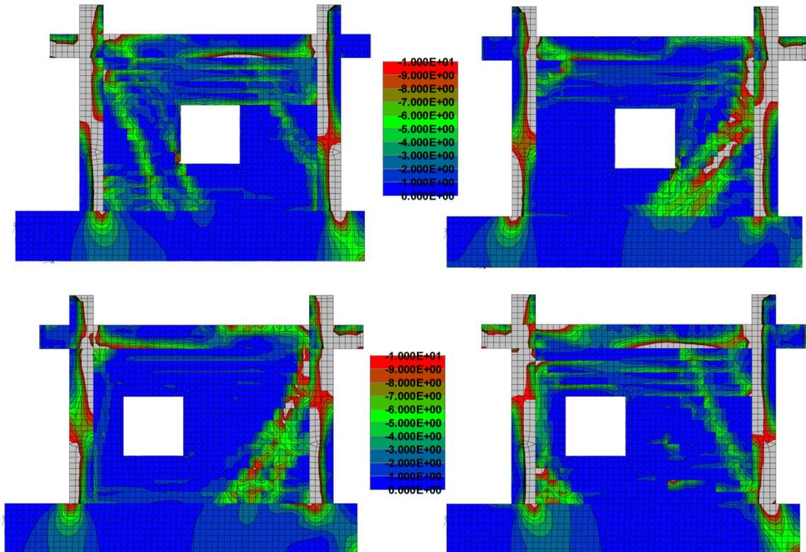
Slika 6.7. Raspodjela glavnih tlačnih naprezanja pred slom za IDR=1,0 % modela tip (IV/5) gore i tip (IV/6) dolje
