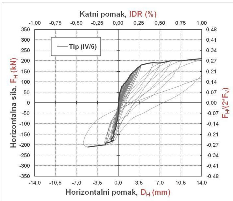
Slika 6.31. Histerezna petlja i primarna krivulja odnosa horizontalnih sila i pomaka numeričkih modela a) tip (IV/5) i b) tip (IV/6)
