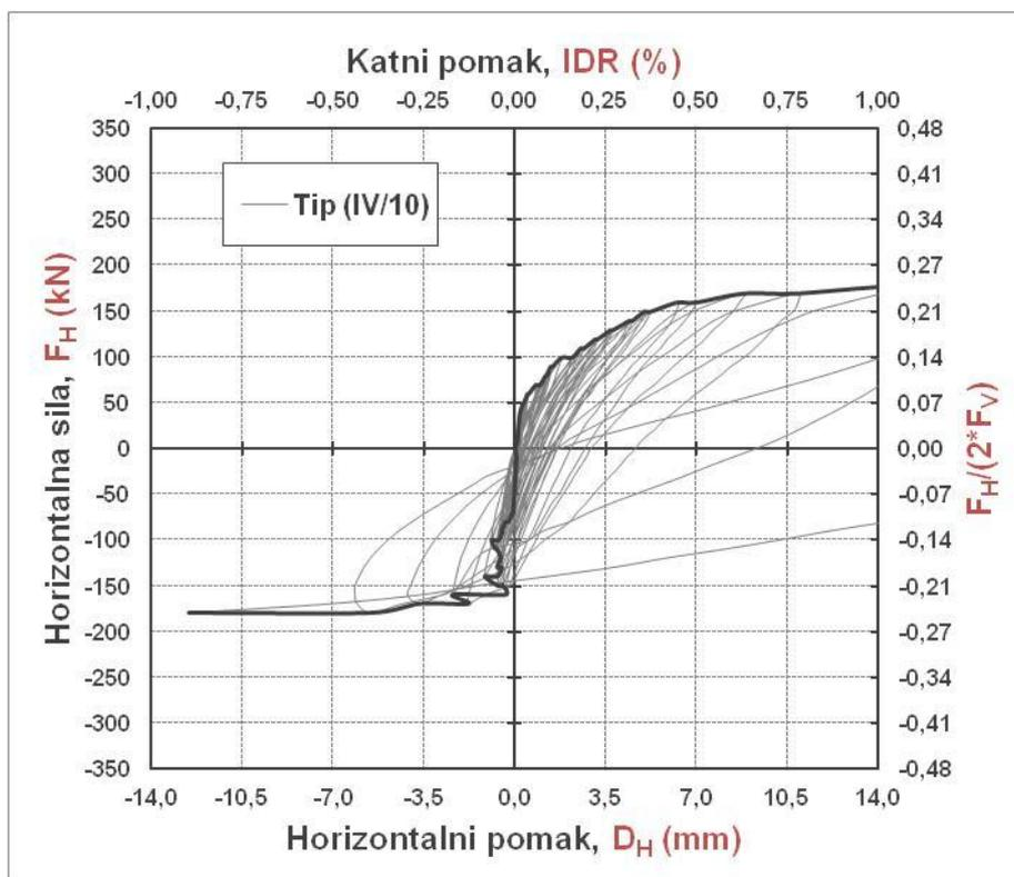
Slika 6.33. Histerezna petlja i primarna krivulja odnosa horizontalnih sila i pomaka numeričkih modela a) tip (IV/9) i b) tip (IV/10)
