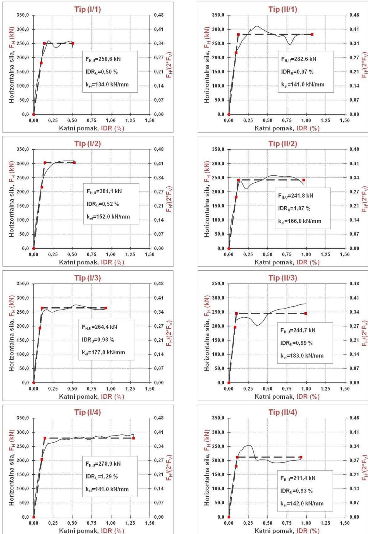
Slika 3.15. Pojednostavljene primarne krivulje pozitivnih ciklusa uzoraka grupe I i II
