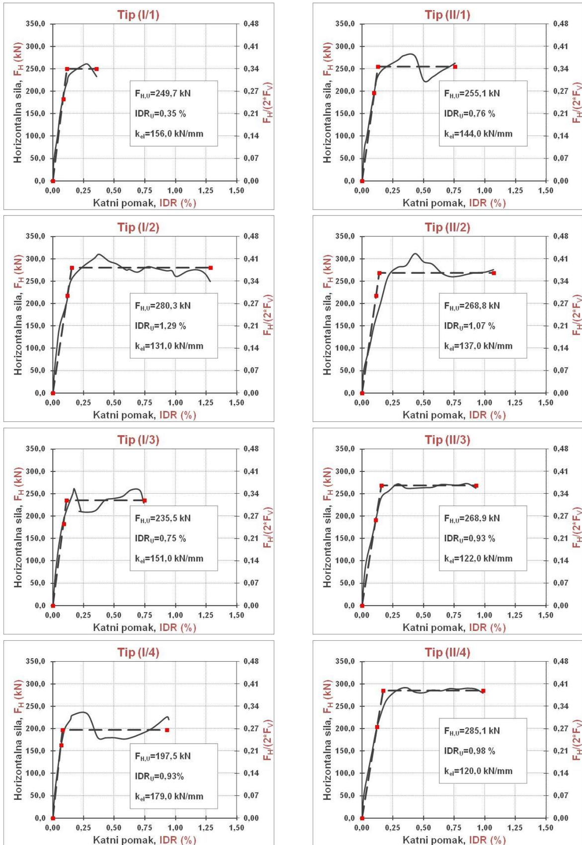
Slika 3.16. Pojednostavljene primarne krivulje negativnih ciklusa uzoraka grupe I i II
