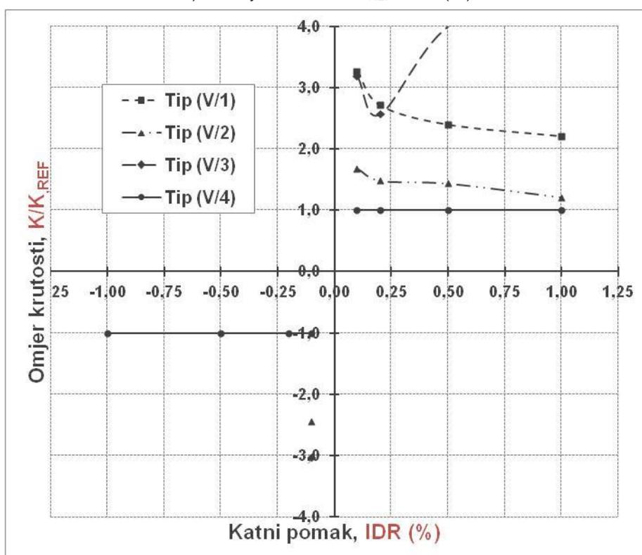
Slika 6.47. Krutost numeričkih modela grupe V,  $K$  (kN/mm) i omjer nosivosti,  $K/K_{REF}$  u odnosu na nosivost praznog okvira pri jednakom katnom pomaku, IDR (%)
