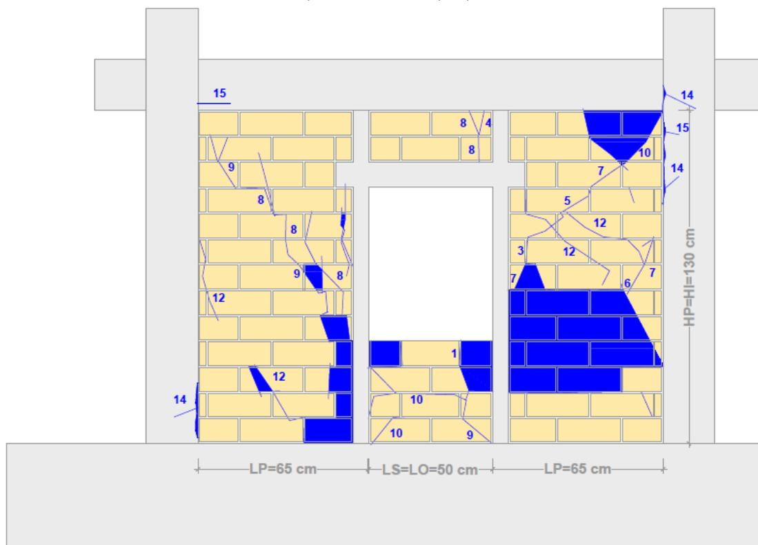
Slika 3.6. Prikaz pukotina pred slom i izmjere dijelova na koje se zidani ispun razložio za uzorke: a) tip (II/1) i b) tip (II/2)
