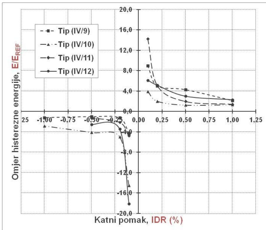
Slika 6.51. Histerezna energija numeričkih modela grupe IV,  $E$  (kNm) i omjer energije,  $E/E_{REF}$  u odnosu na energiju praznog okvira pri jednakom katnom pomaku,  $IDR$  (%)
