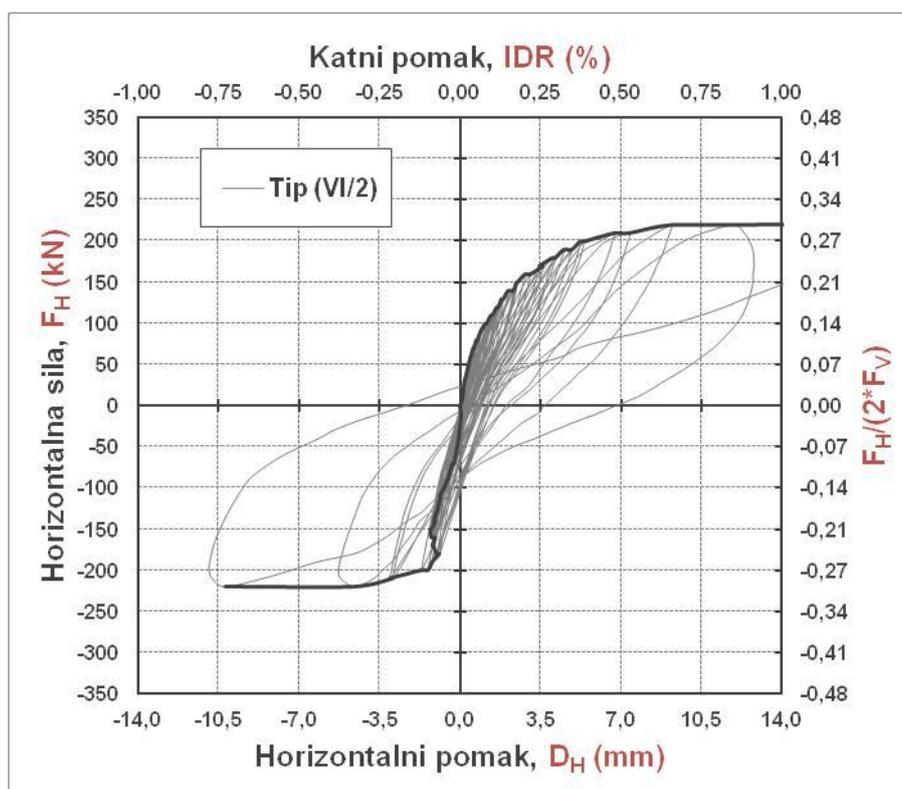
Slika 6.37. Histerezna petlja i primarna krivulja odnosa horizontalnih sila i pomaka numeričkih modela a) tip (VI/1) i b) tip (VI/2)
