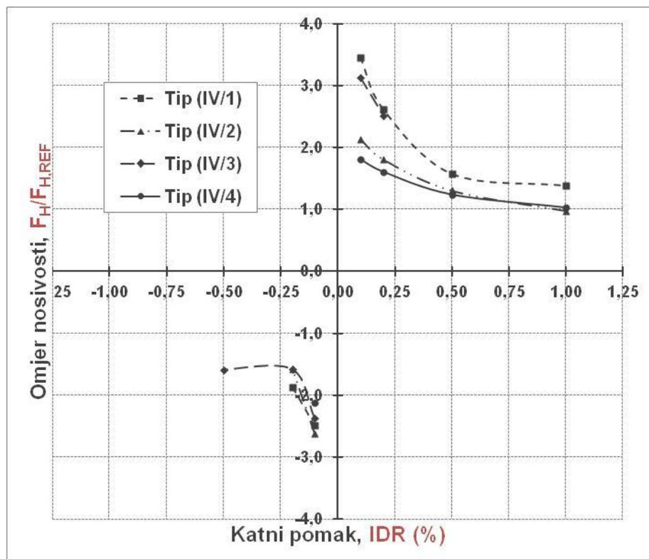
Slika 6.39. Nosivost numeričkih modela grupe IV,  $F_H$  (kN) i omjer nosivosti,  $F_H/F_{H,REF}$  u odnosu na nosivost praznog okvira pri jednakom katnom pomaku, IDR (%)
