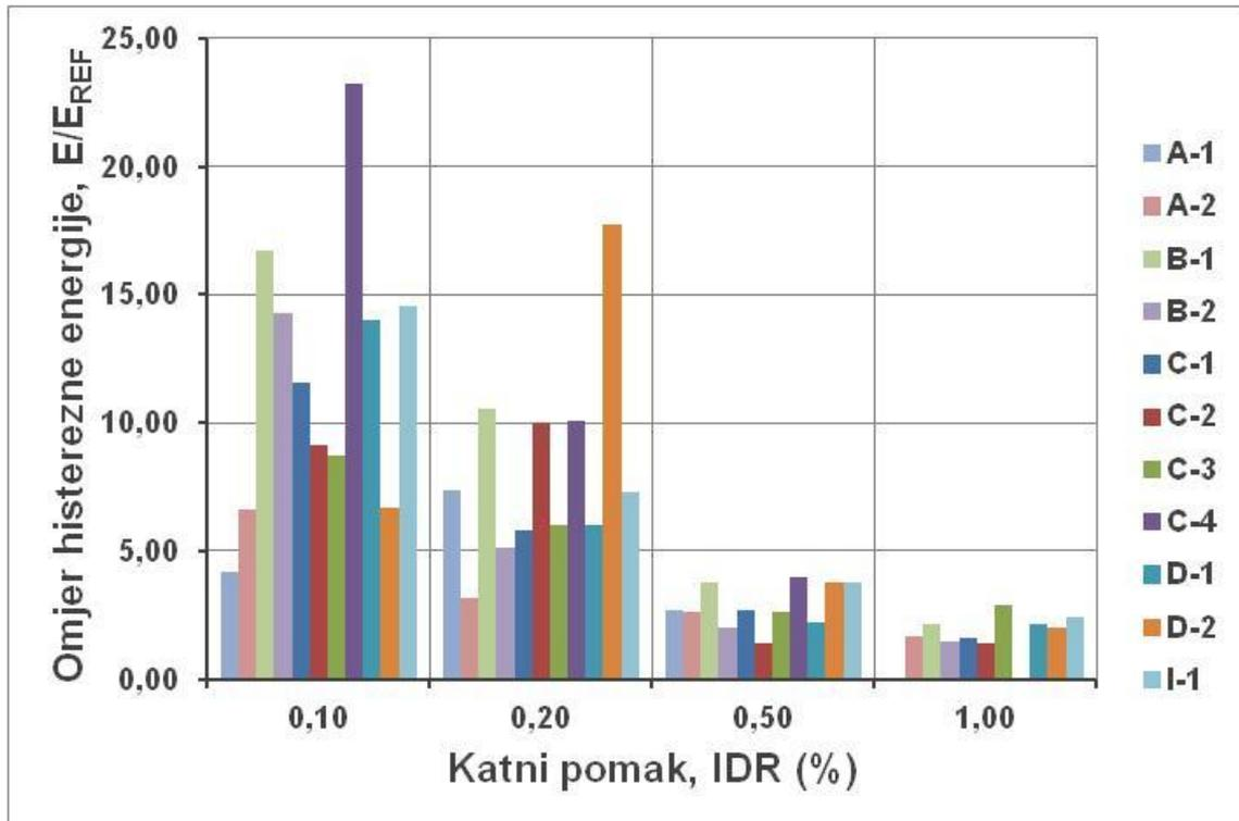
Slika 8.13. Usporedba faktora utjecaja na histereznu energiju za zidane ispune odnosa stranica  $\alpha=H_i/L_i=0,72$ , s otvorom smještenim u sredini raspona,  $O_o=L_i/2$ , u odnosu na katne pomake IDR (%)
