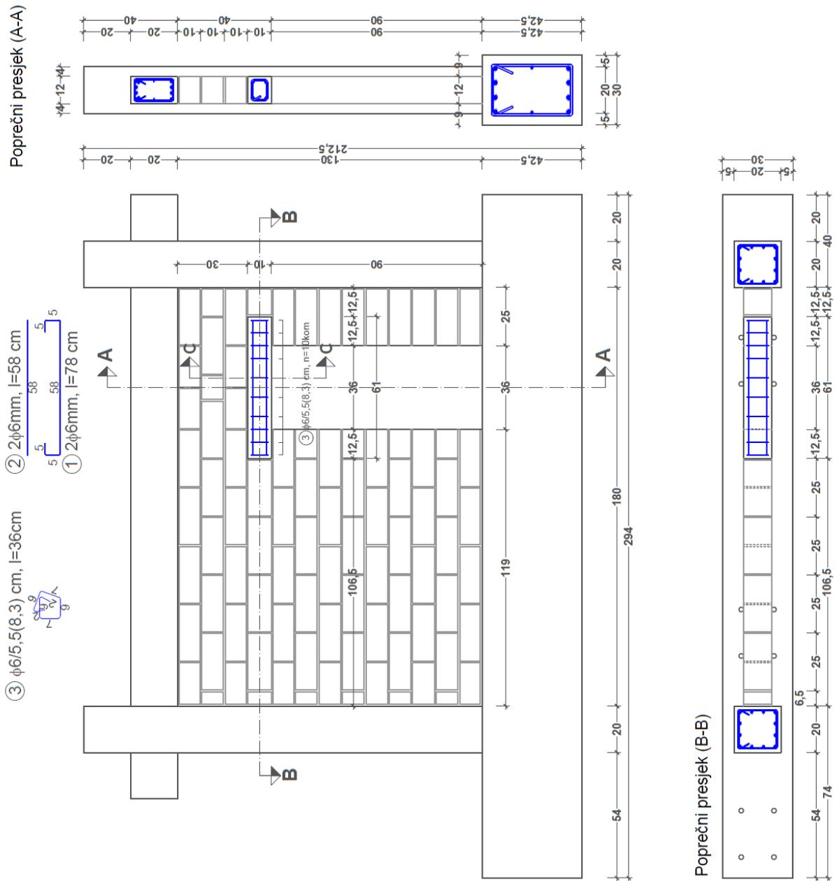
Slika 2.7. Izmjere i plan armature uzorka tip (I/3) u cm
