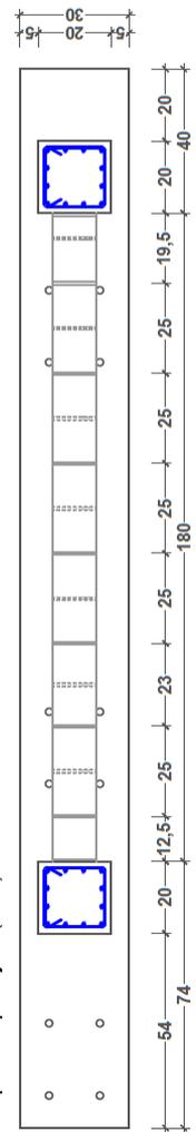
Slika 2.13. Izmjere uzorka tip (III/2) u cm
