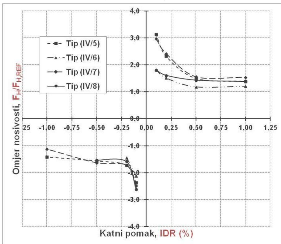
Slika 6.40. Nosivost numeričkih modela grupe IV,  $F_H$  (kN) i omjer nosivosti,  $F_H/F_{H,REF}$  u odnosu na nosivost praznog okvira pri jednakom katnom pomaku, IDR (%)
