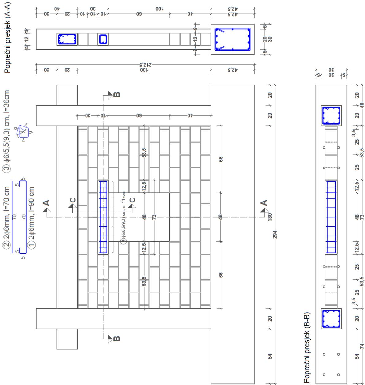
Slika 2.6. Izmjere i plan armature uzorka tip (I/2) u cm
