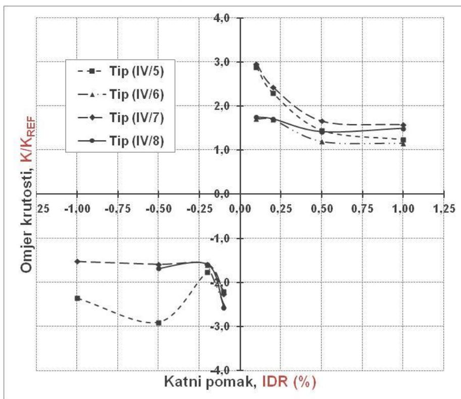
Slika 6.45. Krutost numeričkih modela grupe IV,  $K$  (kN/mm) i omjer nosivosti,  $K/K_{REF}$  u odnosu na nosivost praznog okvira pri jednakom katnom pomaku, IDR (%)
