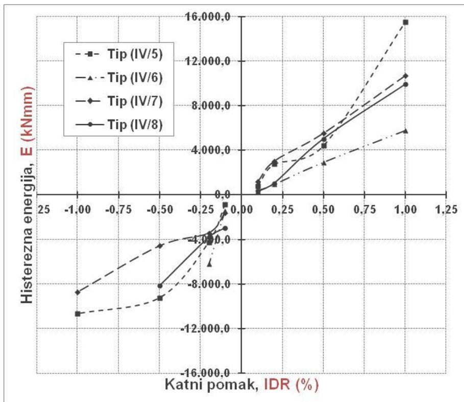
Slika 6.50. Histerezna energija numeričkih modela grupe IV,  $E$  (kNm) i omjer energije,  $E/E_{REF}$  u odnosu na energiju praznog okvira pri jednakom katnom pomaku, IDR (%)
