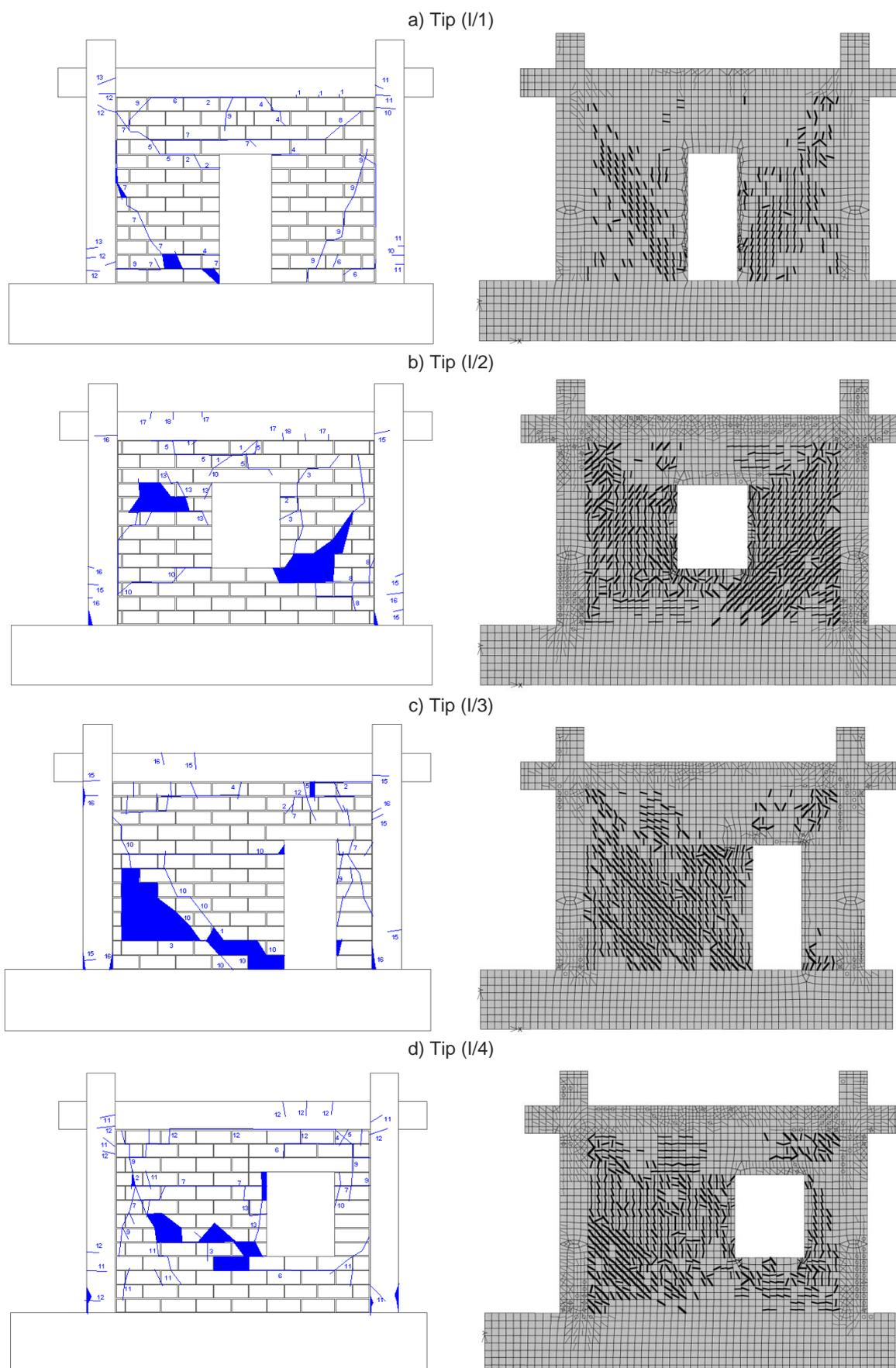
Slika 5.16. Usporedba eksperimentalnih (lijevo) i numeričkih rezultata (desno) ispitnih uzoraka:
