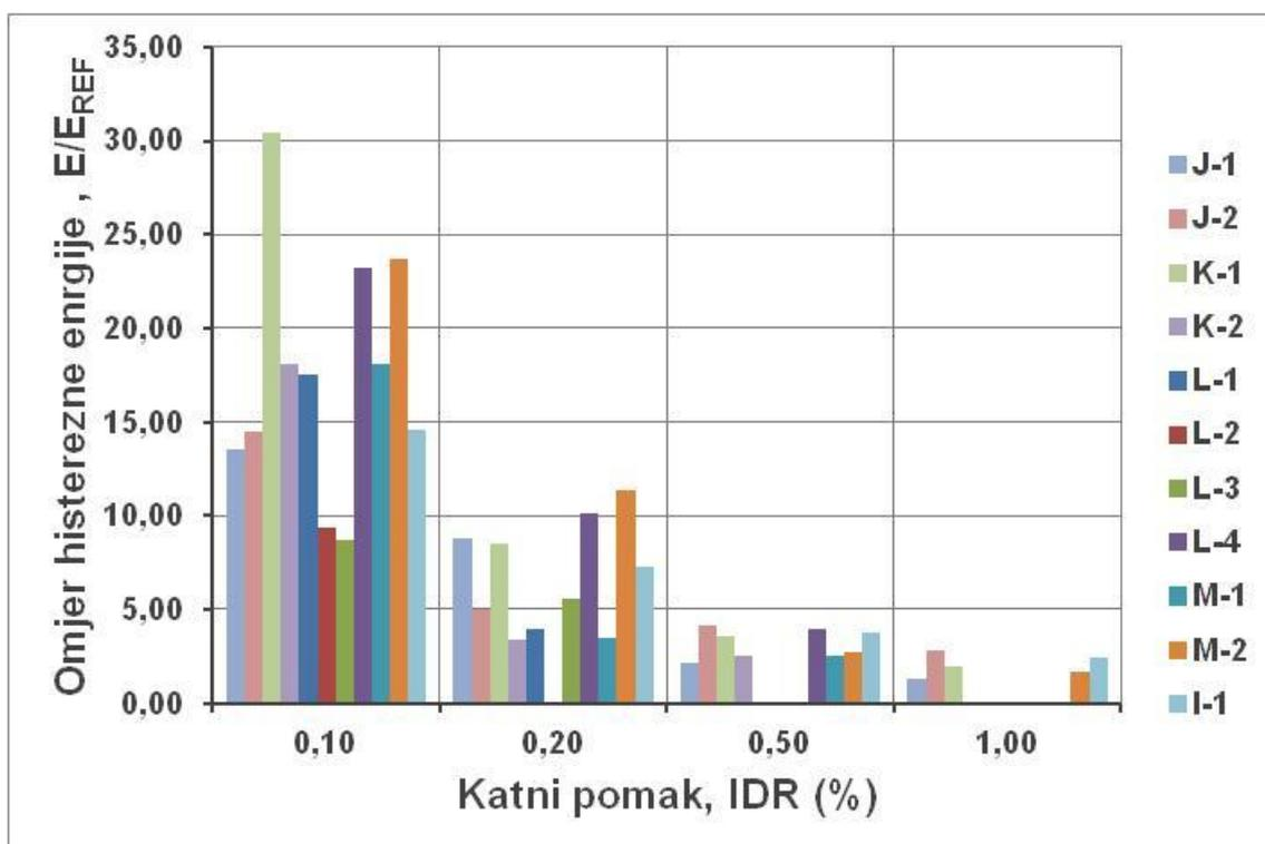
Slika 8.15. Usporedba faktora utjecaja na histereznu energiju za zidane ispune odnosa stranica  $H_f/L_f=0,72$ , s otvorom smještenim s odklonom,  $O_o=L_f-(H_f/5+L_o/2)$ , u odnosu na katne pomake IDR (%)
