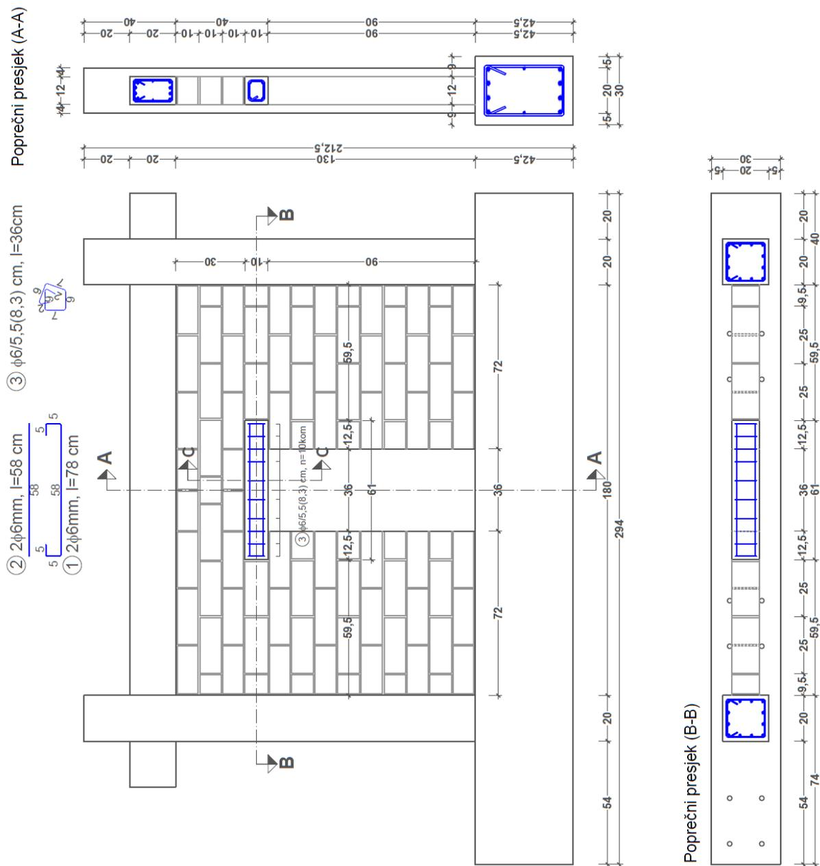
Slika 2.5. Izmjere i plan armature uzorka tip (I/1) u cm
