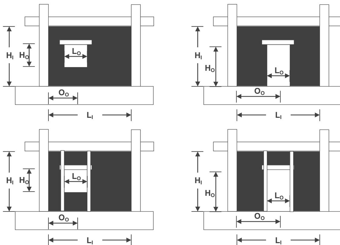
Slika 10.2. Otvor u ispunu s osnovnim izmjerama
