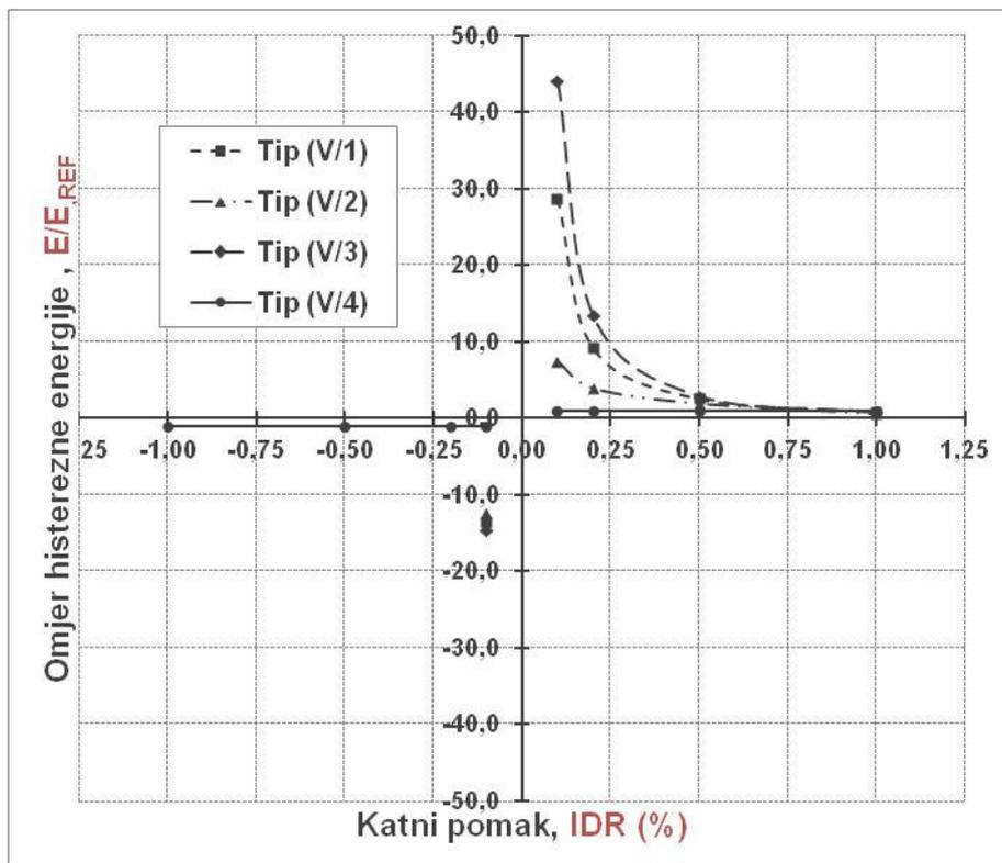
Slika 6.51. Histerezna energija numeričkih modela grupe V,  $E$  (kNmm) i omjer energije,  $E/E_{REF}$  u odnosu na energiju praznog okvira pri jednakom katnom pomaku,  $IDR$  (%)
