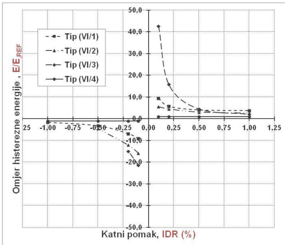
Slika 6.52. Histerezna energija numeričkih modela grupe VI,  $E$  (kNmm) i omjer energije,  $E/E_{REF}$  u odnosu na energiju praznog okvira pri jednakom katnom pomaku, IDR (%)
