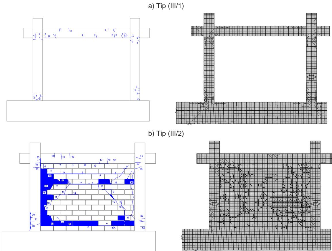
Slika 5.14. Pukotinsko stanje pred slom rezultata fizikalnih (lijevo) i numeričkih modela (desno):
