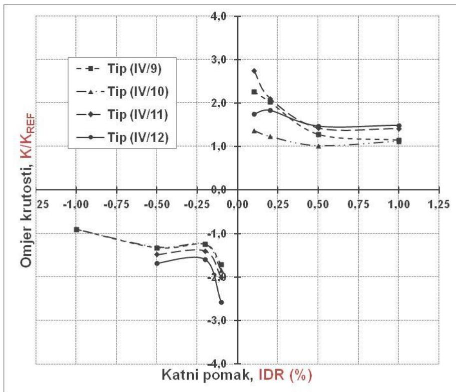
Slika 6.46. Krutost numeričkih modela grupe IV,  $K$  (kN/mm) i omjer nosivosti,  $K/K_{REF}$  u odnosu na nosivost praznog okvira pri jednakom katnom pomaku, IDR (%)
