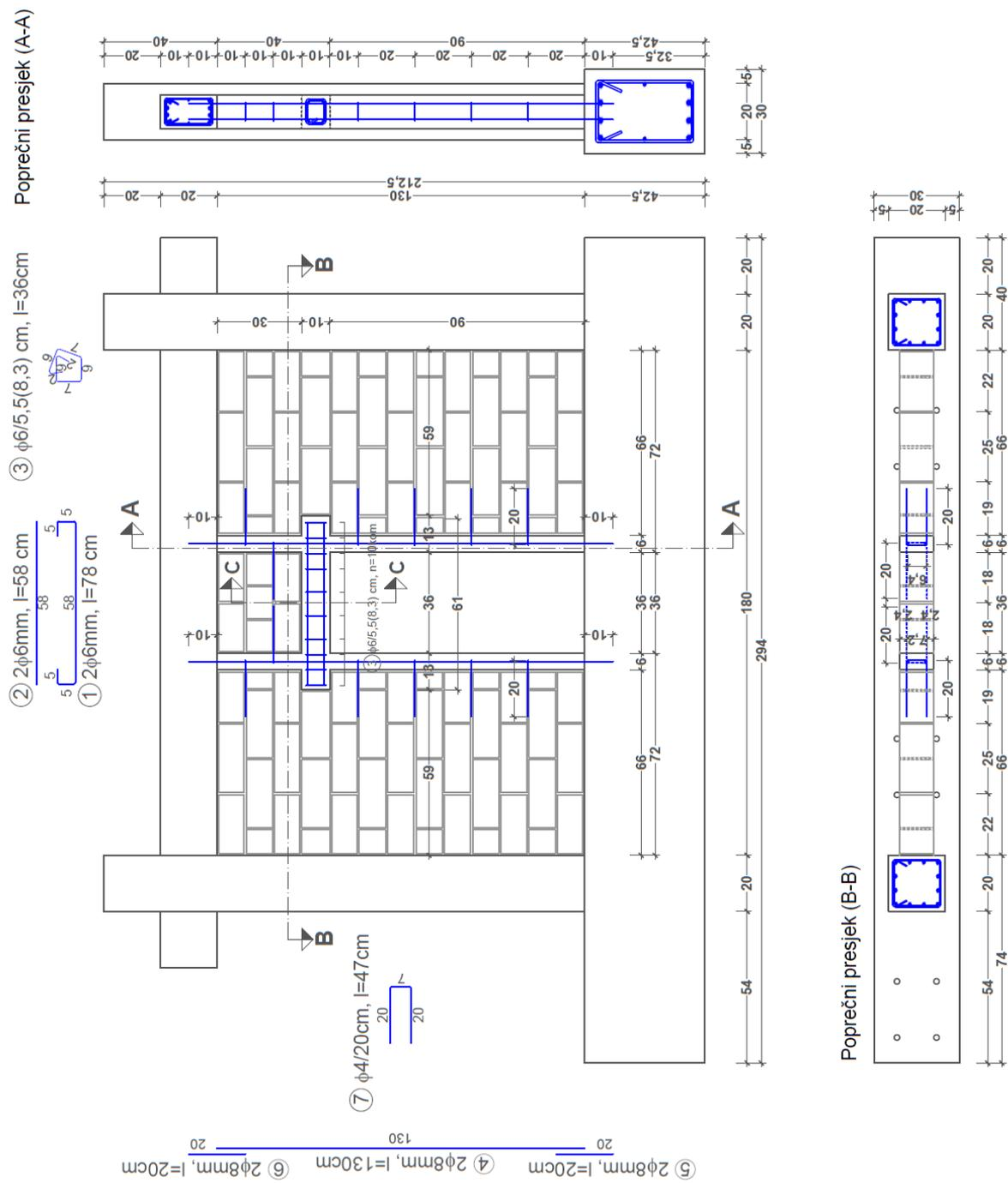
Slika 2.9. Izmjere i plan armature uzorka tip (II/1) u cm
