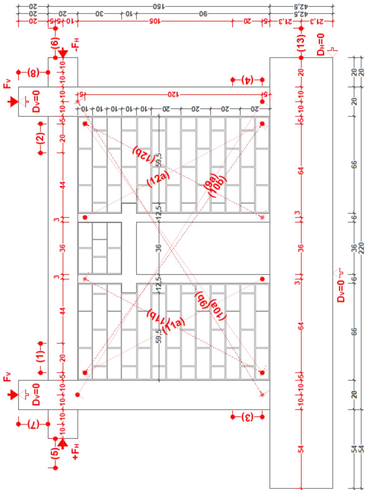
Slika 2.32. Raspored mjernih uređaja i rubni uvjeti za uzorak tip (II/1)
