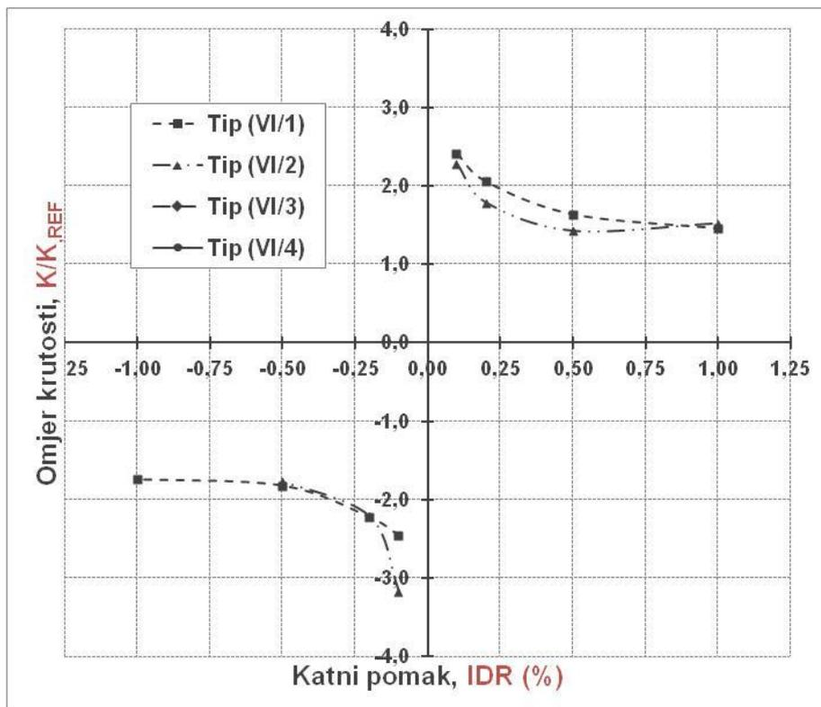
Slika 6.48. Krutost numeričkih modela grupe VI,  $K$  (kN/mm) i omjer nosivosti,  $K/K_{REF}$  u odnosu na nosivost praznog okvira pri jednakom katnom pomaku, IDR (%)
