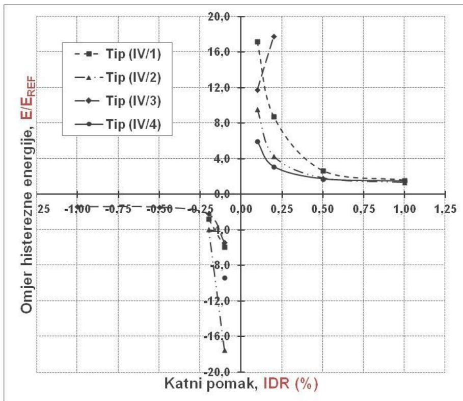
Slika 6.49. Histerezna energija numeričkih modela grupe IV,  $E$  (kNm) i omjer energije,  $E/E_{REF}$  u odnosu na energiju praznog okvira pri jednakom katnom pomaku, IDR (%)
