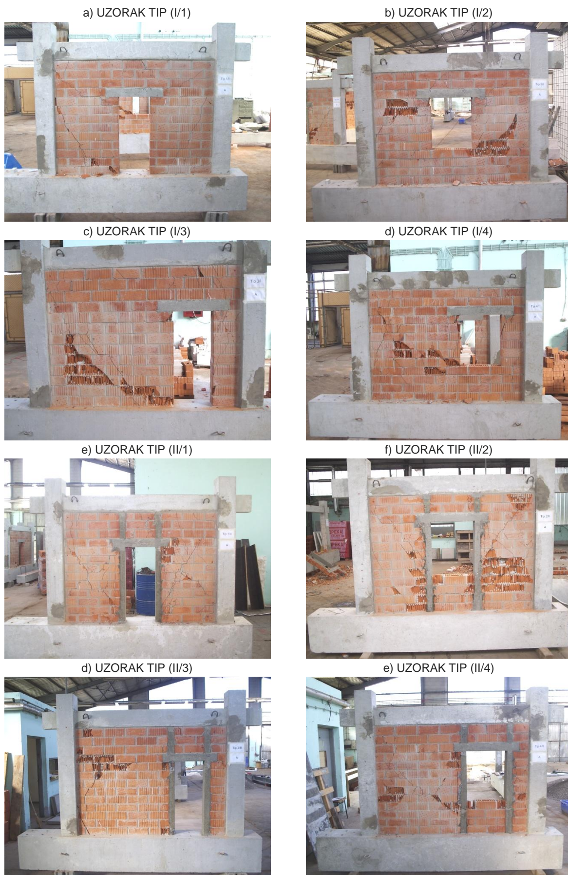
Slika 3.11. Fotografije uzoraka grupa I i II nakon sloma zidanog ispuna
