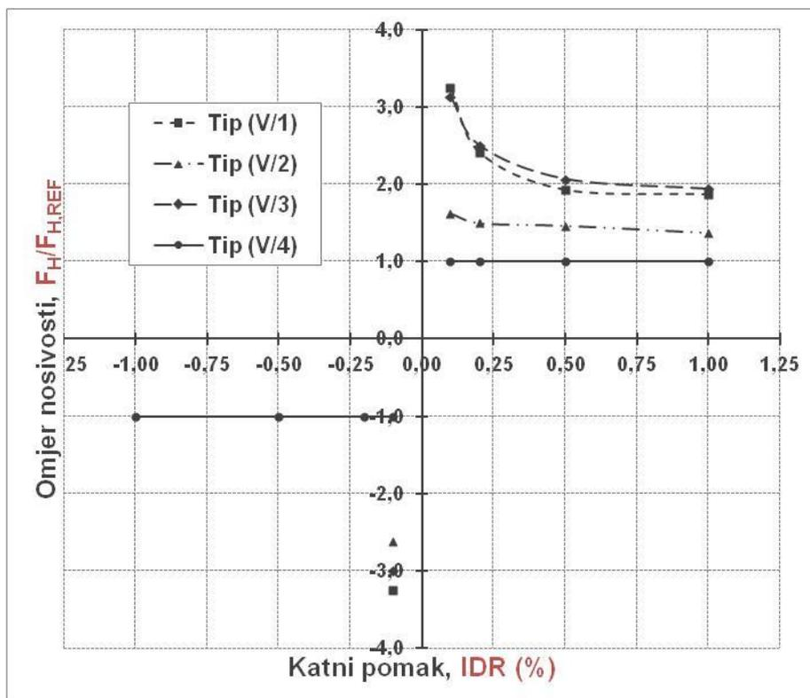
Slika 6.43. Nosivost numeričkih modela grupe VI,  $F_H$  (kN) i omjer nosivosti,  $F_H/F_{H,REF}$  u odnosu na nosivost praznog okvira pri jednakom katnom pomaku, IDR (%)
