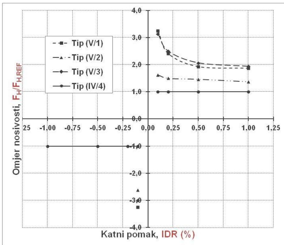
Slika 6.42. Nosivost numeričkih modela grupe V,  $F_H$  (kN) i omjer nosivosti,  $F_H/F_{H,REF}$  u odnosu na nosivost praznog okvira pri jednakom katnom pomaku, IDR (%)
