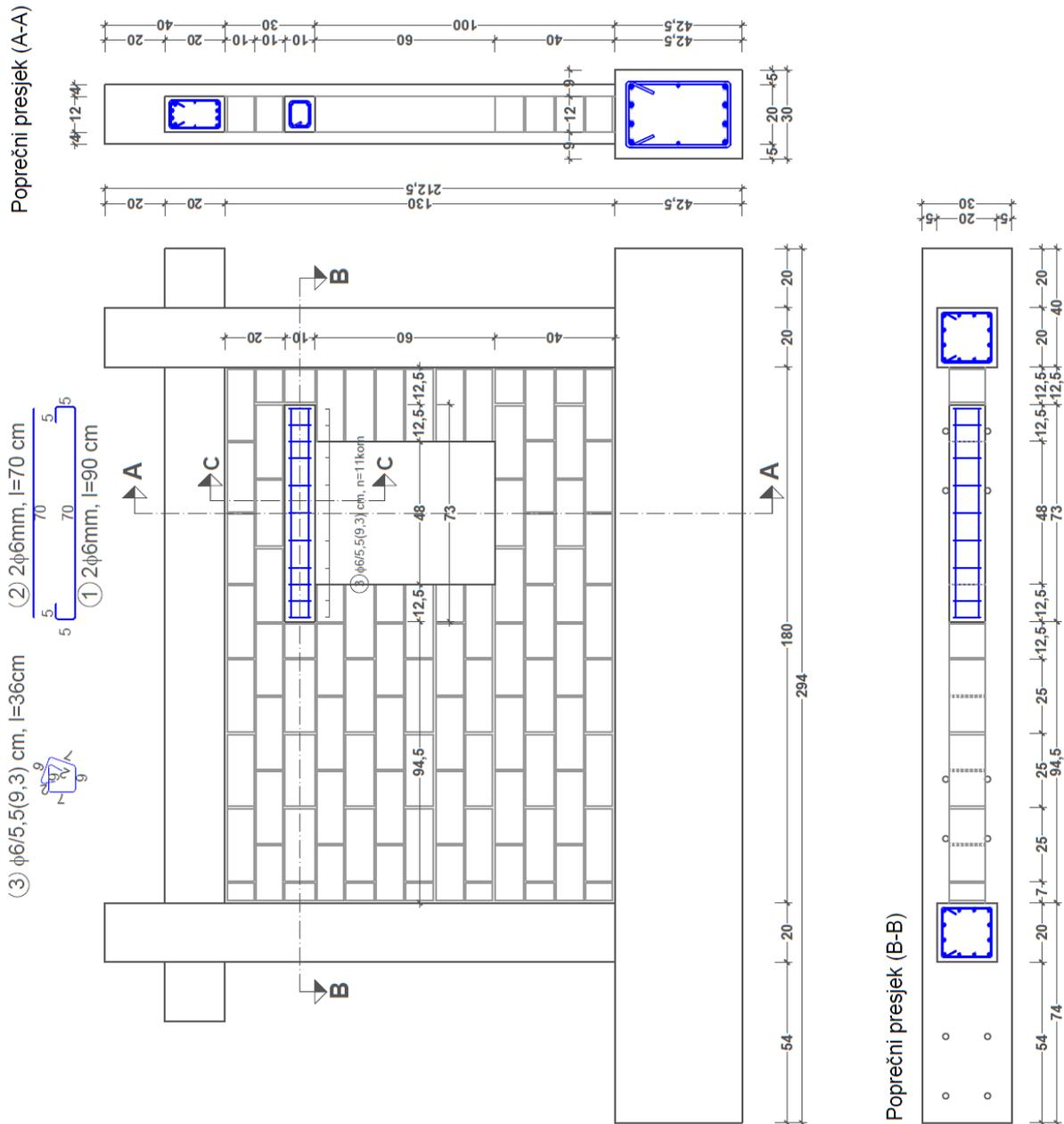
Slika 2.8. Izmjere i plan armature uzorka tip (I/4) u cm
