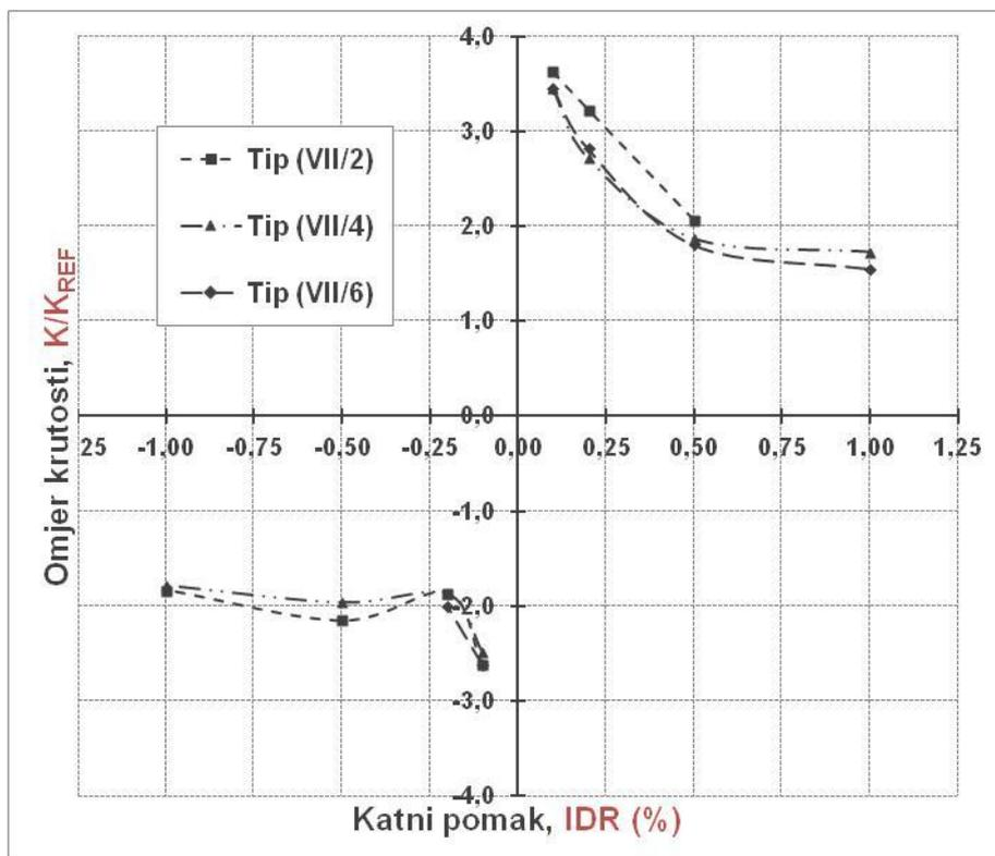
Slika 7.5. Krutost numeričkih modela grupe VII,  $K$  (kN/mm) i omjer nosivosti,  $K/K_{REF}$  u odnosu na nosivost praznog okvira pri jednakom katnom pomaku, IDR (%)
