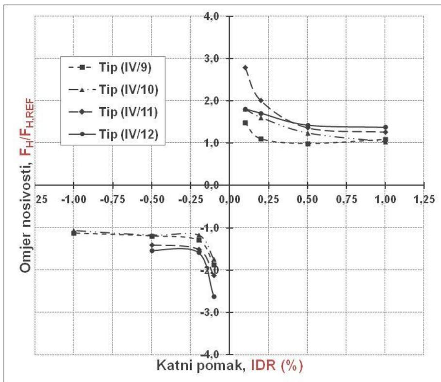
Slika 6.41. Nosivost numeričkih modela grupe IV,  $F_H$  (kN) i omjer nosivosti,  $F_H/F_{H,REF}$  u odnosu na nosivost praznog okvira pri jednakom katnom pomaku, IDR (%)
