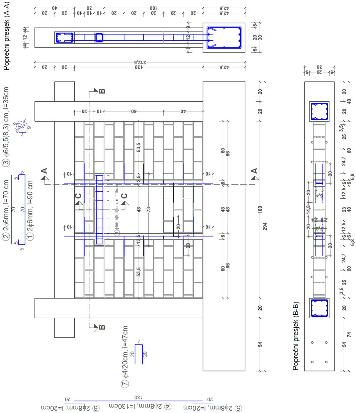
Slika 2.10. Izmjere i plan armature uzorka tip (II/2) u cm
