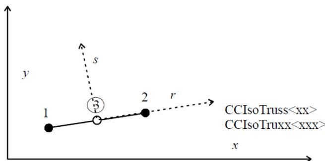
Slika 5.8. CCISOTruss konačni element u ATENA-i 2D v.4.3.
