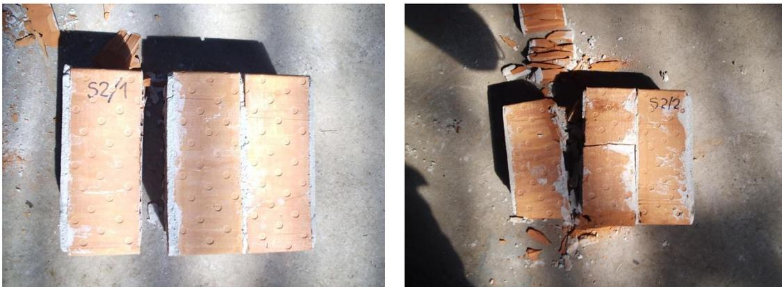
Slika 2.20. Pravilan (lijevo) i nepravilan slom (desno) uzorka
