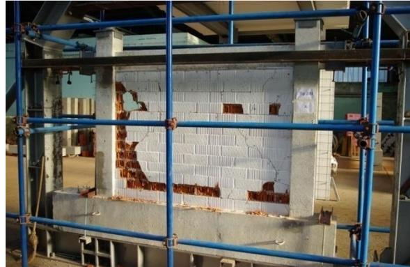
Slika 3.12. Fotografije uzoraka grupe III: a) pri pripremi ispitivanja i b) nakon sloma zidanog ispuna
